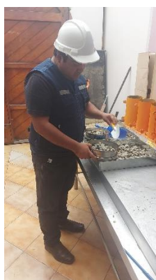
Figura 2. Extracción de materiales pétreos finos y grueso.
