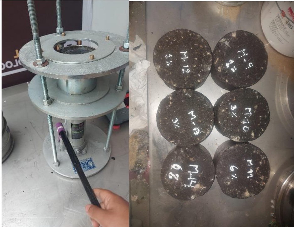
Figura 13. Extracción de testigo (Briqueta patrón) y (experimental)
