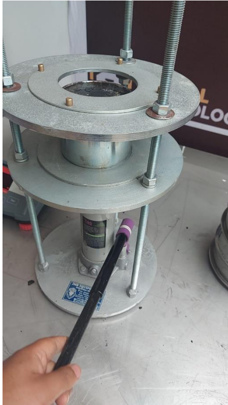
Extracción de briqueta del molde para briquetas patrón - Metodología Marshall
