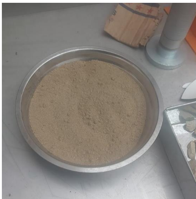
Figura 4. Ensayo de absorción del agregado fino MTC E205.
