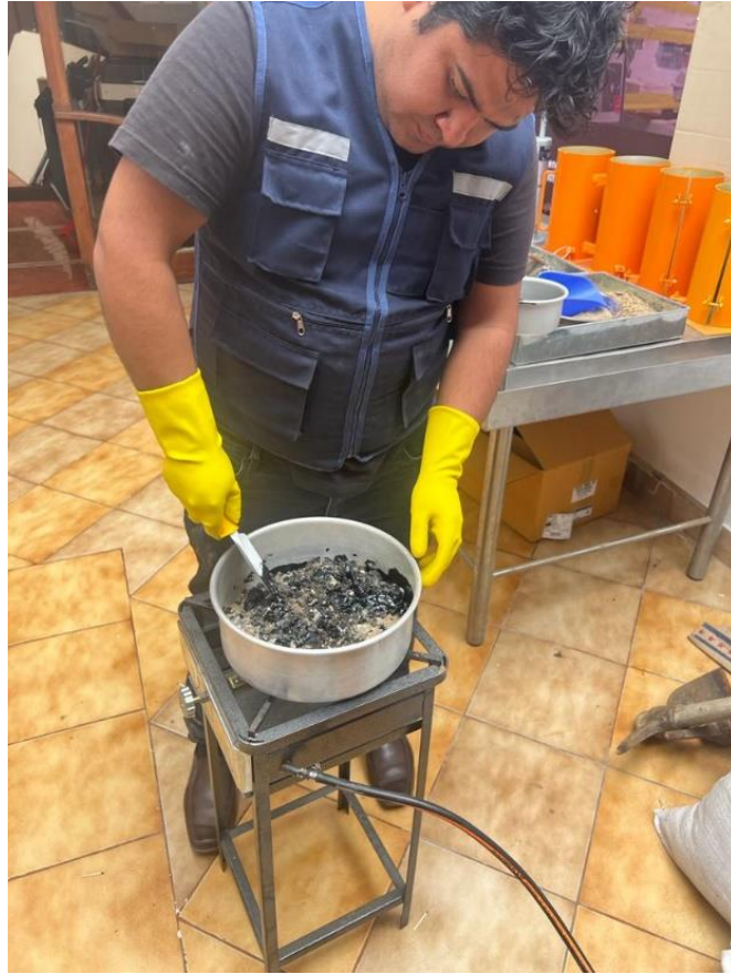
Amasado para briquetas patrón - Metodología Marshall
