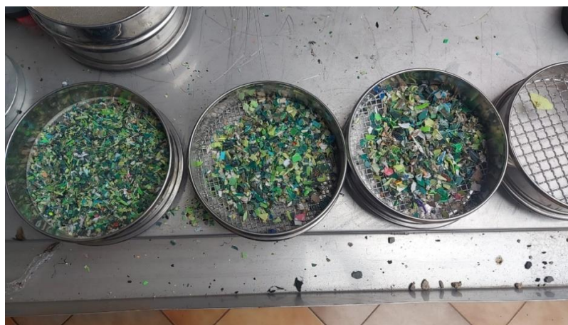
Figura 9. Granulometría del polímero reciclado PET
