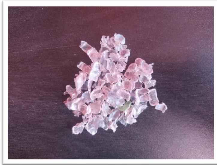
Fotografía 17: Obtención de PET triturado de diámetro menor a 10mm
