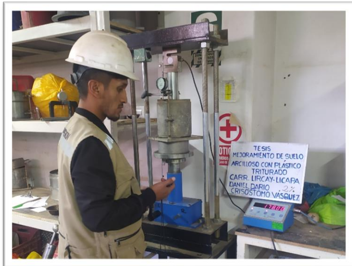
Fotografía 26: Ensayo de Penetración con adición de 2%PTA.
