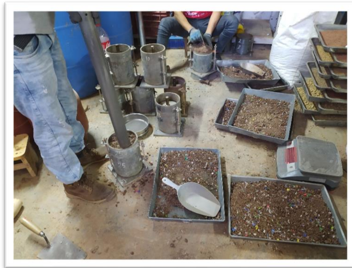
Fotografía 24: Ensayo de CBR con adición de PTA.
