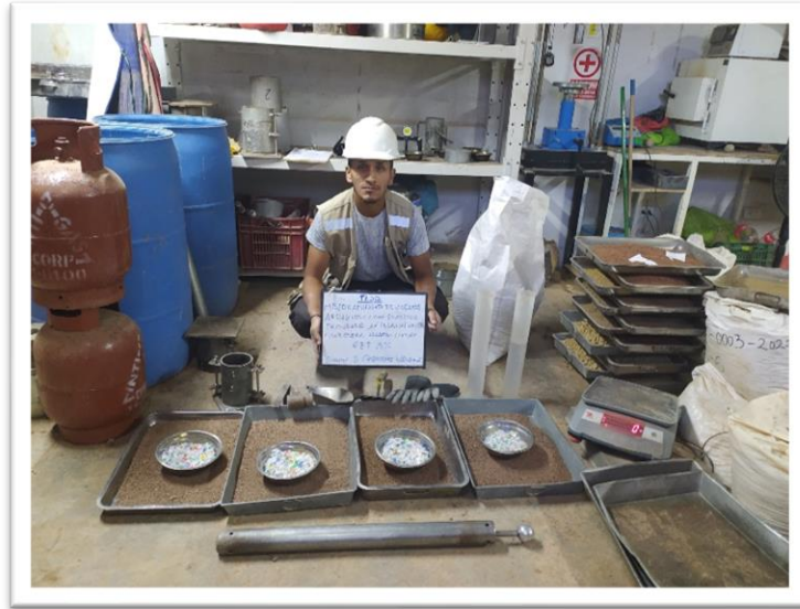
Fotografía 23: Ensayo de Proctor Modificado y adición de 3%PTA.
