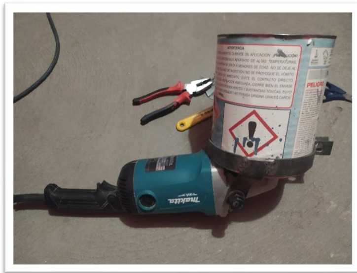
Fotografía 14: Adaptación de maquina amoladora de 2200W
