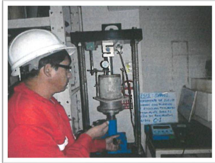
Fotografía 7: Ensayo de Penetración para CBR al Suelo Natural (C-1 y C-2)
