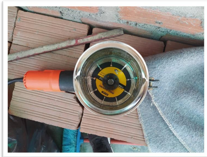
Fotografía 12: Adaptación de maquina amoladora de 820W
