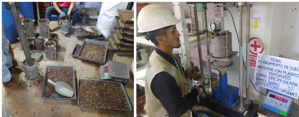
Figura 10 Ensayo en Suelo Natural Adicionando Plástico Triturado Artesanalmente
