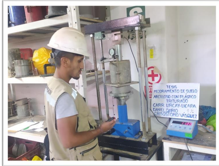
Fotografía 25: Ensayo de Penetración con adición de 1%PTA.
