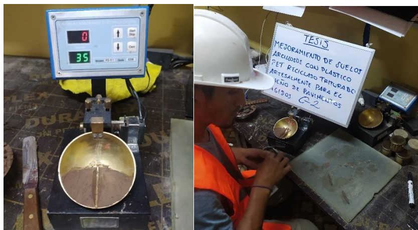
Figura 4 Ensayo de Límite Líquido (cuchara de Casagrande) y Límite plástico.
