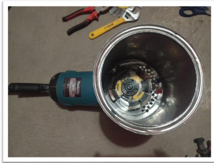
Fotografía 13: Adaptación de maquina amoladora de 2200W
