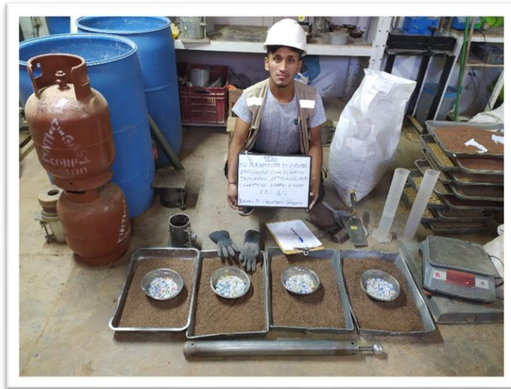
Fotografía 23: Ensayo de Proctor Modificado y adición de 2%PTA.
