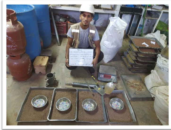
Fotografía 23: Ensayo de Proctor Modificado y adición de 1%PTA.
