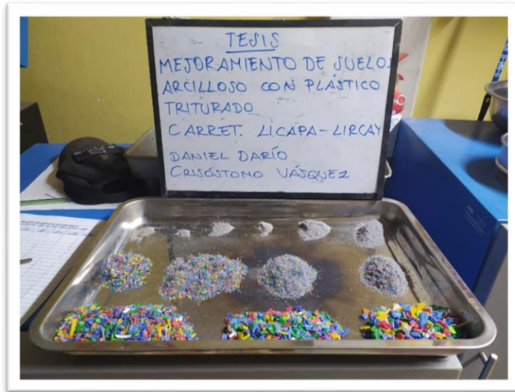
Fotografía 21: Granulometría de HDPE triturado.
