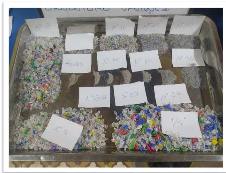
Fotografía 22: Granulometría de Plástico Triturado Artesanalmente (PTA) = PET (2/3PTA) + HDPE (1/3PTA) triturado.
