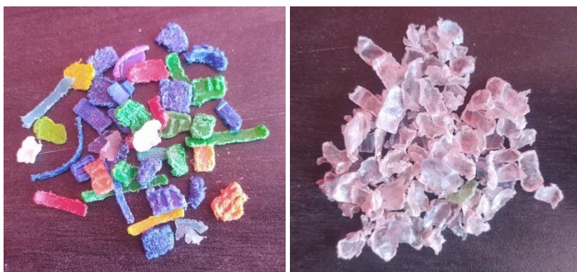
Figura 7 Tapas y Botellas de Plástico Triturado Artesanalmente - Textura Rugosa
