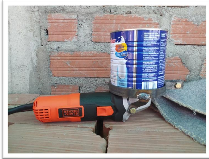
Fotografía 11: Adaptación de maquina amoladora de 820W
