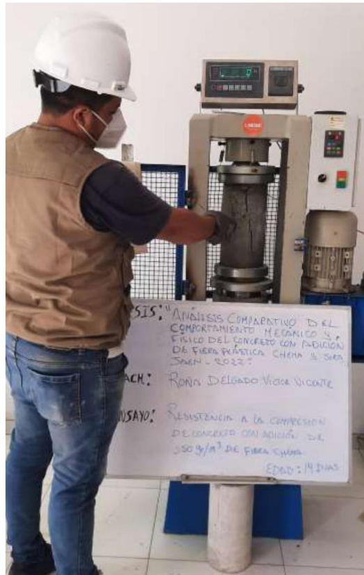
FOTOGRAFIA 14: Ensayo a compresión de testigos de concreto bajo la norma ASTM C39 de la muestra de concreto f'c = 210 \text{ kg/cm}^2 con adición de 350 \text{ gr/m}^3 FPHEMA del proyecto tesis: "Análisis Comparativo Del Comportamiento Mecánico Y Físico Del Concreto Con Adición De Fibra Plástica Chema Y Sika, Jaén - 2022".
