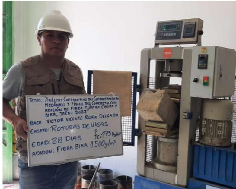
FOTOGRAFIA 28: Ensayo a Resistencia A La Flexión Del Concreto Endurecido ASTM C78 de la muestra de concreto a los 28 días del Proyecto Tesis: "Análisis Comparativo Del Comportamiento Mecánico Y Físico Del Concreto Con Adición De Fibra Plástica Chema Y Sika, Jaén - 2022".
