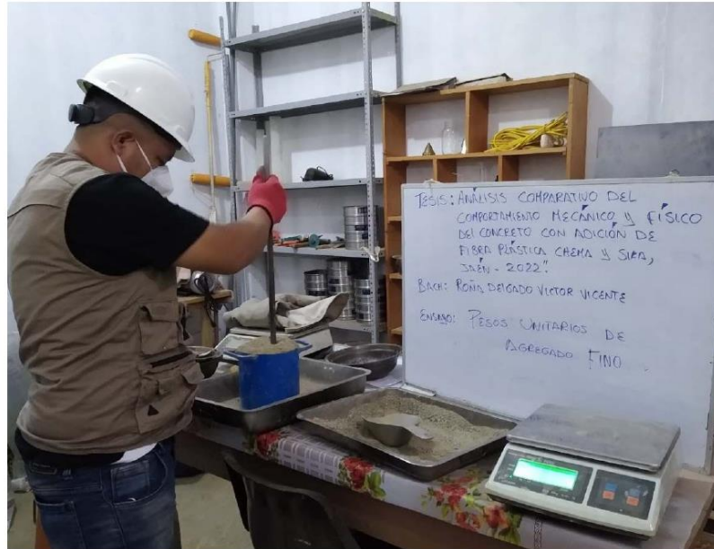
FOTOGRAFÍA 08: Muestra la ejecución del ensayo de pesos unitarios del agregado fino, de la cantera Josecito, para la Tesis: "Análisis Comparativo Del Comportamiento Mecánico Y Físico Del Concreto Con Adición De Fibra Plástica Chema Y Sika, Jaén - 2022".
