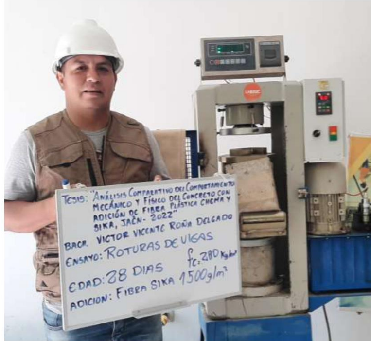
FOTOGRAFIA 30: Ensayo a Resistencia A La Flexión Del Concreto Endurecido ASTM C78 de la muestra de concreto a los 28 días del Proyecto Tesis: "Análisis Comparativo Del Comportamiento Mecánico Y Físico Del Concreto Con Adición De Fibra Plástica Chema Y Sika, Jaén - 2022".
