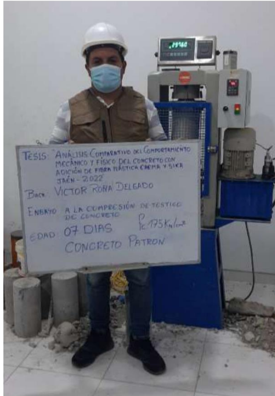
FOTOGRAFIA 01: Ensayo a compresión de testigos de concreto bajo la norma ASTM C39 de la muestra de concreto patrón ( F'c = 175 \text{ kg/cm}^2 ) del proyecto tesis: "Análisis Comparativo Del Comportamiento Mecánico Y Físico Del Concreto Con Adición De Fibra Plástica Chema Y Sika, Jaén - 2022".
