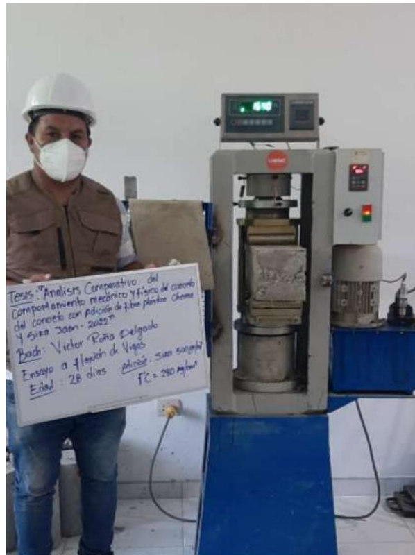
FOTOGRAFIA 27: Ensayo a Resistencia A La Flexión Del Concreto Endurecido ASTM C78 de la muestra de concreto a los 28 días del Proyecto Tesis: "Análisis Comparativo Del Comportamiento Mecánico Y Físico Del Concreto Con Adición De Fibra Plástica Chema Y Sika, Jaén - 2022".
