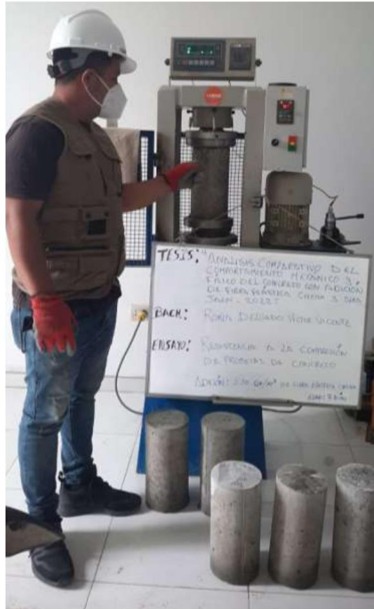
FOTOGRAFIA 10: Ensayo a compresión de testigos de concreto bajo la norma ASTM C39 de la muestra de concreto f'c = 210 \text{ kg/cm}^2 con adición de 350 \text{ gr/m}^3 FPCHEMA del proyecto tesis: "Análisis Comparativo Del Comportamiento Mecánico Y Físico Del Concreto Con Adición De Fibra Plástica Chema Y Sika, Jaén - 2022".
