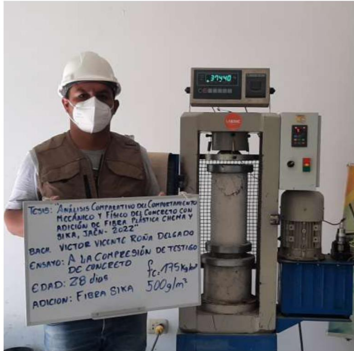
FOTOGRAFIA 17: Ensayo a compresión de testigos de concreto bajo la norma ASTM C39 de la muestra de concreto f'c = 175 \text{ kg/cm}^2 con adición de 500 \text{ gr/m}^3 FPSIKA del proyecto tesis: "Análisis Comparativo Del Comportamiento Mecánico Y Físico Del Concreto Con Adición De Fibra Plástica Chema Y Sika, Jaén - 2022".
