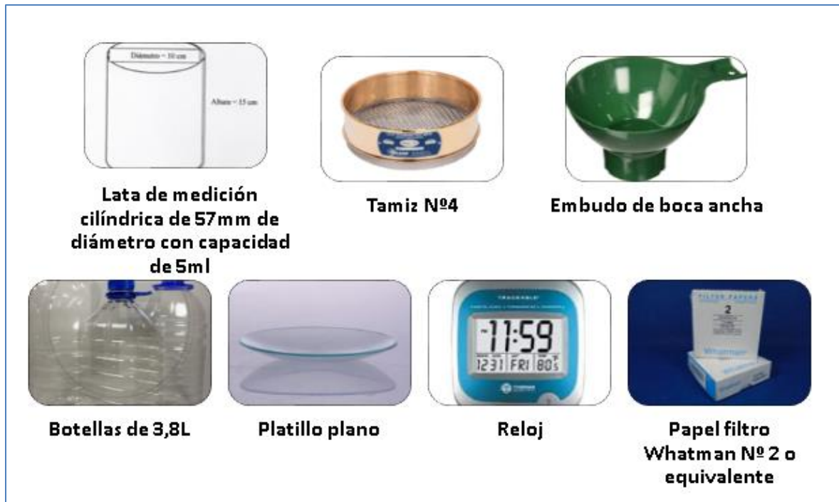
Figura 6 Instrumentos utilizados en el ensayo de Equivalente de arena
