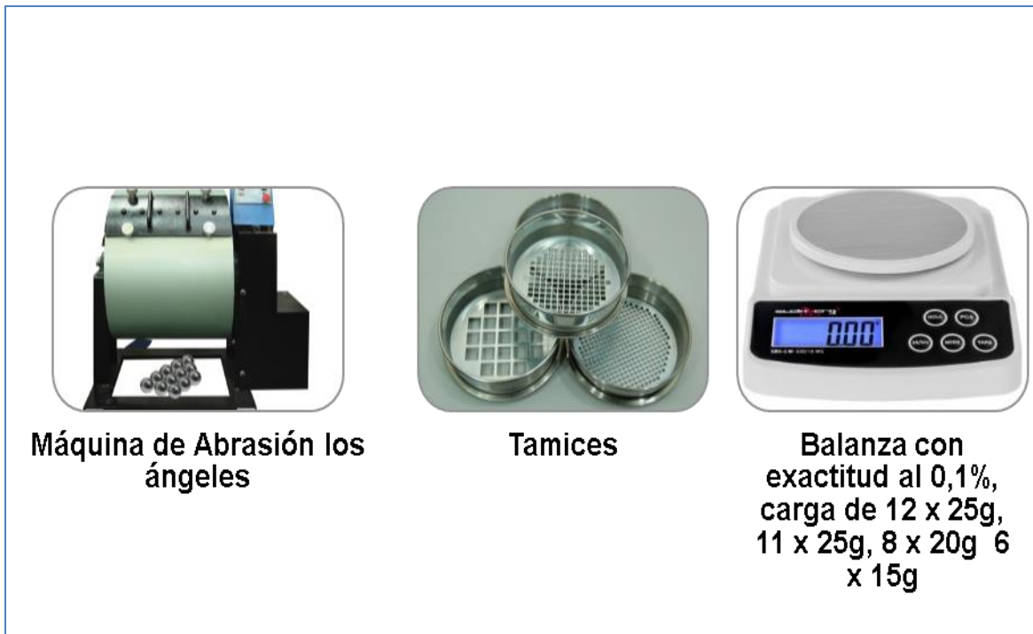
Figura 10 Instrumentos a utilizar en el ensayo de Abrasión los Ángeles
