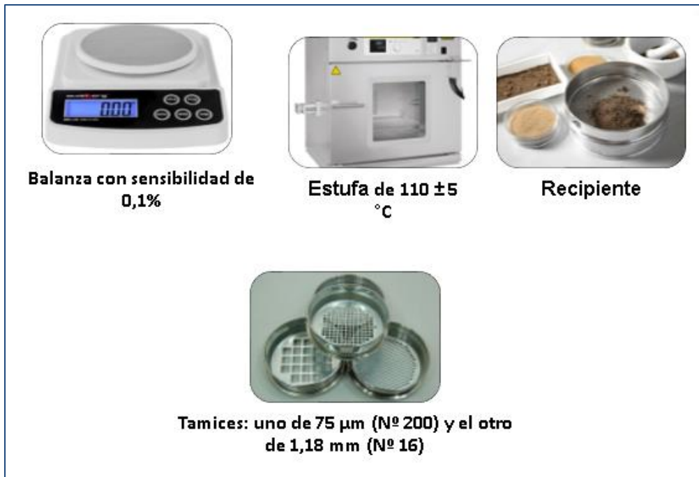
Figura 4 Instrumentos para el ensayo de Material fino que pasa el tamiz (N° 200)
