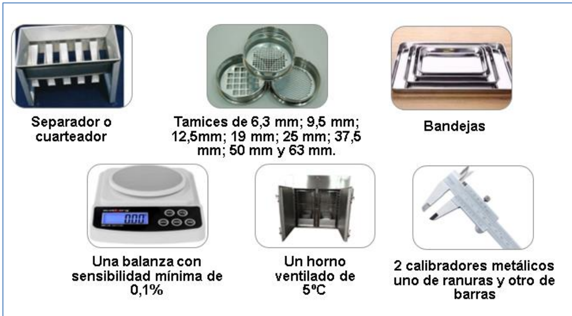
Figura 12 Instrumentos a utilizar en el ensayo de Partículas chatas y alargadas
