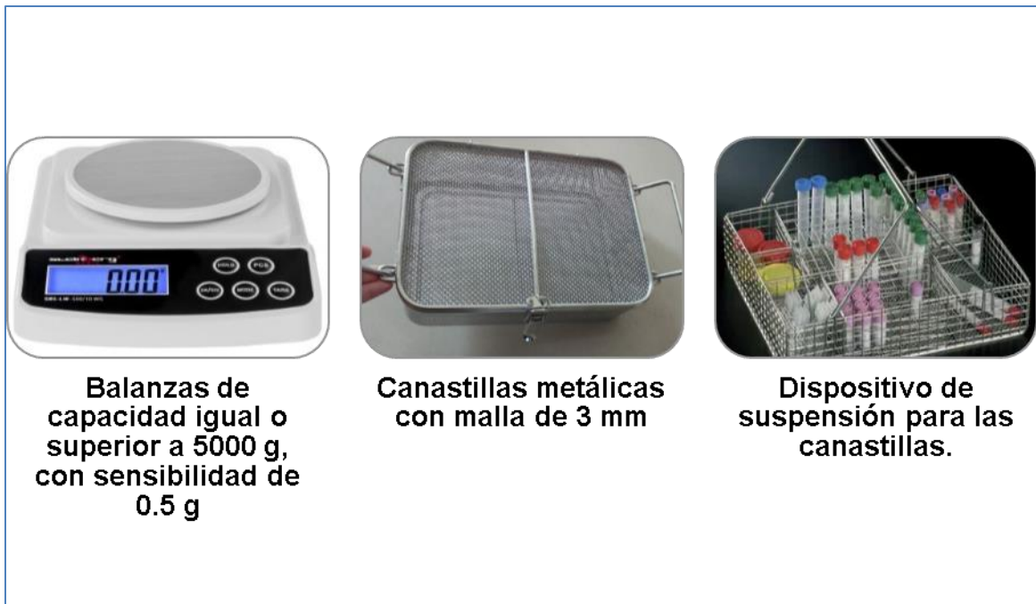
Figura 8 Instrumentos utilizados en el ensayo de Peso específico y absorción de agregados gruesos
