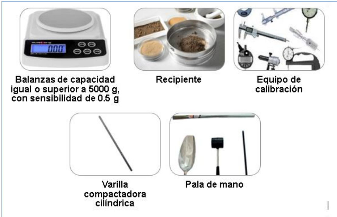
Figura 9 Instrumentos a utilizar en el ensayo de Peso unitario y vacíos de los agregados
