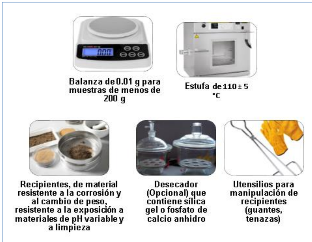
Figura 5 Instrumentos utilizados para el ensayo de contenido de humedad
