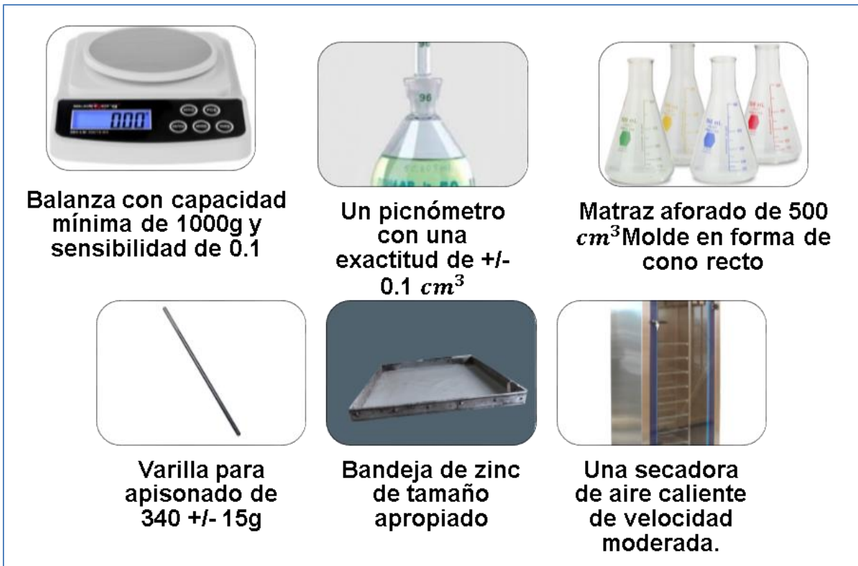
Figura 7 Instrumentos utilizados en el ensayo de Peso específico y absorción de agregados finos
