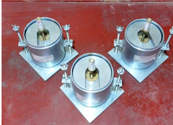
Figura 42. Muestras compactadas a 10, 25 y 56 golpes.
