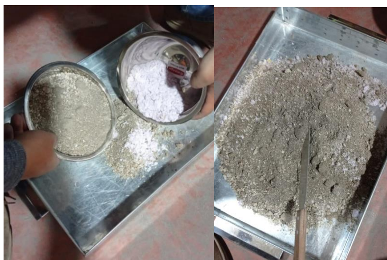
Figura 46. Incorporación de pulitón a muestra.
