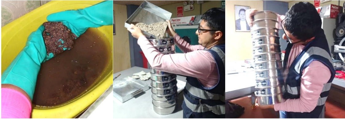
Figura 37. Lavado y tamizado de muestra.
