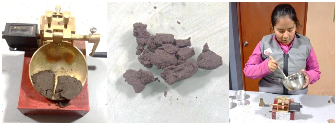
Figura 38. Ensayo límites de Atterberg
