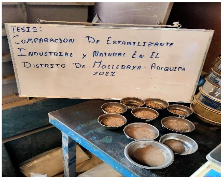
Figura 16: Muestra de suelo tamizado.
