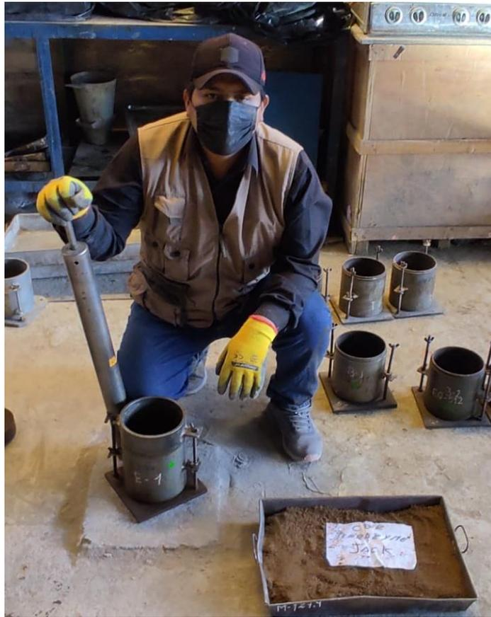
Figura 33: Realizando el ensayo de CBR con las muestras preparadas.
