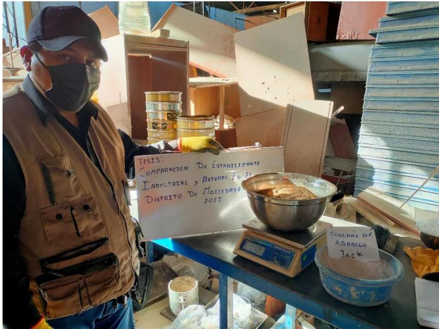
Figura 29: Dosificación del suelo con las conchas de abanico a 5% y 10 %.
