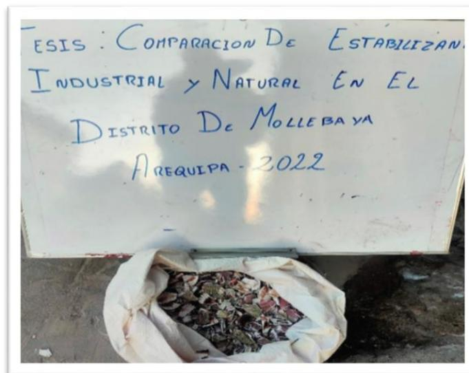
Figura 7: Las conchas de abanico, triturado para ser molido fácilmente.
