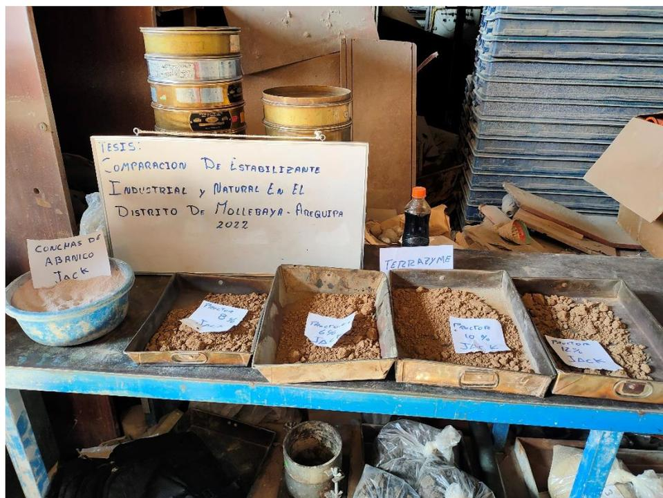
Figura 20: Se realiza el ensayo de proctor modificado para la humeda optima con el uso de los estabilizantes.
