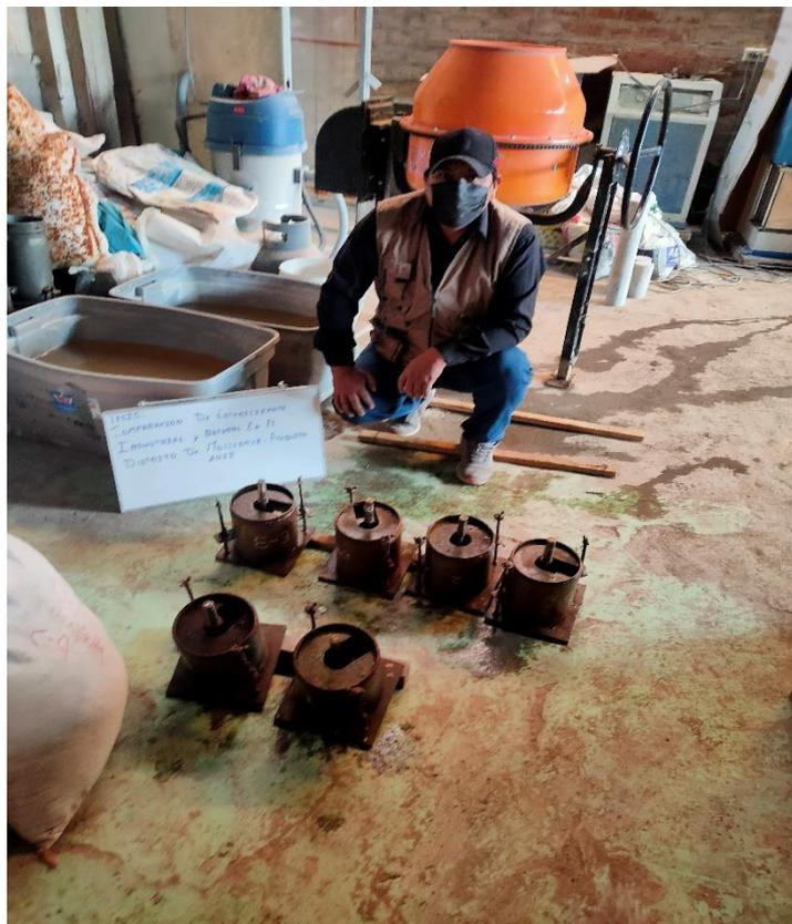
Figura 36: Muestras saturadas después de los 96 horas.
