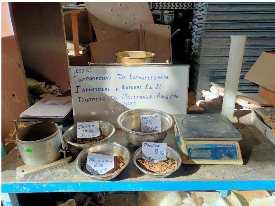
Figura 22: Equipo que se utilizó para el proctor modificado
