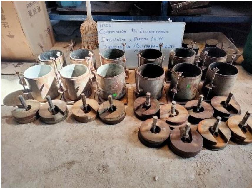
Figura 27: Moldes para realizar el ensayo de CBR, suelo natural, terrazyme, conchas de abanico al 5% y 10% un total de 212 moldes.
