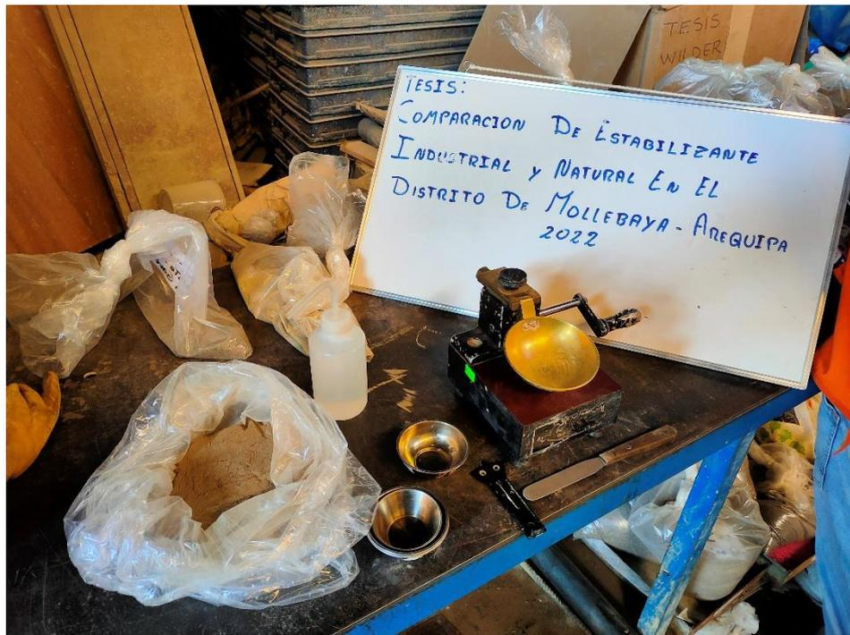
Figura 24: Equipos para elaborar el ensayo de limites
