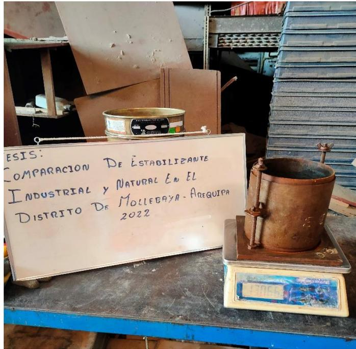
Figura 37: Peso de las muestras saturada-CBR
