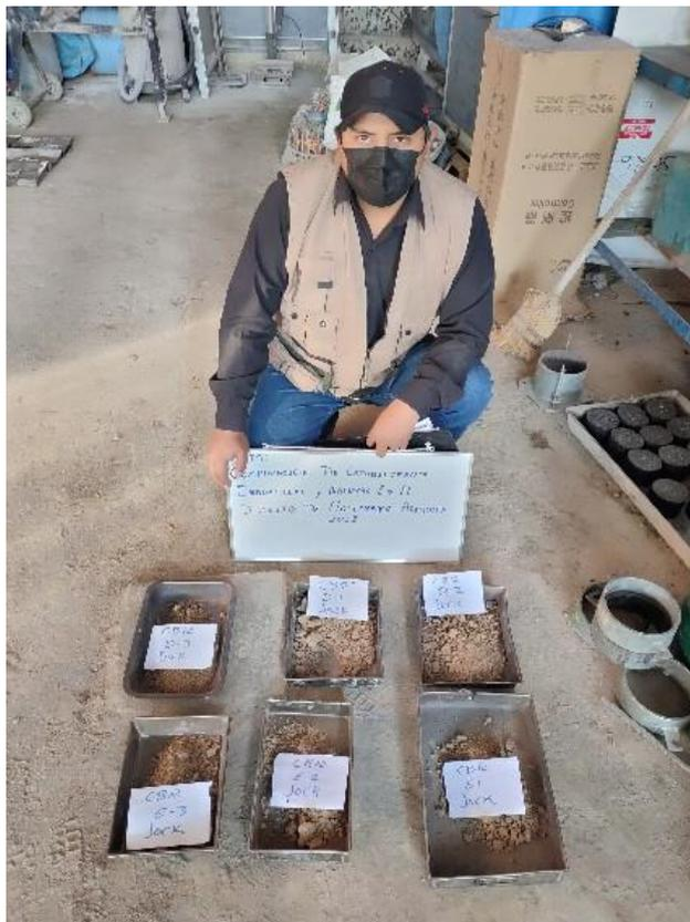
Figura 42: Obtención de muestra para mandar al horno y cuanto saturo.
