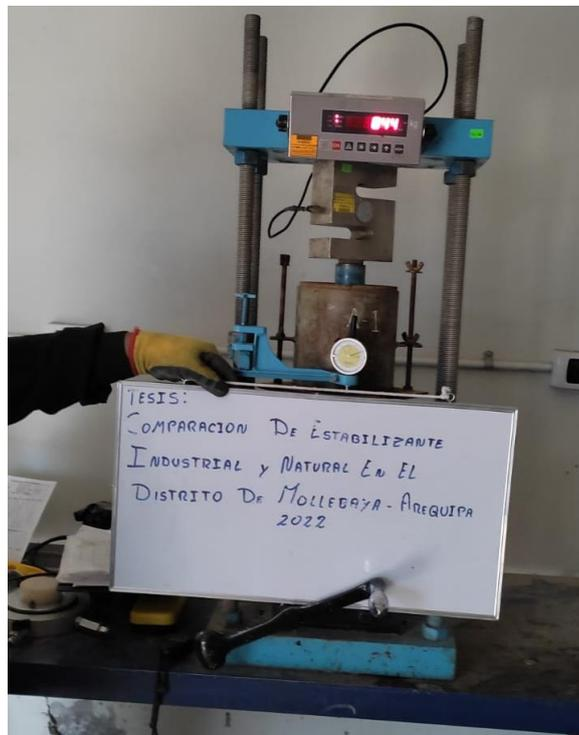
Figura 40: Ensayo del CBR.
