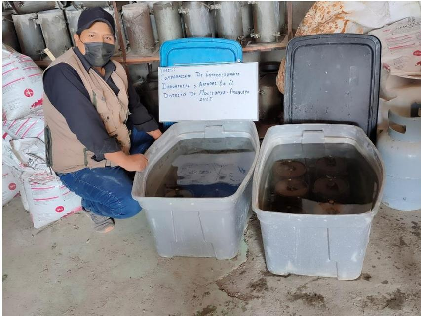
Figura 35: muestras saturadas por 96 horas
