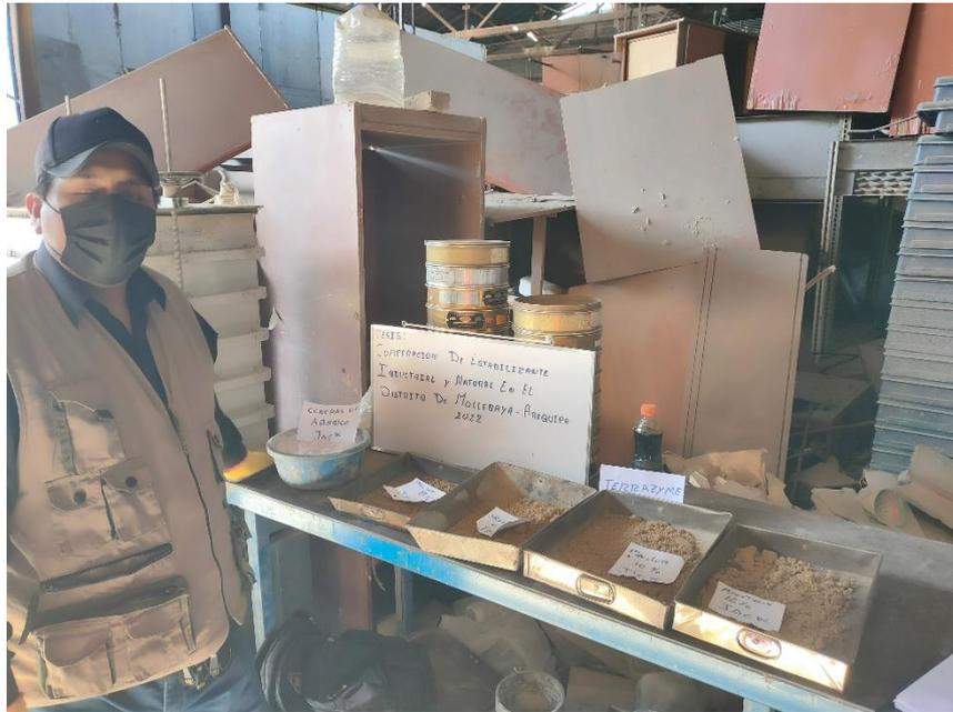
Figura 21: Proctor modificado con la combinación de estabilizantes, conchas de abanico al 5% y 10%
