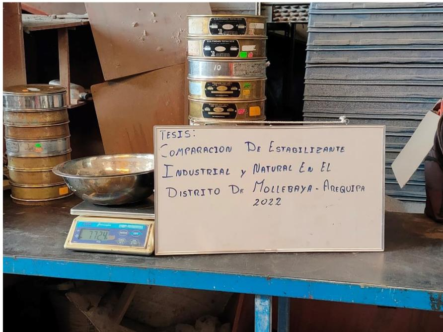
Figura 15: Muestra pesada para tamizar.
