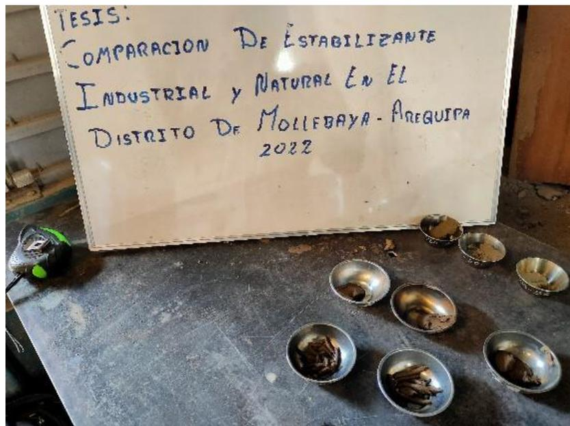
Figura 26: Muestras para el horno de los ensayos de los límites líquidos y plásticos.
