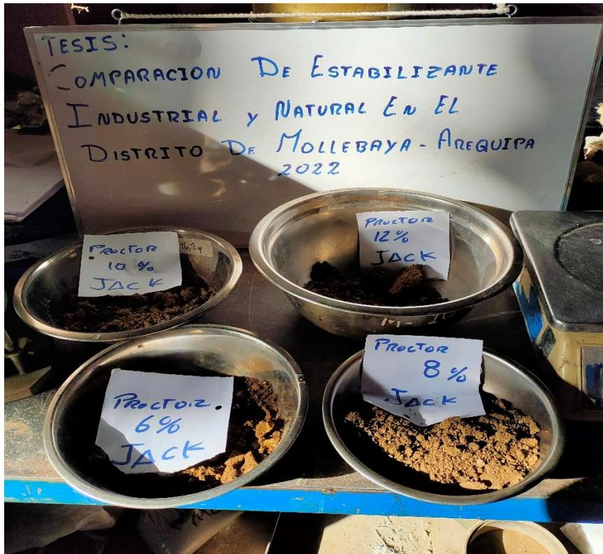
Figura 23; Muestra del material de proctor modificado del suelo natural y terrazyme
