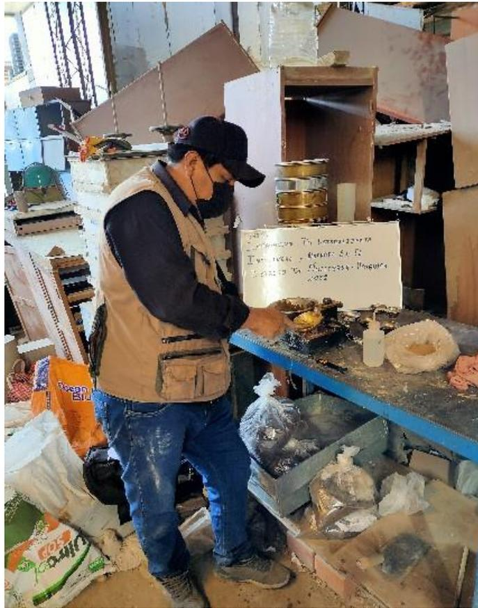
Figura 25: Se realiza el ensayo de límites.
