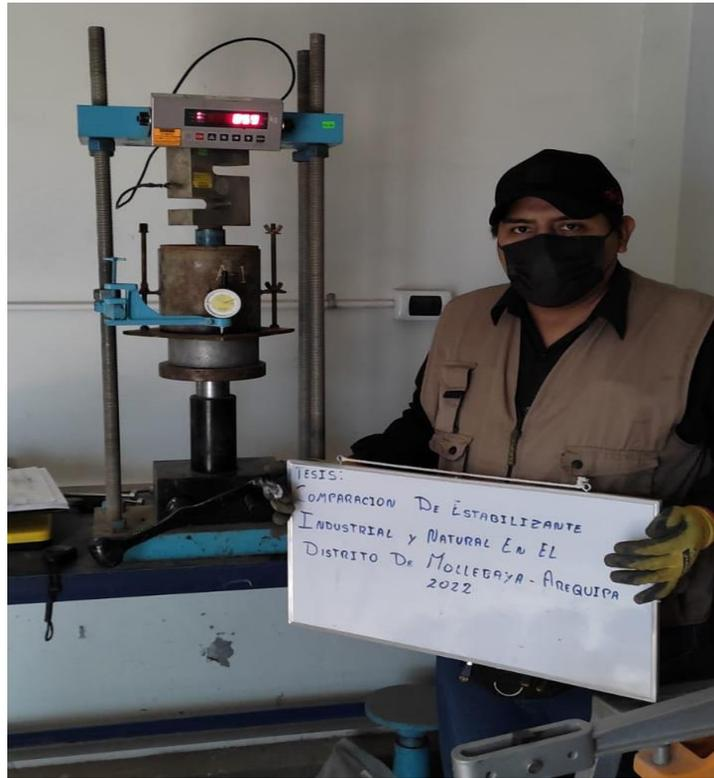
Figura 39: Ensayo del CBR con muestras saturadas.
