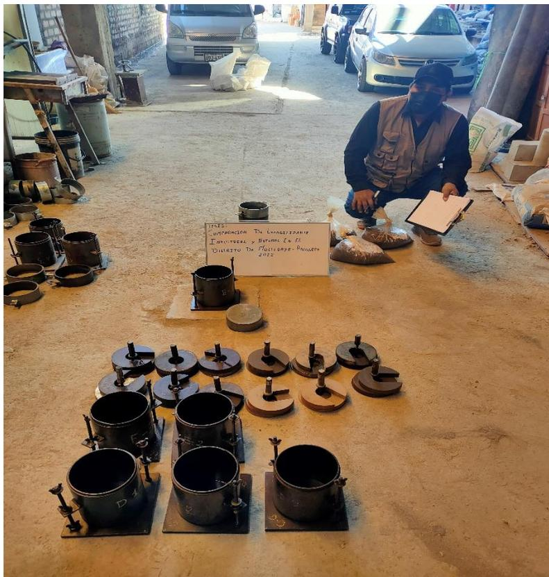
Figura 32: Equipos y moldes para realizar el ensayo de CBR.
