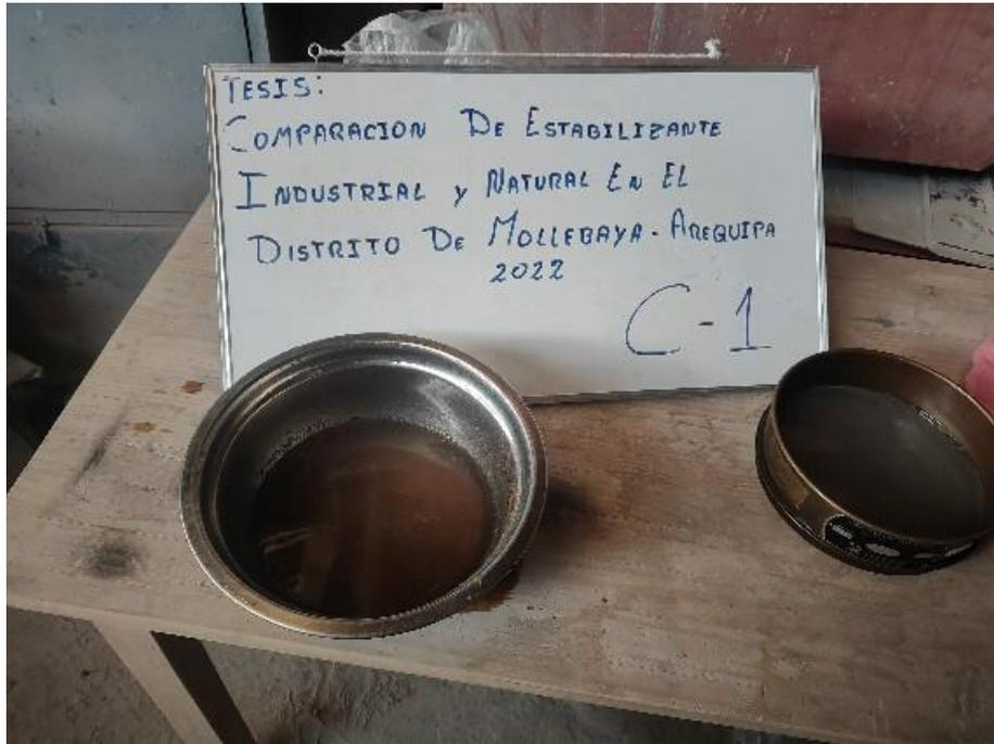
Figura 17: Lavado de material para tamizar – finos
