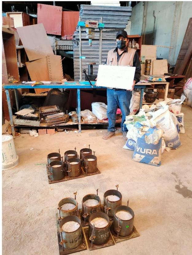
Figura 38: Muestras listas al esfuerzo de compresión – CBR
