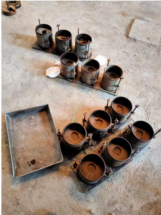
Figura 41: Muestras ya realizadas con el ensayo de penetración CBR.
