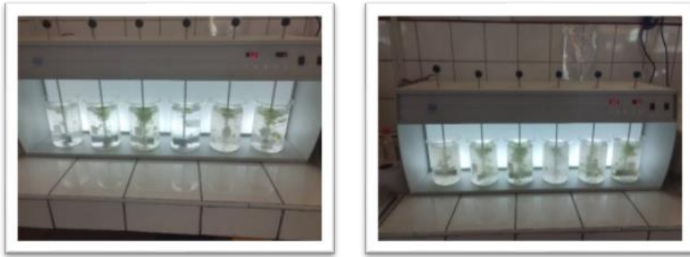
Figura 19. Velocidades de agitación de 50rpm y 100rpm.
