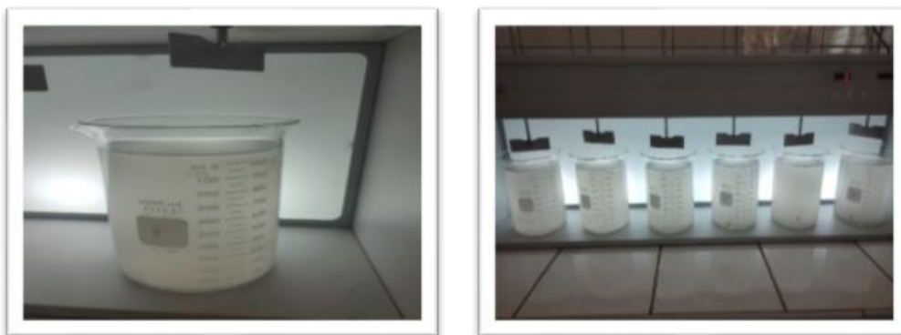
Figura 18. ECA-Inicial y muestras (+10, +25 y +50mg) en jarra de 1000 ml.
