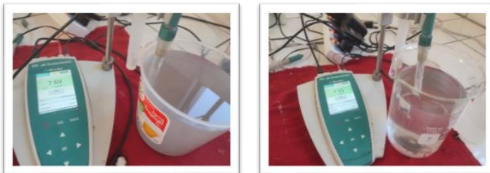
Figura 23. Análisis del pH del agua inicial y posterior.
