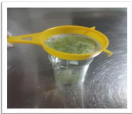
Figura 15. Licuado y colado del mucílago de penca de tuna.
