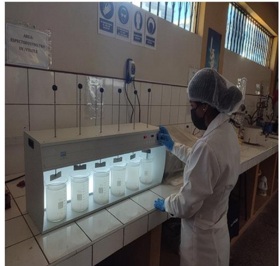
Figura 14. Agitación con 100 rpm
