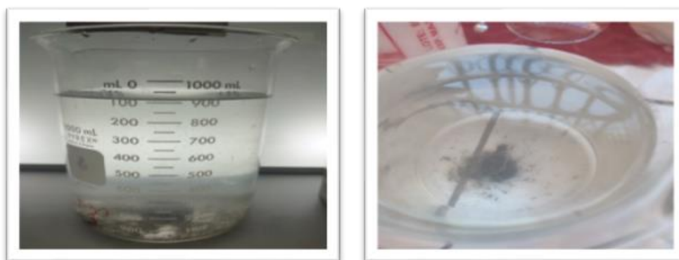
Figura 29. Caracterización de los flóculos con el índice de Willcomb 15 min.
