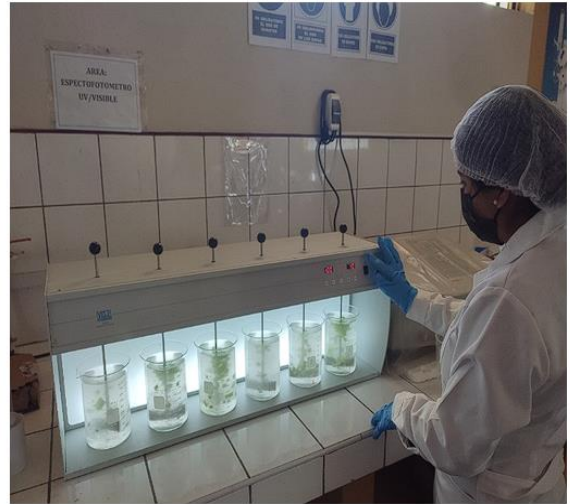
Figura 12. Agitación con 50 rpm
