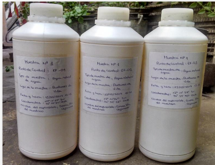
Fotografía N°5: Rotulado de las muestras, según lo que establece la R. J. N°182-2011-ANA.
