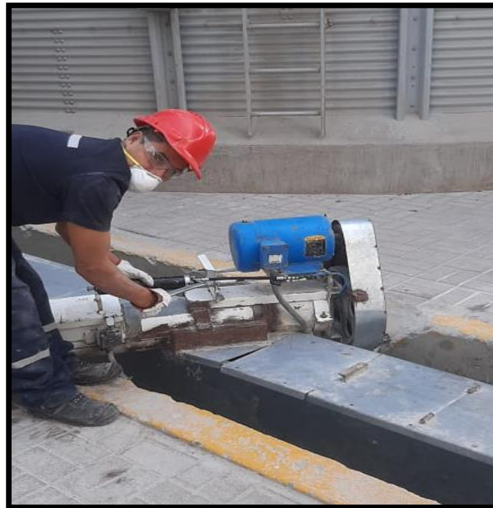
Foto 10. Funcionamiento de extensiones de engrase
