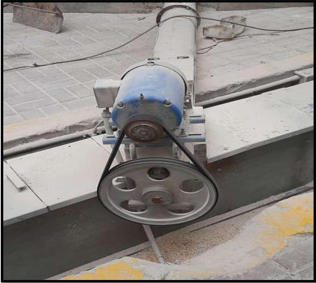
Foto 7. Transportadores helicoidales sin guardas.
