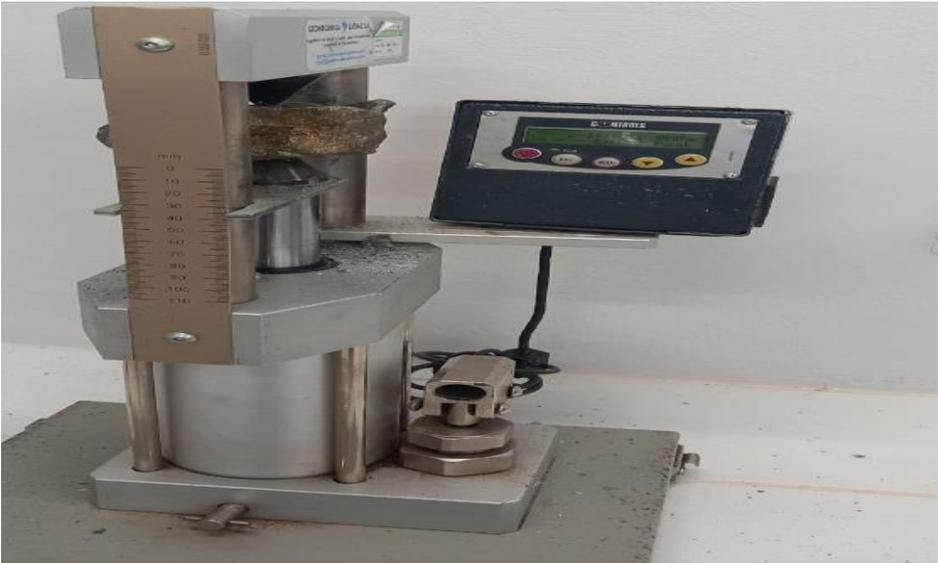
**Figura 13.** Análisis de Puntual Carga Caja Techo
