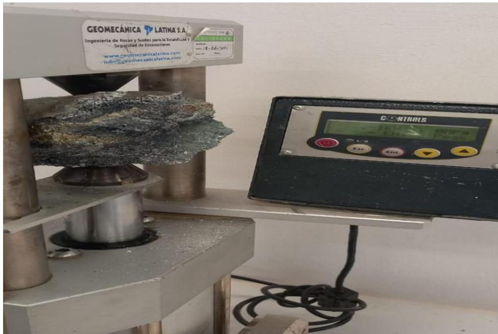
**Figura 18.** Análisis de Carga Puntual del Mineral
