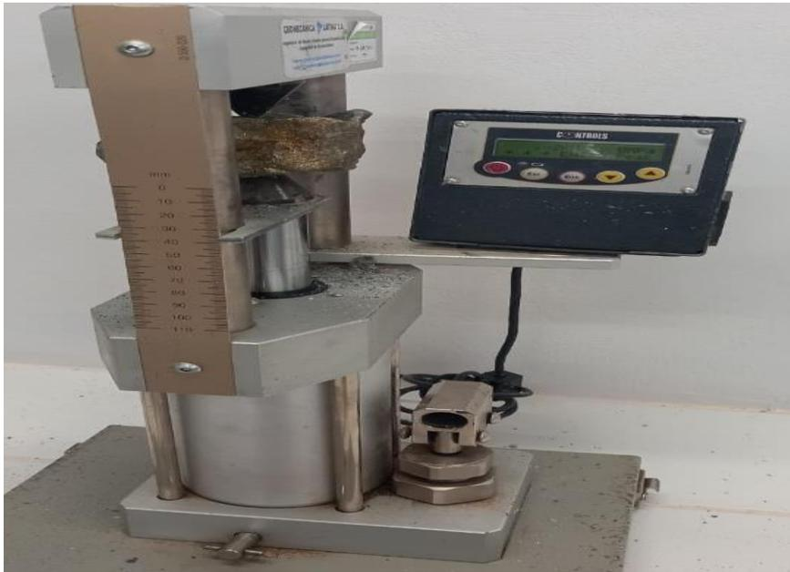
**Figura 15.** Análisis de Cargas Puntuales Caja Piso
