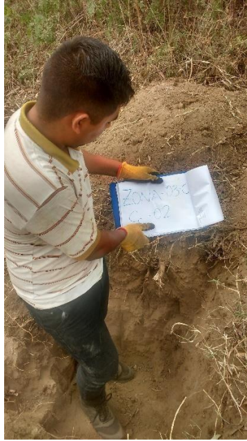
Figura 78: Realización de calicatas para la toma de muestra
