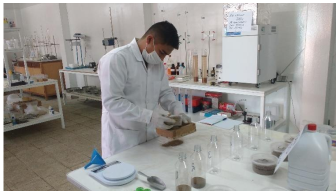
Figura 79: Realización de tamizado para hallar la densidad Aparente del suelo
