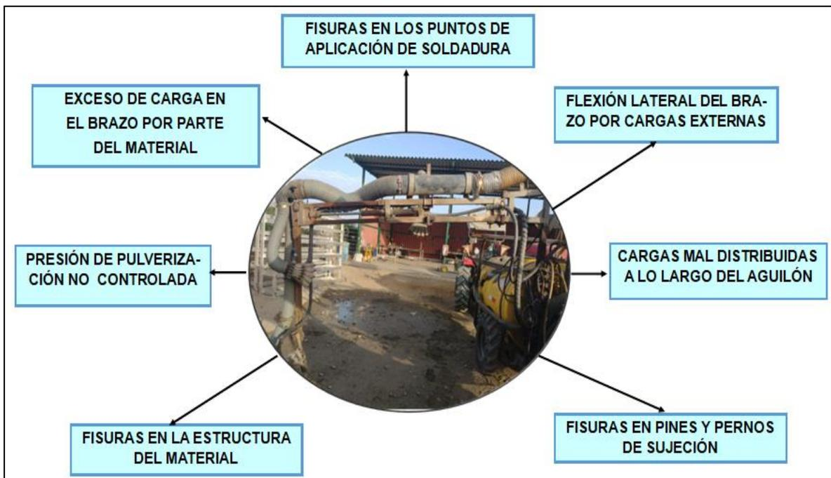
**Figura 10:** Fallas en el aguilón del sistema de aplicación de insumos químicos
