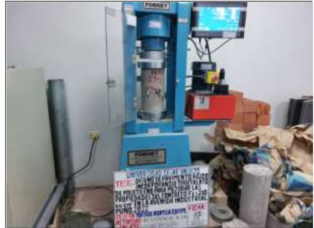
Figura N° 58. Ensayo de resistencia a la compresión de probeta cilíndrica.
