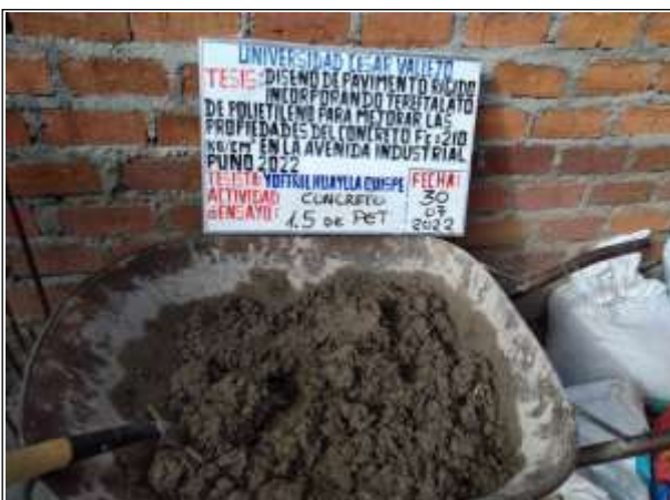
Figura N° 41. Preparación del concreto con 1.5% de PET.
