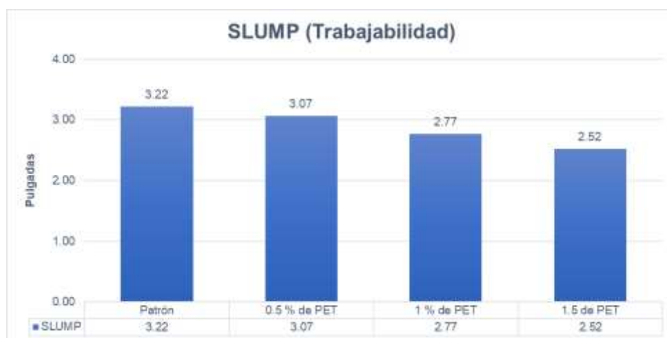
Figura 25. Resultados de la prueba de trabajabilidad del concreto
