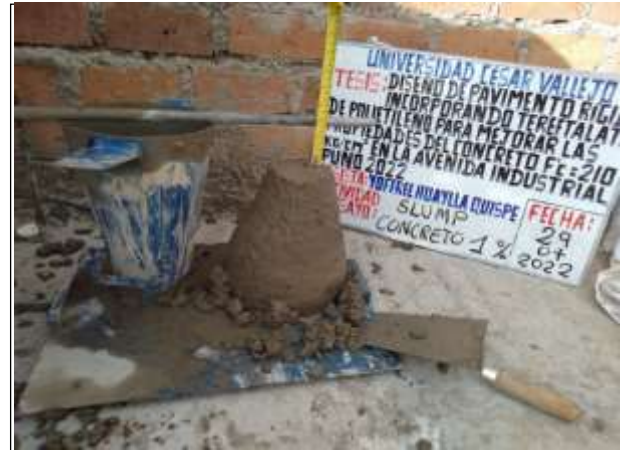
Figura N° 46. Prueba de slump del concreto con 1% de PET.
