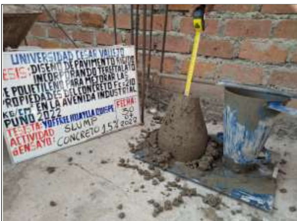
Figura N° 47. Prueba de slump del concreto con 1.5% de PET.
