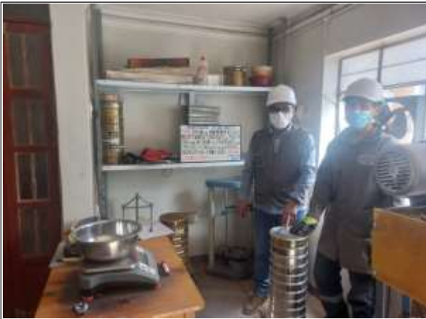
Figura N° 13. Ensayo de granulometría.
