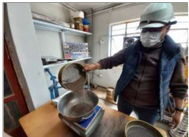
Figura N° 36. Granulometría del agregado fino.
