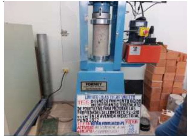
Figura N° 52. Ensayo de resistencia a la compresión de probeta cilíndrica.
