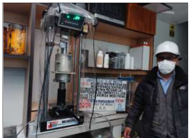
Figura N° 24. Ensayo C.B.R. en la máquina.
