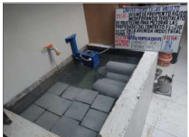
Figura N° 48. Poza de curación de las probetas de concreto.
