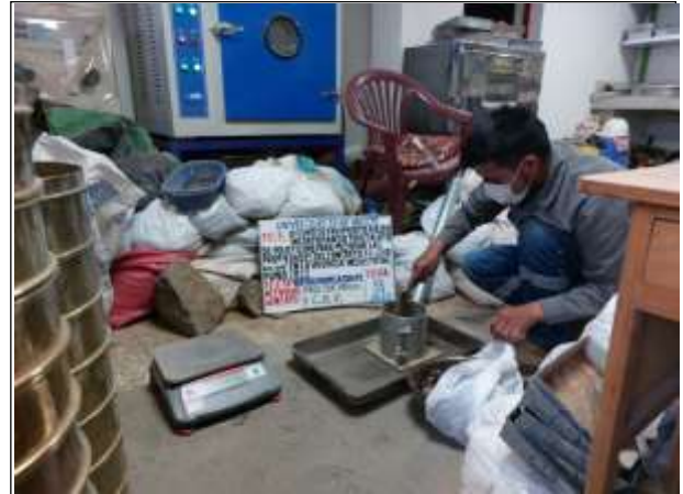
Figura N° 20. Ensayo de proctor modificado, llenado de molde.
