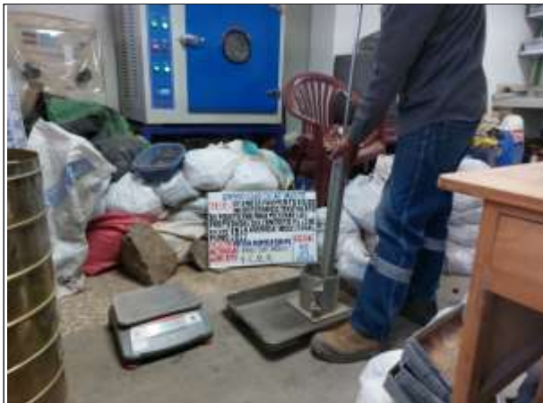
Figura N° 21. Ensayo proctor modificado, efectuando los golpes.
