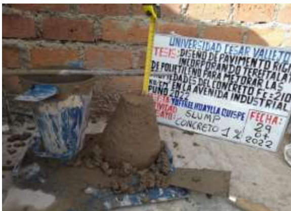
Figura 23. Prueba de slump.
