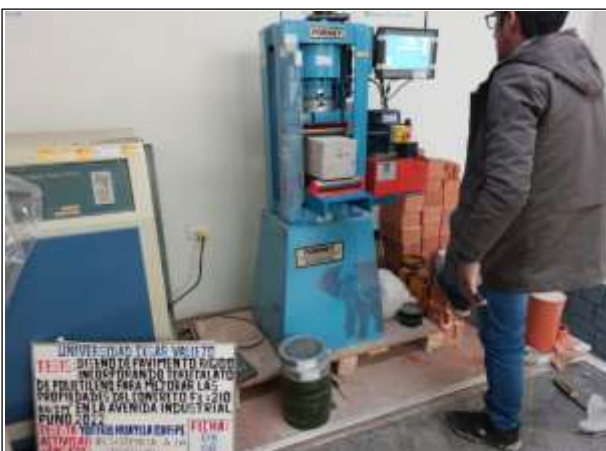
Figura N° 53. Ensayo de resistencia a la flexión de probeta prismática.
