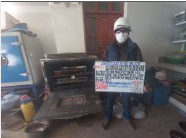
Figura N° 33. Contenido de humedad de los agregados.
