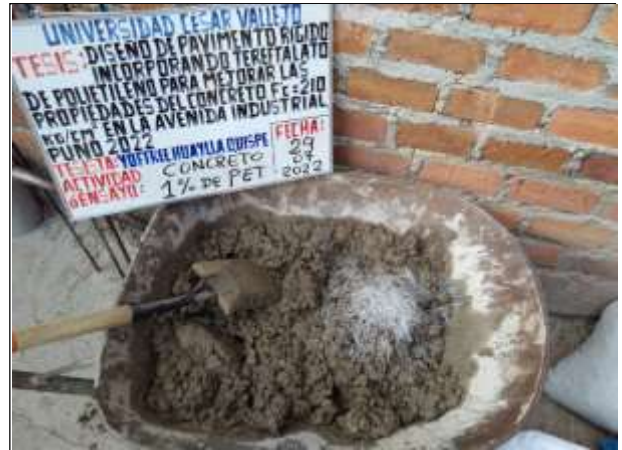
Figura N° 40. Preparación del concreto con 1% de PET.
