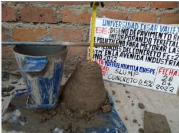
Figura N° 45. Prueba de slump del concreto con 0.5% de PET.
