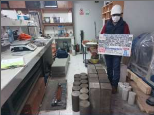
Figura N° 61. Rotura de probetas de concreto a los 28 días de curado.
