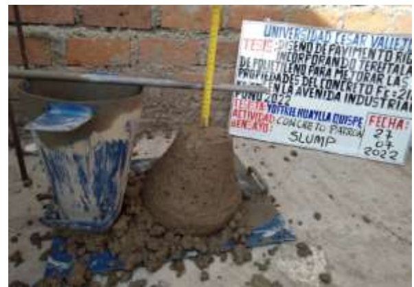
Figura 24. Prueba de slump.
