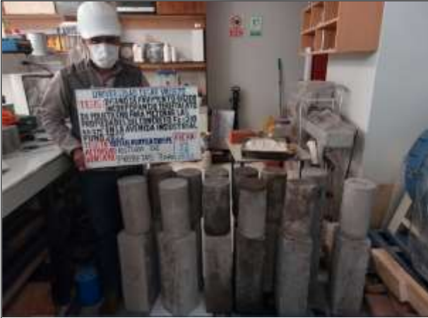
Figura N° 49. Rotura de probetas de concreto a los 7 días de curado.
