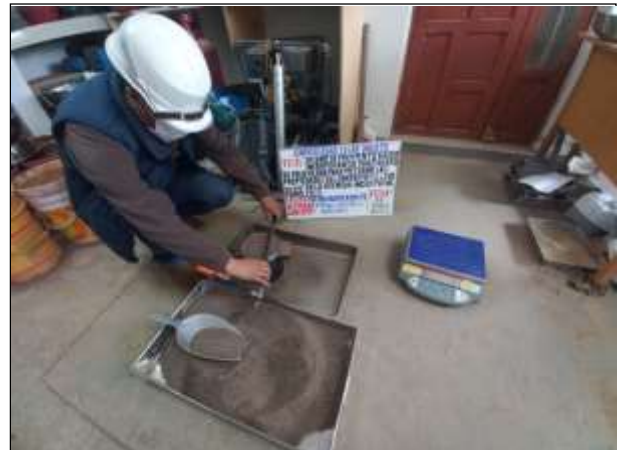
Figura N° 34. Ensayo de peso unitario de agregados.
