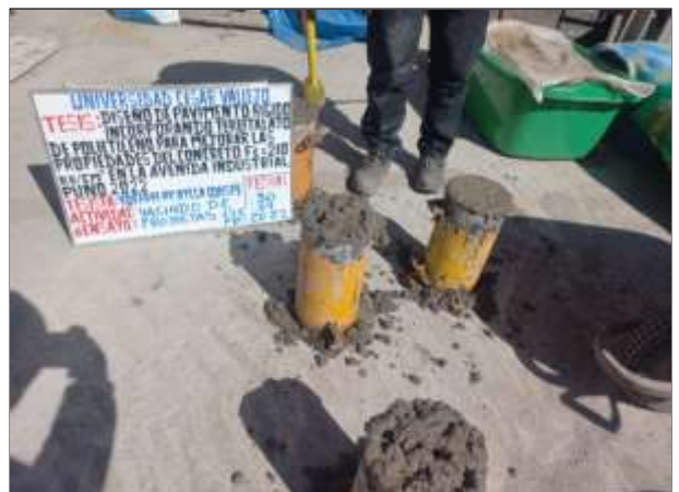
Figura N° 42. Vaciado de moldes cilíndricos.
