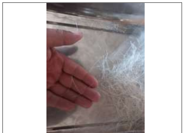
Figura N° 6. Fibra de PET de 2 mm x 40 mm.
