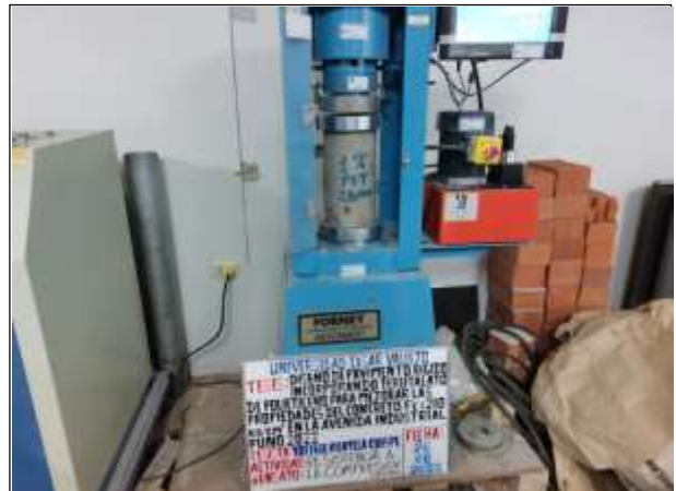
Figura N° 64. Ensayo de resistencia a la compresión de probeta cilíndrica.
