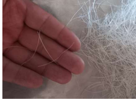
Figura 17. Fibras de tereftalato de polietileno.
