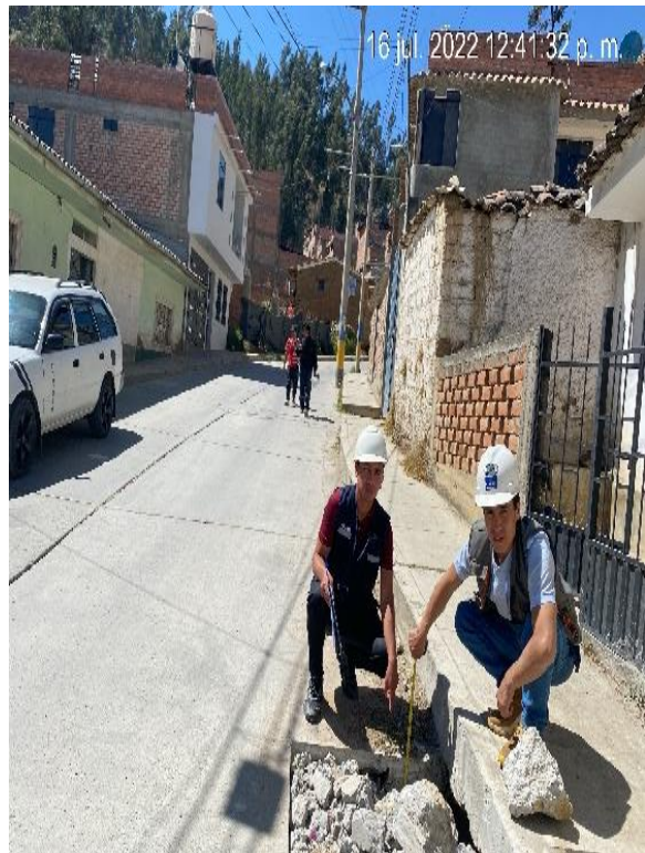
20 cm espesor del pavimento rígido del Jr. horacio Zevallos
