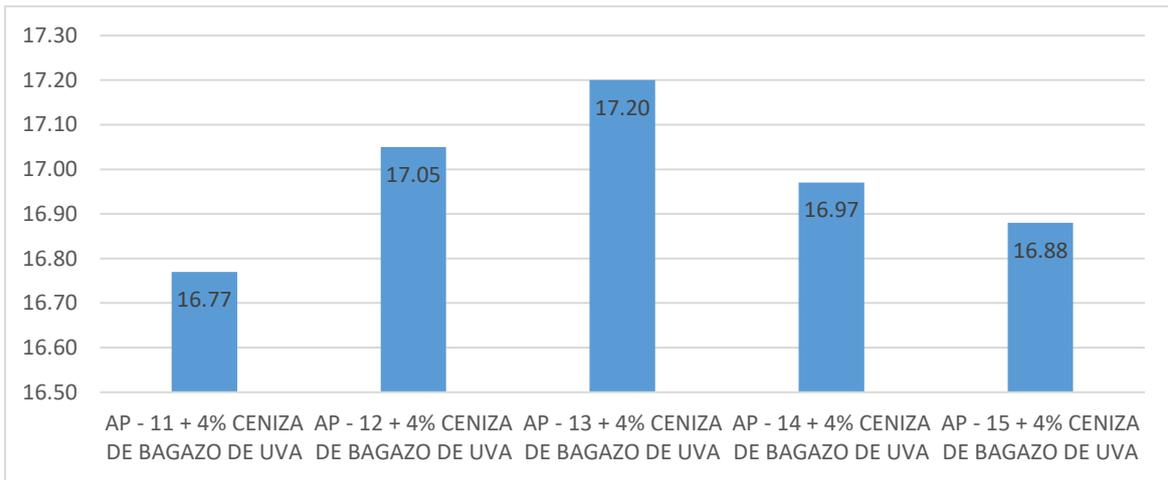
Figura 6. Diagrama de comparación de la resistencia a la compresión adobe patrón, incorporando ceniza de bagazo de uva en un 4%.
