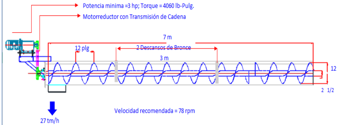
Figura 30. Diseño transportador helicoidal_ dibujo transportador helicoidal.
