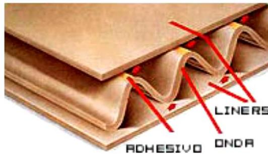
El cartón corrugado es un material para la fabricación de envases y embalajes, se compone de tres o cinco papeles siendo los exteriores lisos y los interiores ondulados, lo que otorga a la estructura una gran resistencia mecánica. Este material está fabricado de celulosa que está formado por la unión de varias hojas lisas que uno o varios ondulados que mantienen equidistantes, confiriéndole la propiedad de ser indeformable. (Marino Javkin y otros, 2015 p. 3)
