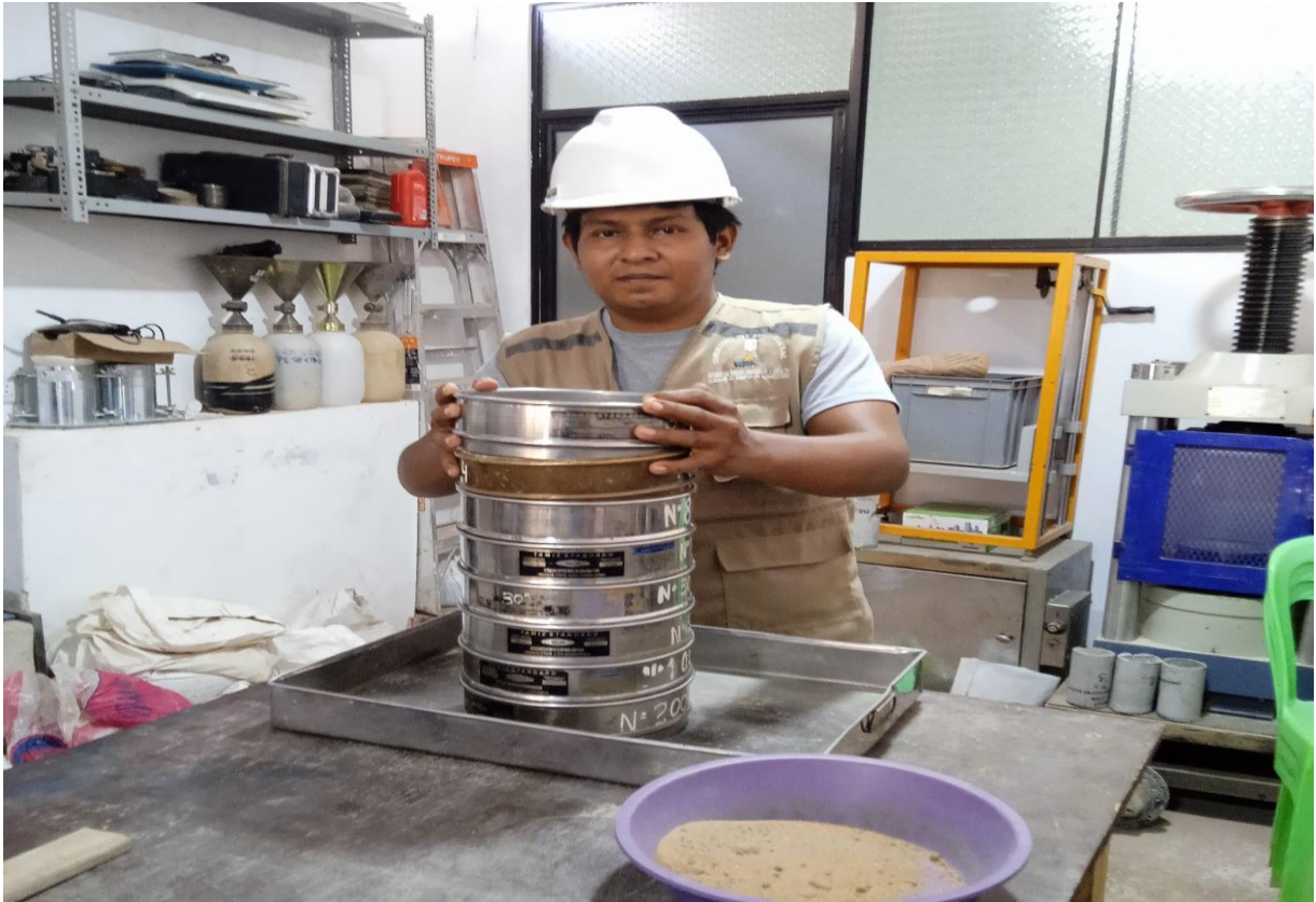
Figura 20. Ensayo de los agregados – Granulometría
