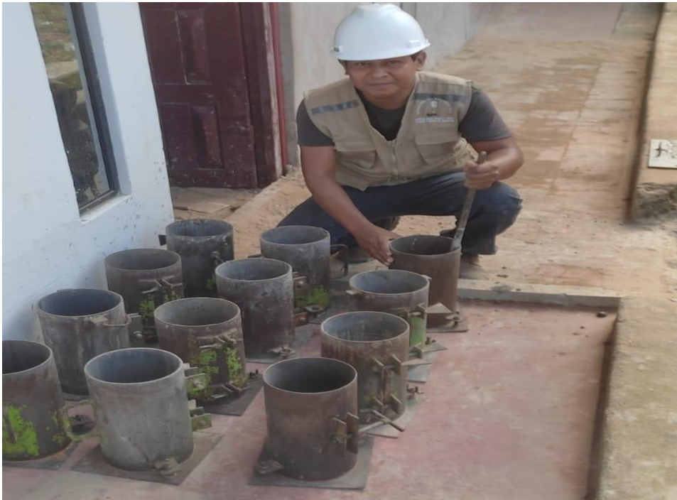
Figura 24. Moldeados de testigos de concreto
