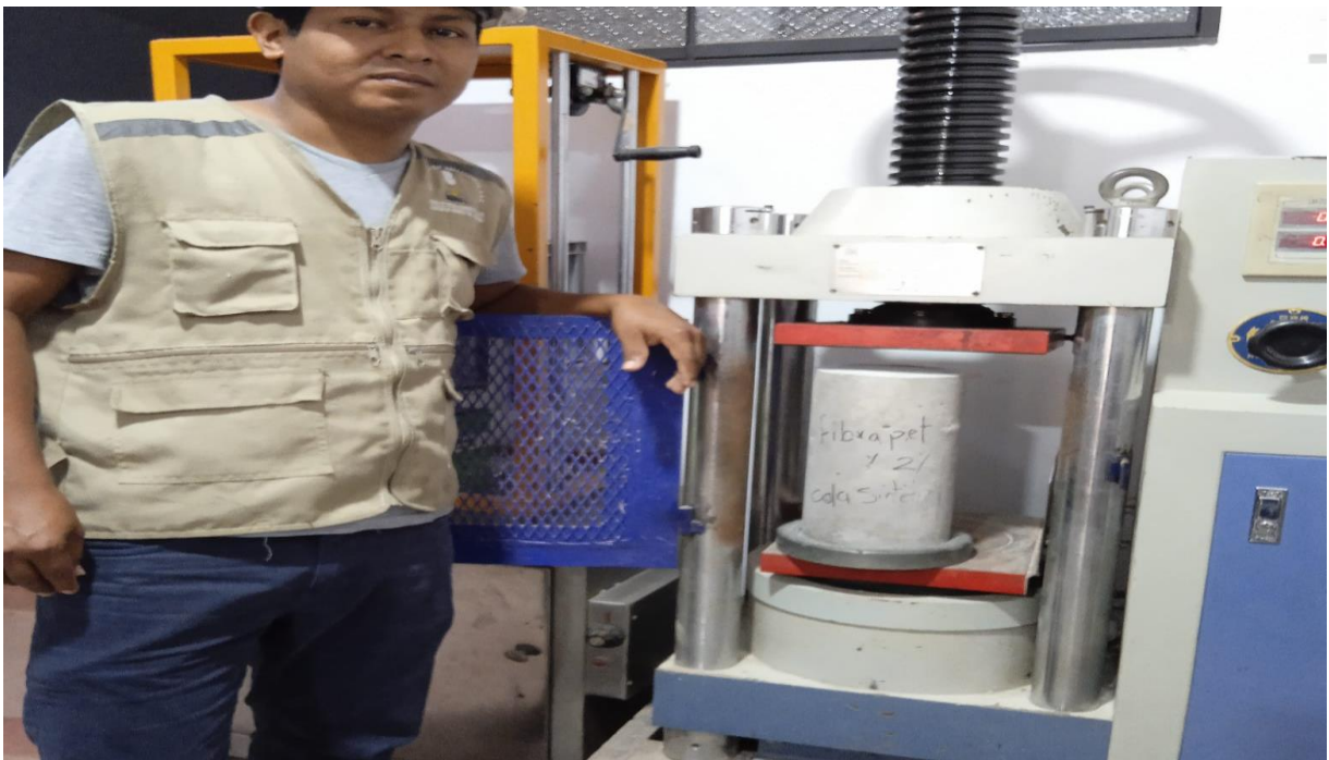
Figura 26. Ensayo de roturas de probetas de concreto 28 días
