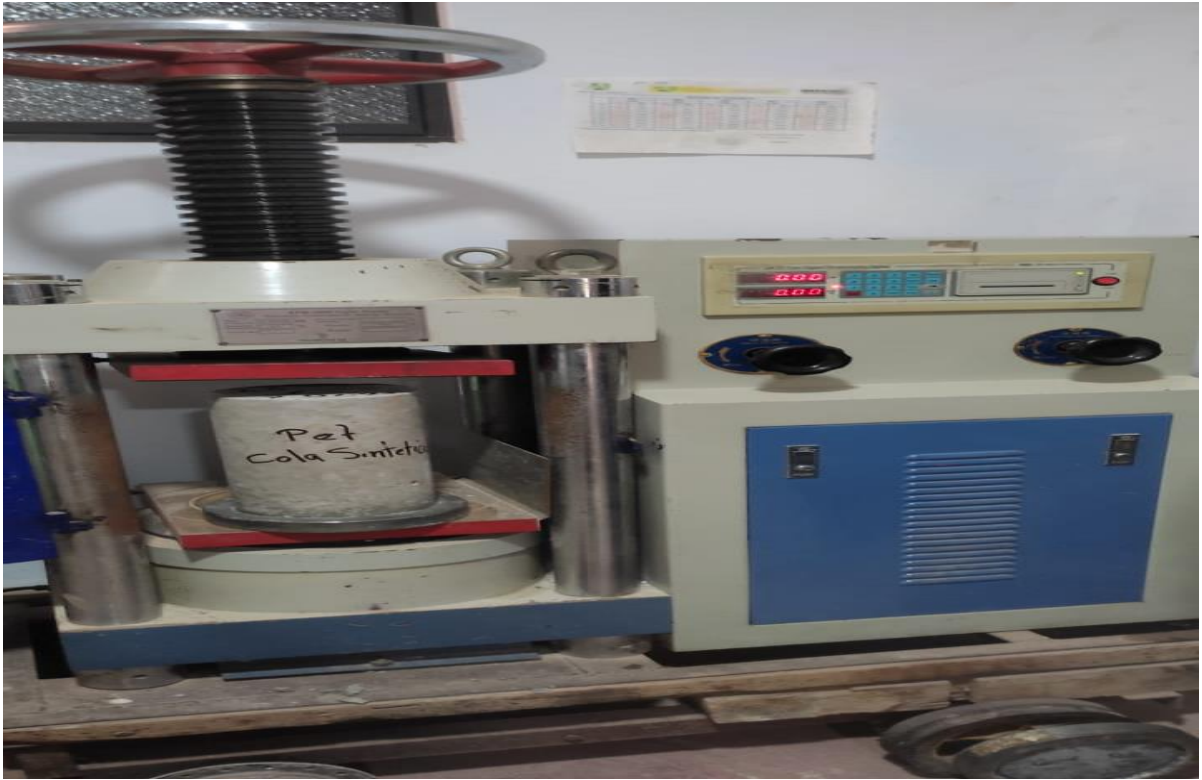
Figura 25. Ensayo de roturas de probetas de concreto 7 y 14 días
