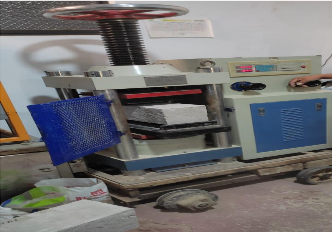
Figura 29. Ensayo de roturas de vigas de concreto 28 días
