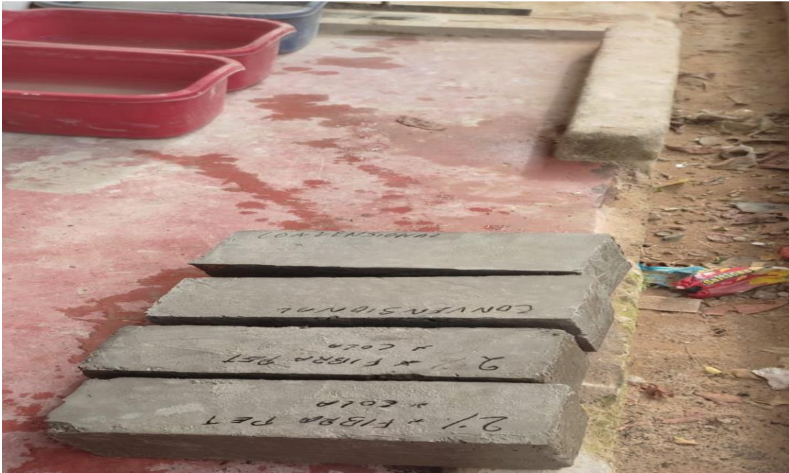
Figura 27. Moldeados de vigas de concreto
