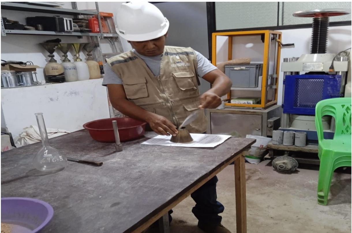
Figura 22. Ensayo de los agregados– Peso específico
