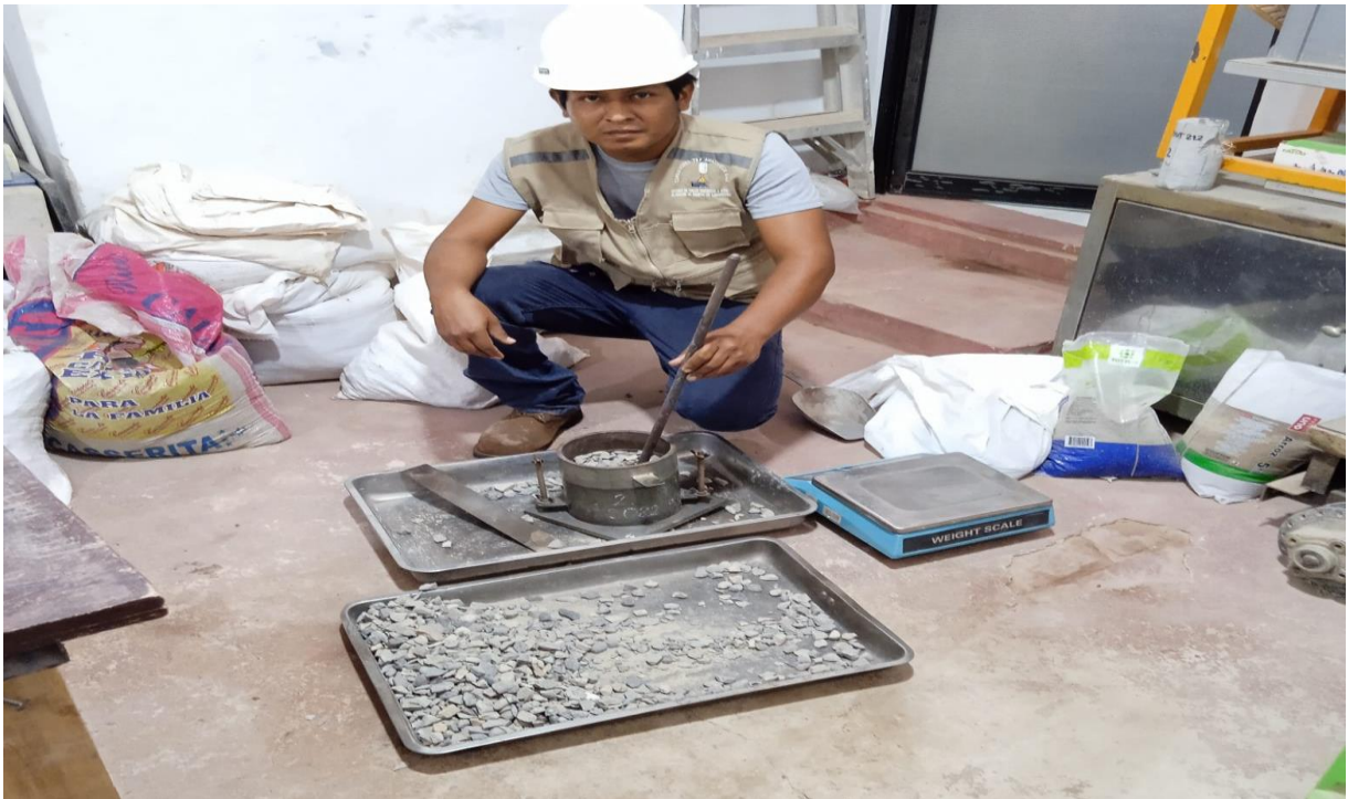
Figura 21. Ensayo de los agregados – Peso unitario suelto y compactado
