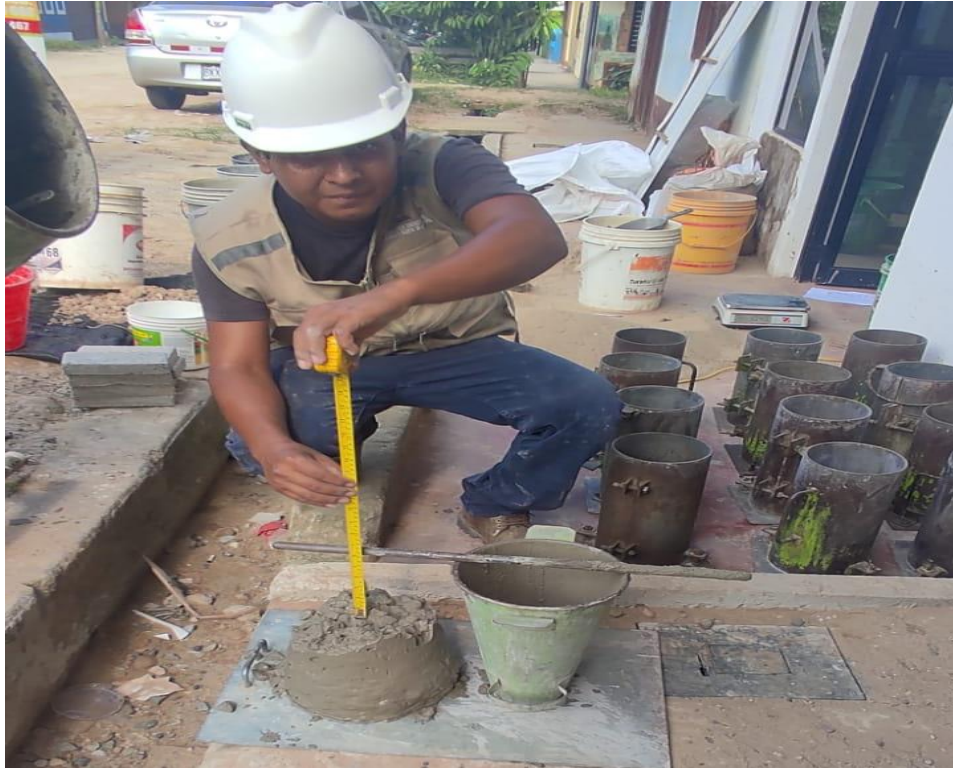
Figura 23. Ensayo del cono de abras – Slump
