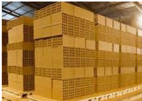
Figura 4: Ejemplo de empilado de ladrillo para secado
