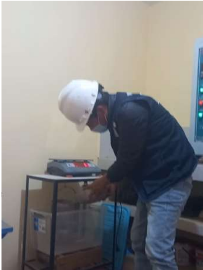
Figura 22. Colocación del agregado grueso al contenedor.
