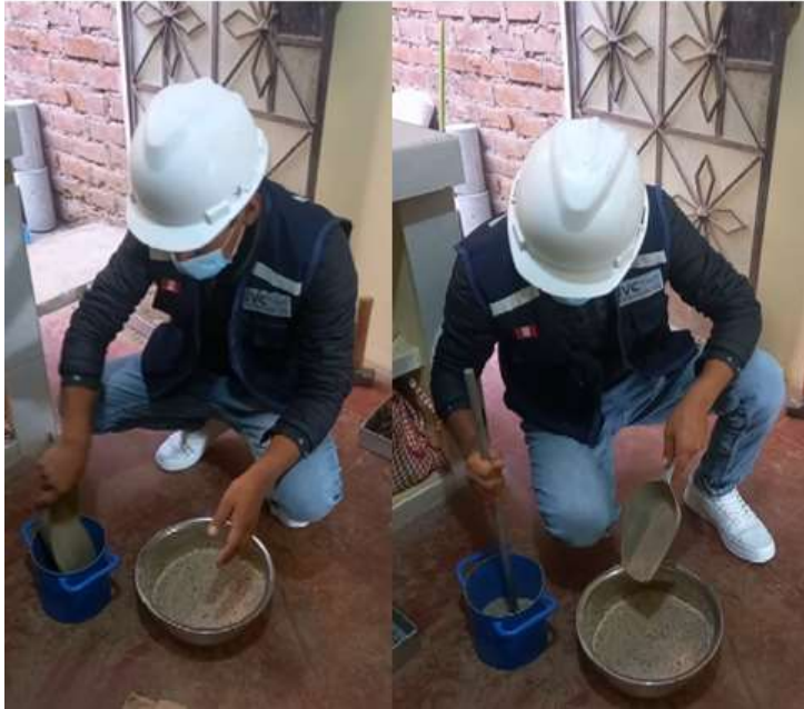
Figura 14. Llenado y compactado del agregado fino.
