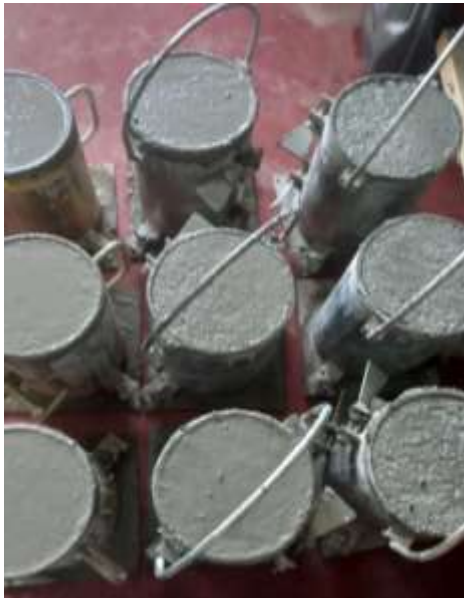
Figura 31. Probetas completamente llenas de concreto.
