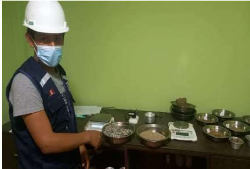
Figura 19. Sacamos del horno y pesamos el agregado grueso.
