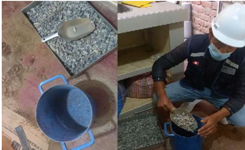
Figura 26. Llenado y compactado del agregado grueso.
