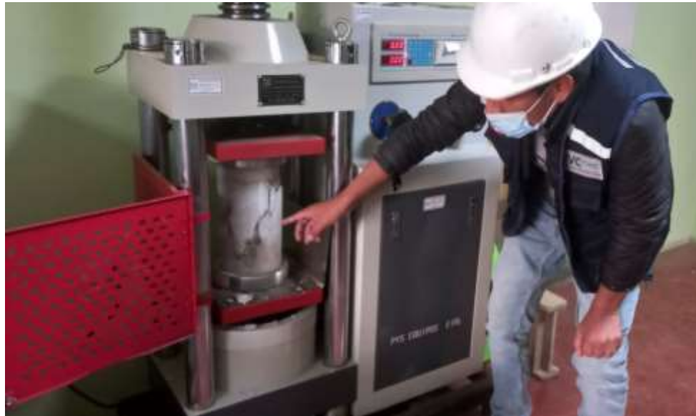
Figura 35. Rotura de probetas.
