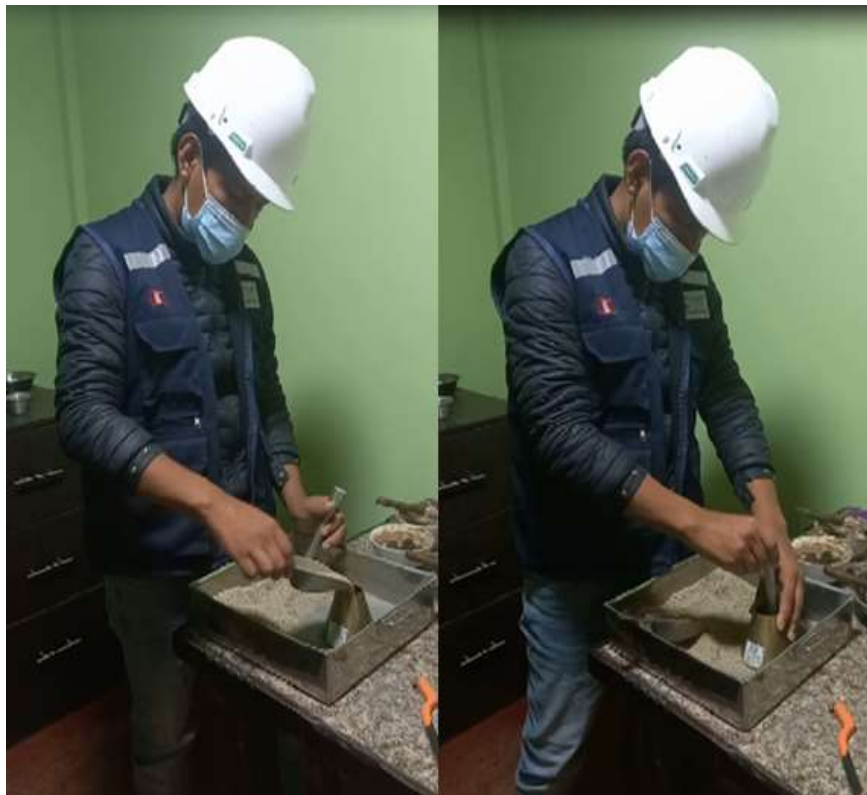
Figura 11. Llenado del molde cónico y apisonado.
