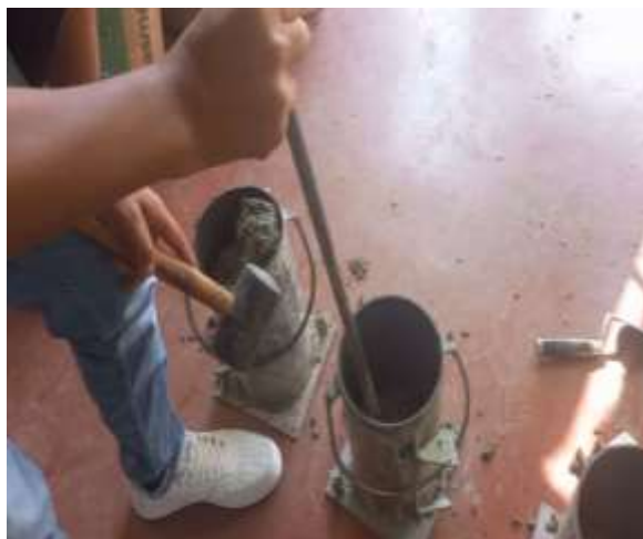
Figura 29. Llenado de probetas en 3 capas y chuseado.
