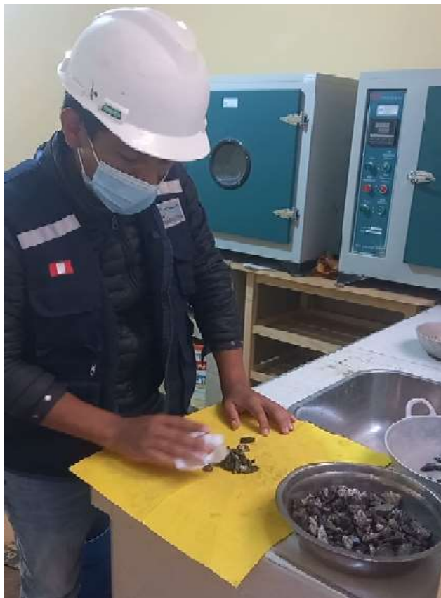
Figura 21. Proceso de secado del agregado grueso.
