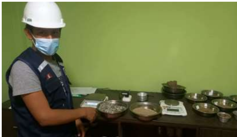
Figura 8. Sacamos del horno y pesamos el agregado fino.
