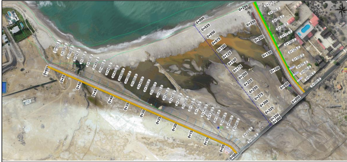
Figura 41. Topografía y colocación de diques.
