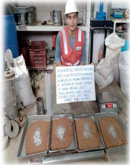
Foto N° 20 Muestra de Arcilla mezclado con PET al 0.8%
