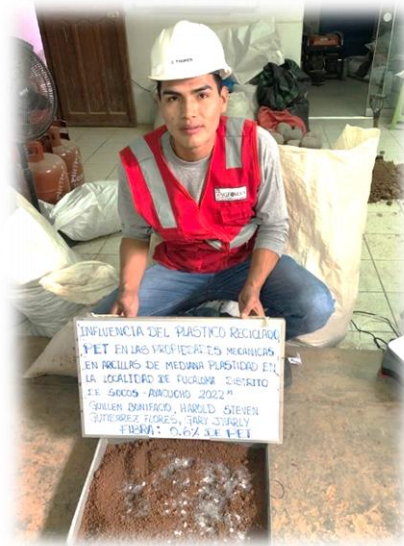
Foto N° 23 Muestra de arcilla de 6kg. (CBR)
