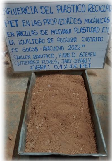
Foto N° 22 Muestra de arcilla de 6kg. (CBR)
