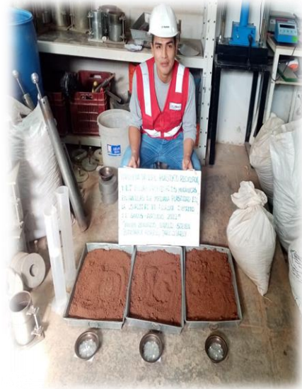
Foto N° 21 Muestra de arcilla de 6kg. (CBR)
