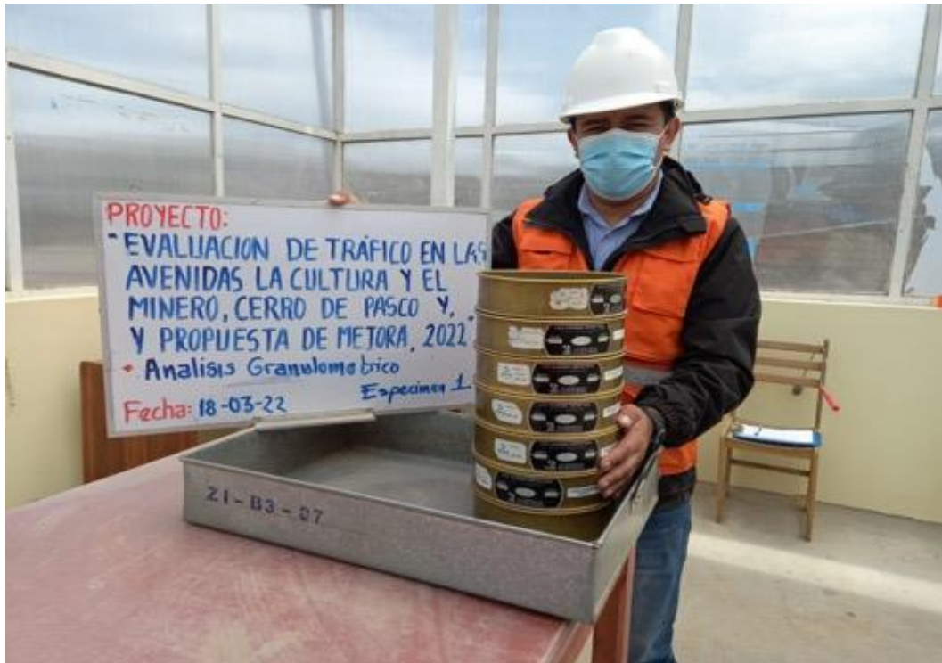
Ensayo de Análisis granulométrico para los especímenes 1 – 2 – 3
