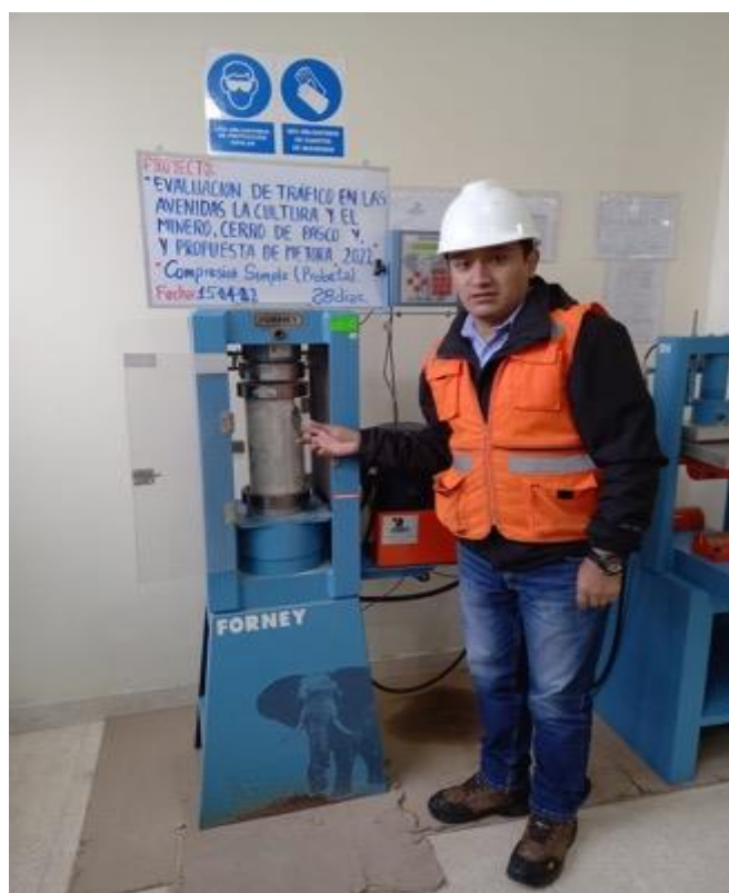
Rotura de Probeta de 28 días
