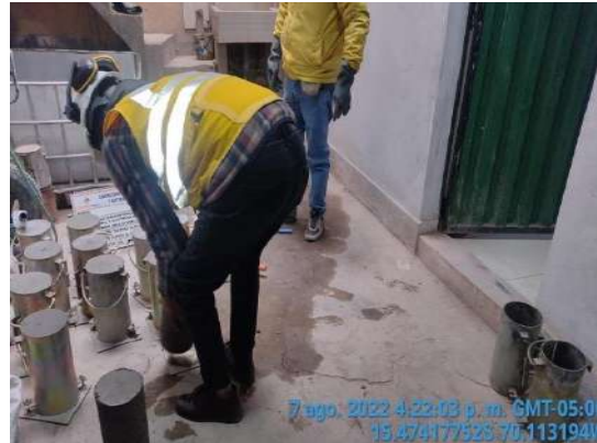
Figura N°22: Desmoldado de probetas cilíndricas
