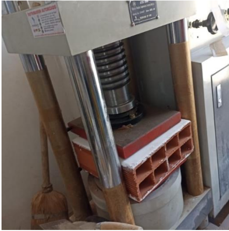
Fotografía 19. Ensayo de resistencia a la compresión de ladrillo industrial
