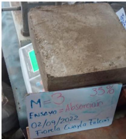
Fotografía 15. Ensayo de absorción de ladrillo ecológico
