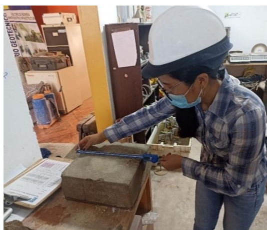
Fotografía 11. Medición de la Variación dimensional
