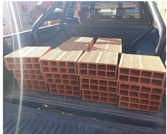
Fotografía 2. Ladrillos de arcilla para techo de 12 cm.
