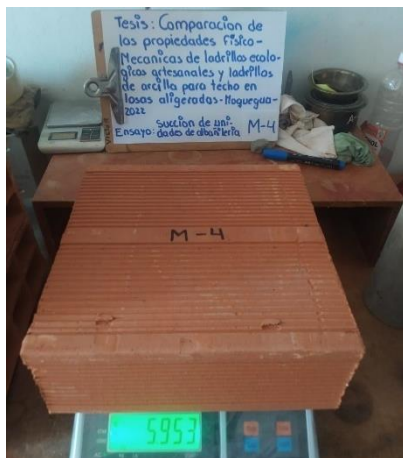
Fotografía 17. Ensayo de succión de ladrillo industrial
