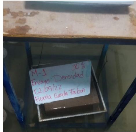
Figura 33. Ensayo de Densidad de ladrillo ecológico
