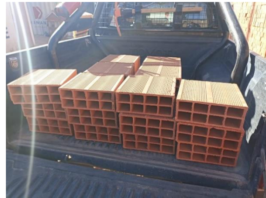
Figura 16. Traslado de ladrillos de arcilla de techo
