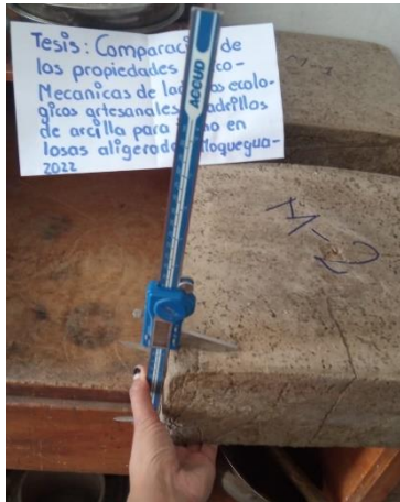
Fotografía 13. Variación dimensional de ladrillo ecológico
