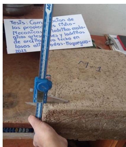
Figura 30. Ensayo de variación dimensional – ladrillo ecológico artesanal
