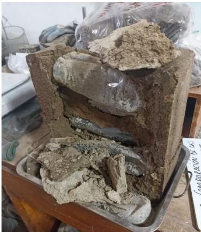
Fotografía 21. Interior de ladrillo ecológico artesanal
