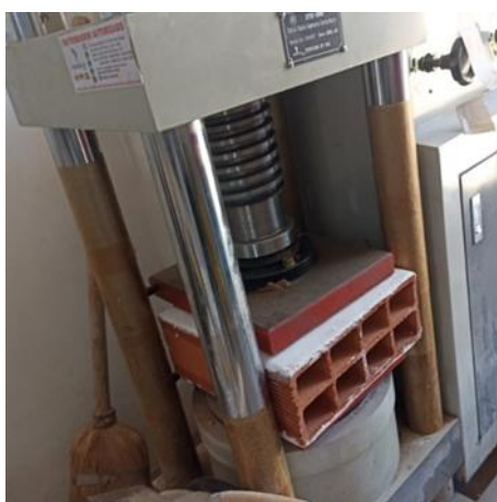
Figura 41. Ensayo de resistencia a la compresión de ladrillo de arcilla
