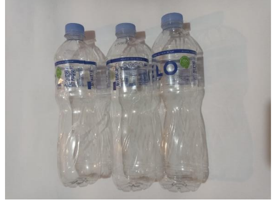
Figura 18. Empleo de 7 botellas plásticas por ladrillo
