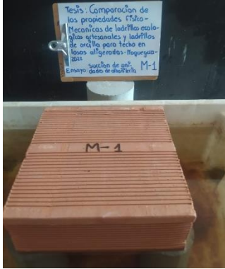
Figura 38. Ensayo de Succión de ladrillo de arcilla
