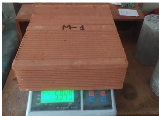
Figura 35. Ensayo de Absorción de ladrillo de arcilla
