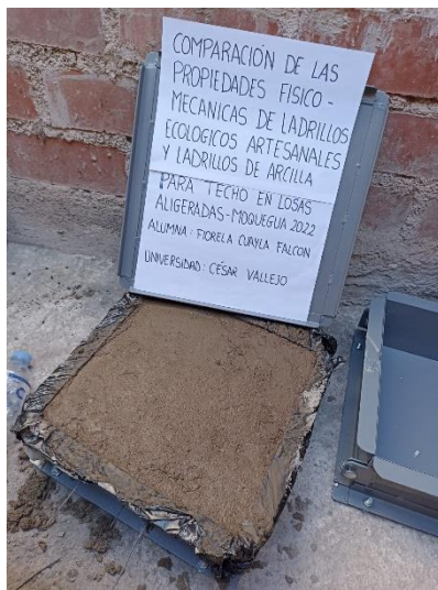
Figura 22. Nivelación de ladrillo ecológico
