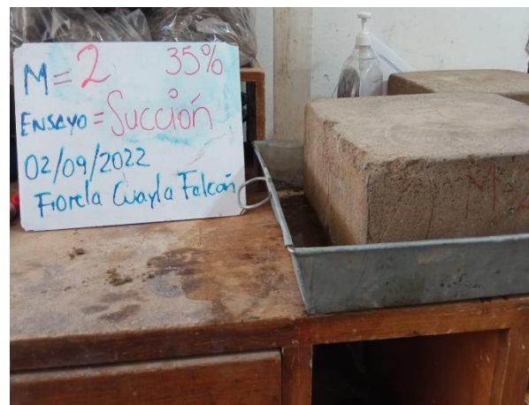
Fotografía 16. Peso de ladrillo ecológico sumergido
