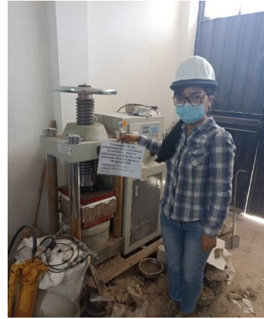
Fotografía 20. Ensayo de resistencia a la compresión de ladrillo ecológico
