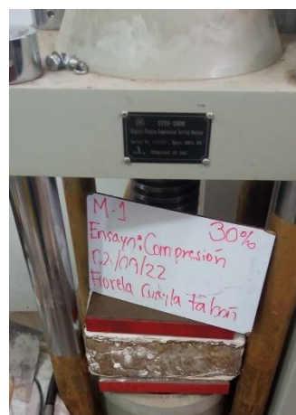
Figura 42. Ensayo de resistencia a la compresión de ladrillo ecológico
