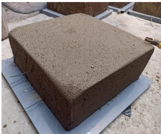
Fotografía 9. Desmoldado del ladrillo 24 hrs después
