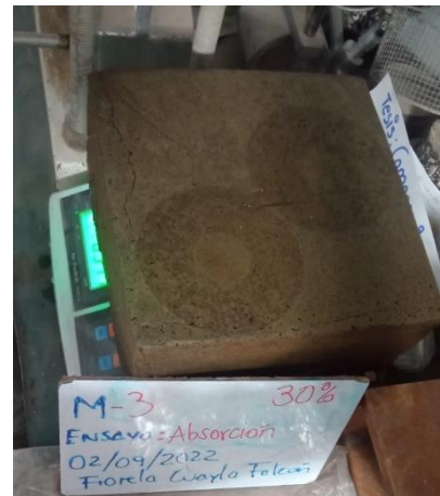
Fotografía 16. Peso de ladrillo ecológico sumergido
