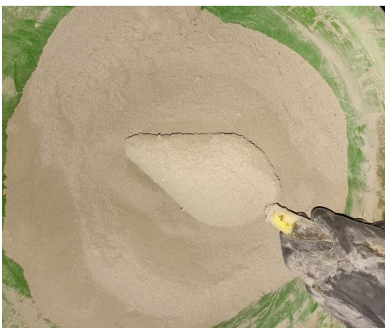
Fotografía 5. Mezcla del cemento y el aserrín
