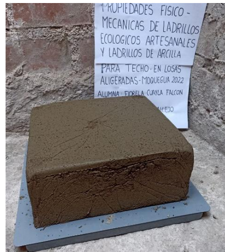
Figura 23. Desmolde de ladrillo pasadas 24 horas
