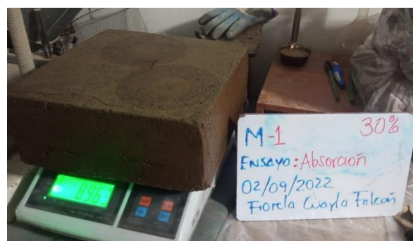
Figura 36. Ensayo de Absorción de ladrillo ecológico
