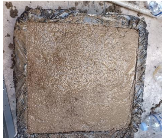
Fotografía 8. Terminado final del ladrillo
