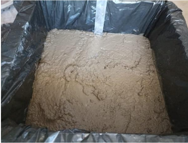
Figura 20. Mezcla de cemento y aserrín
