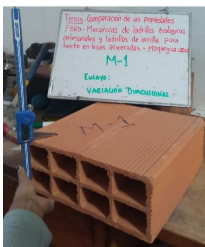
Figura 29. Ensayo de variación dimensional – ladrillo de arcilla
