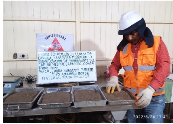
Figura 28. Material para el ensayo de Proctor modificado
