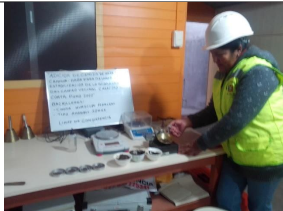
Fotografía 22. Ensayo de límite líquido
