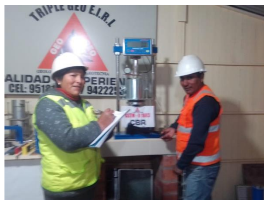
Figura 35. Aplicación de cargas
