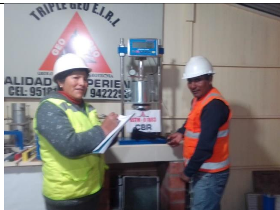
Fotografía 24. Ensayo de Californian Bearing Ratio
