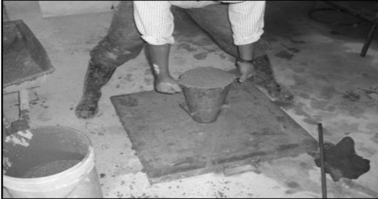
*Figura 4. Ensayo de cono de Abrams.*
