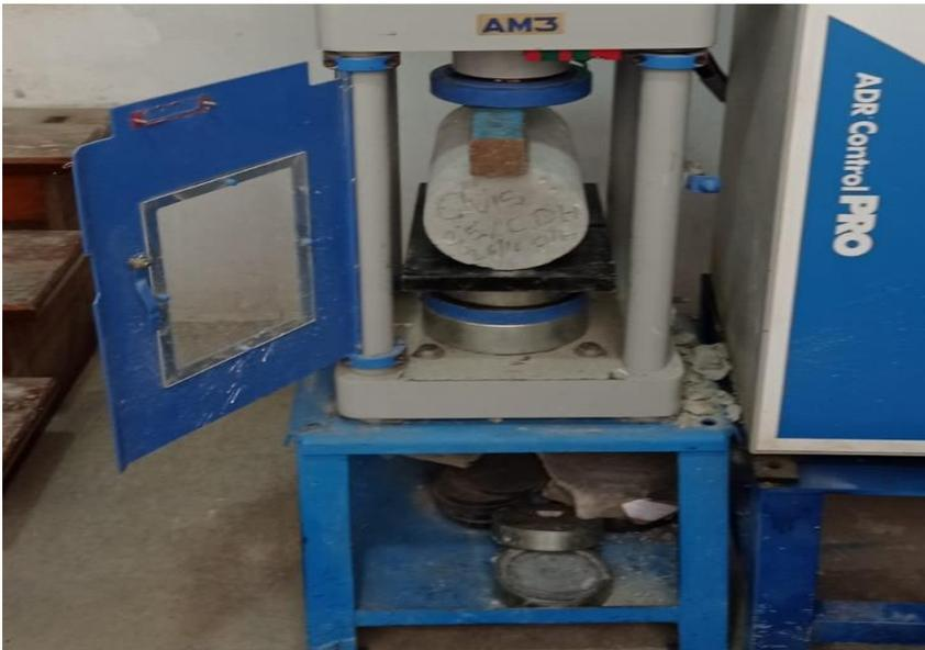
Figura 6. Ensayo maquina de compresion traccion diametral.
