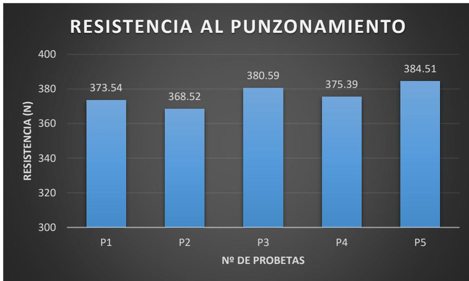
**Figura 5:** Resumen de resistencia al punzonamiento
