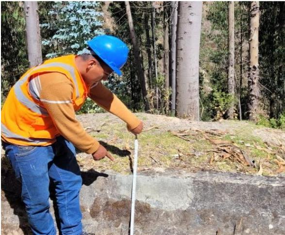
**Figura 12:** Medición de una cara del canal
