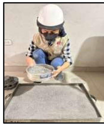
Foto 6. Pasando por el tamiz N° 200 las cenizas de bagazo de caña. Fuente: Elaboración propia.
