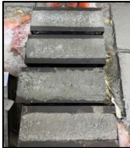
Figura 29. Llenado de vigas según la dosificación de cenizas Fuente: Elaboración propia
