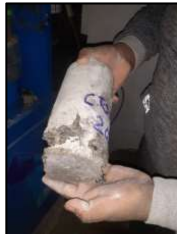
Foto 36. Observando el tipo de falla Fuente: Elaboración propia.
