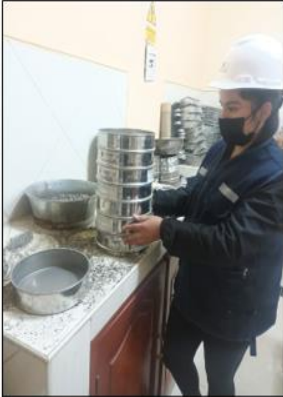
vista de la ejecución del ensayo granulométrico mediante tamizado
