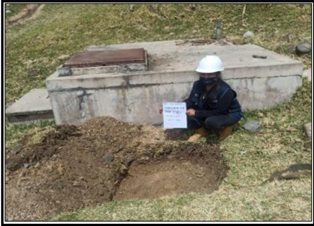
Vista de la realización de la calicata al pie del reservorio en las coordenadas E: 178019.66, N: 9088360.75, para la realización del EMS, y poder determinar la capacidad portante del suelo.
