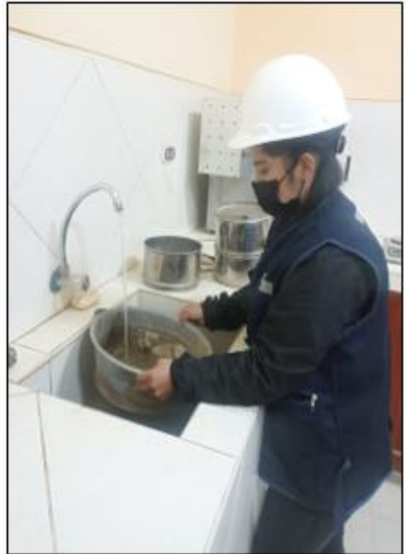
vista del lavado del material ,se pesa y se lleva al horno
