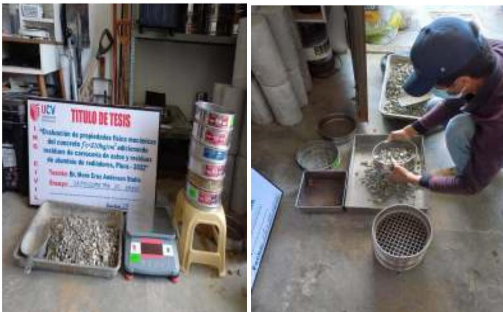
Figura 33. Granulometría de agregado grueso.
