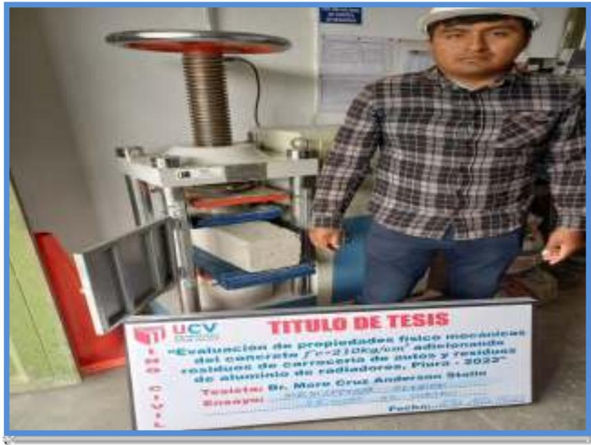
Figura 59. Ensayo a flexión a 28 días de curado.
