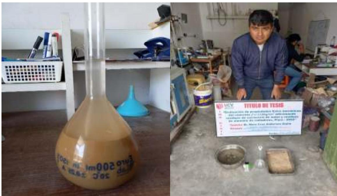
Figura 36. Ensayo de peso específico y absorción.
