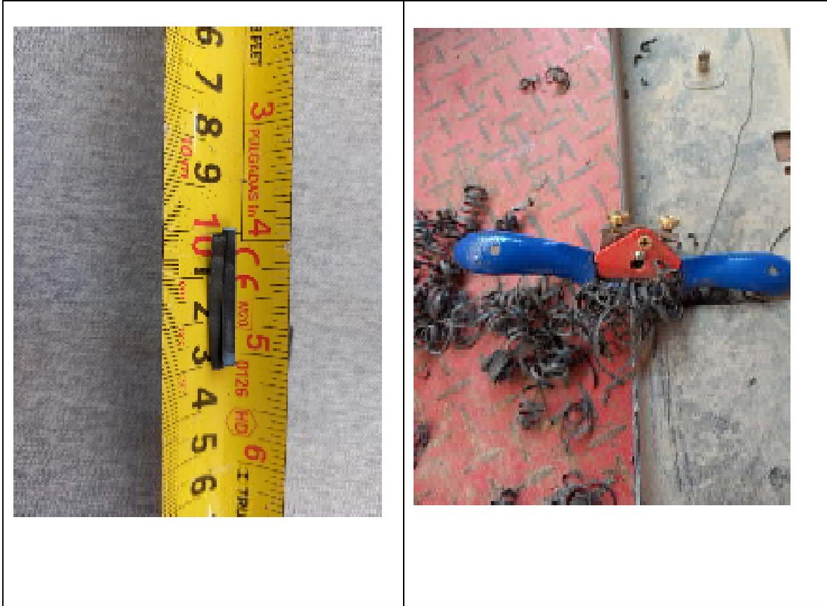
Proceso de obtención de residuos , semejantes a fibras para reforzar el concreto
