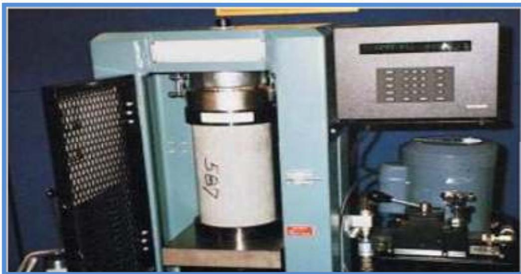
Figura 13. Ensayo a compresión.
