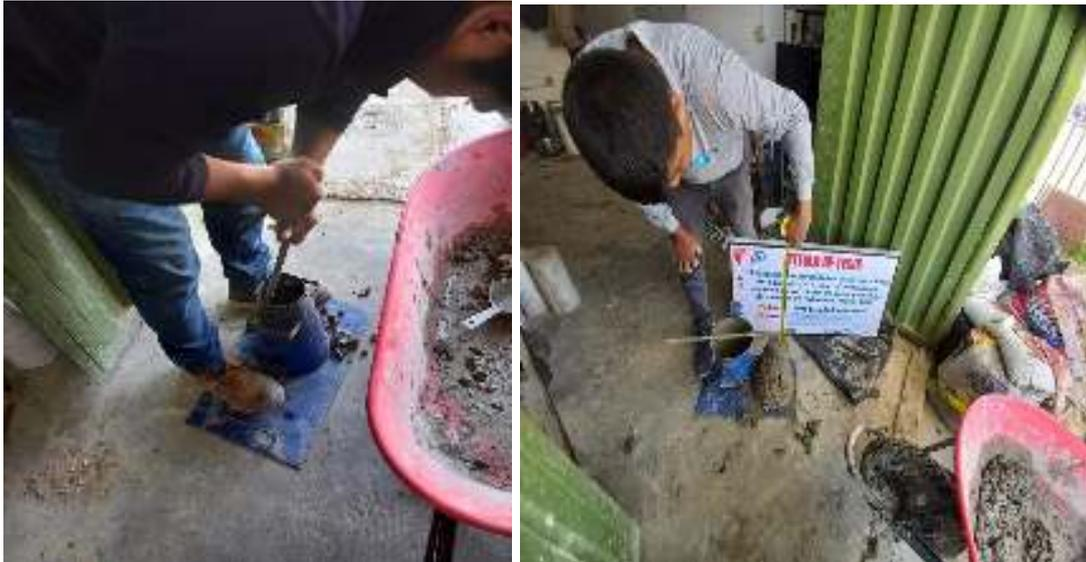
Figura 38. Ensayo de Slump de las mezclas.
