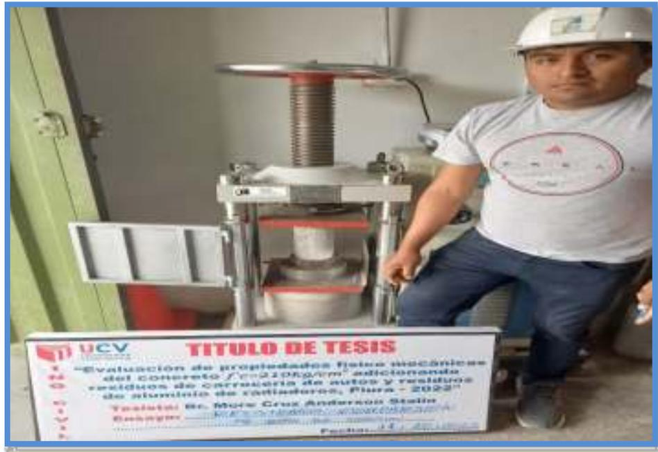
Figura 47. Resistencia a los 14 días de curado.
