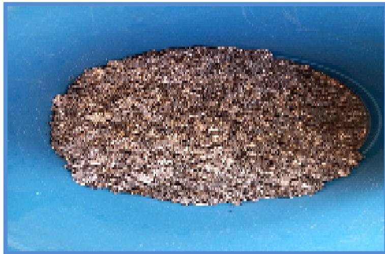
*Figura 24.* lavado de las impurezas del aluminio.
