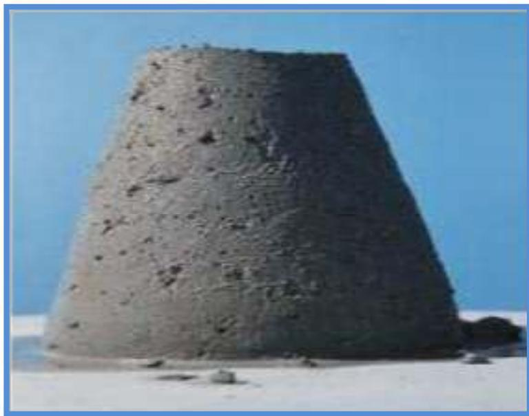
Figura 10. Concreto con alta consistencia.
