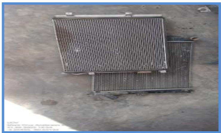
*Figura 22.* Radiadores usados de aluminio.
