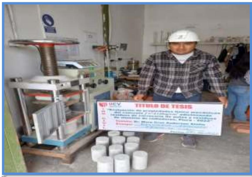
Figura 49. Ensayo a 28 días compresión.
