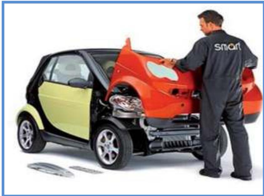
*Figura 3.* Vehículo con panelearía intercambiable de material plástico.
