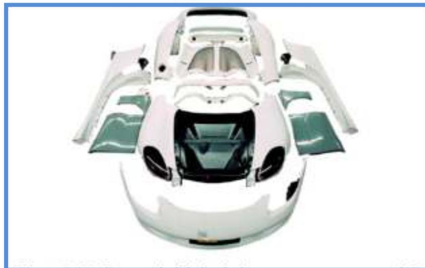
*Figura 4.* Carrocería fabricada íntegramente con material plástico.
