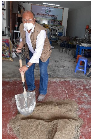
Figura 4 Cuarteado de agregado fino
