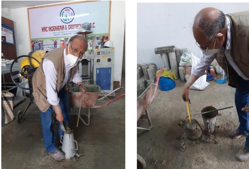
Figura 6. Cono de Abrams y medición de asentamiento
