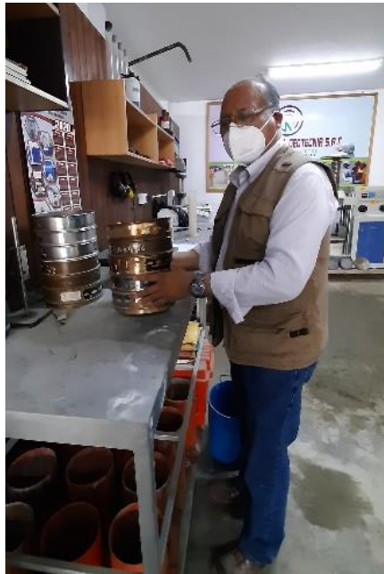
Figura 3. Tamizado de agregados
