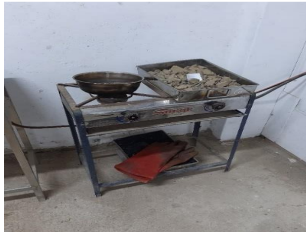
Figura 9. Agregado grueso en reposo por 24 horas
