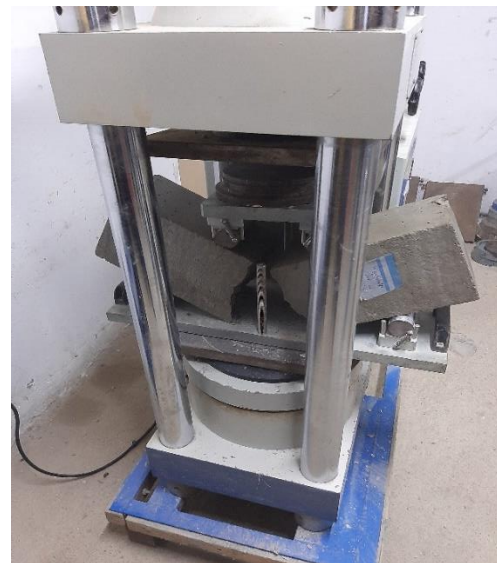
Figura 13. Preparación y rotura del testigo rectangular por flexión
