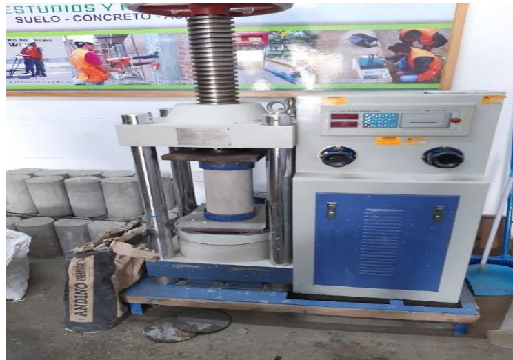
Figura 11. Ensayo de roturas de testigos por compresión
