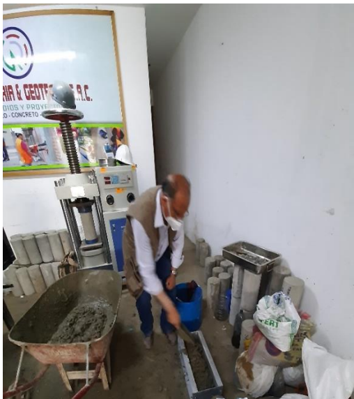
Figura 13. Preparación y rotura del testigo rectangular por flexión
