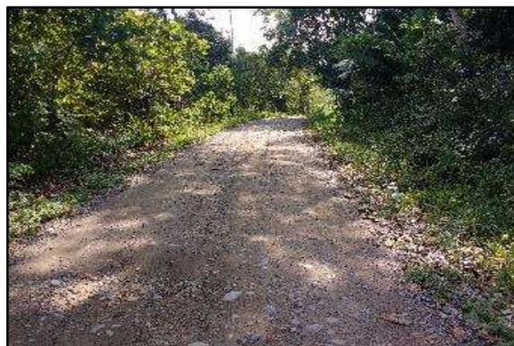
**Foto 10.** Tramo 0+250 al 0+500, Topografía Plano, con un ancho de superficie promedio de 4.00 m. presenta baches.
