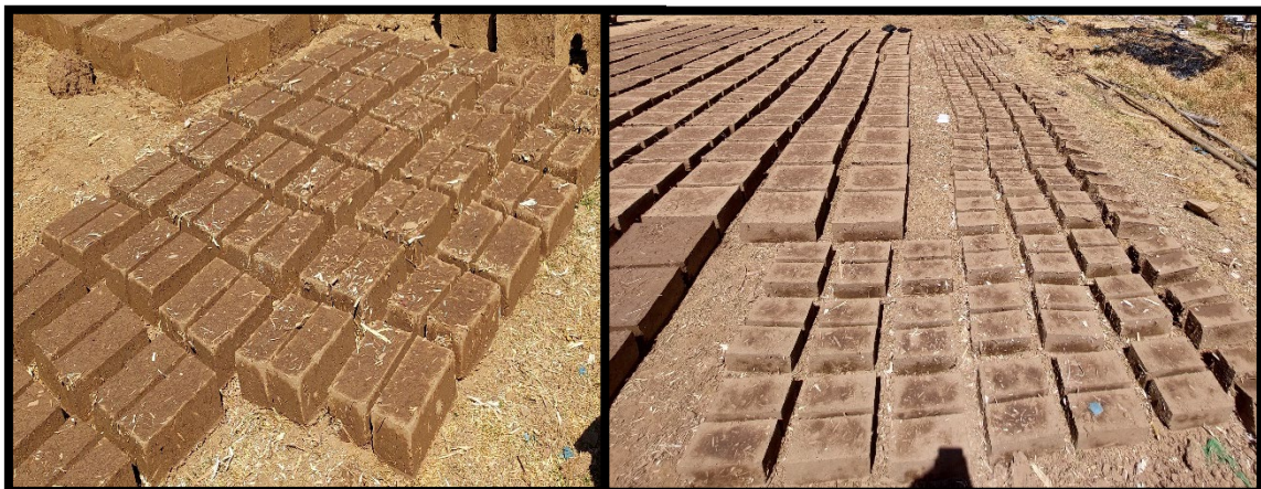
Figura 17: Proceso de secado de unidades de adobe
