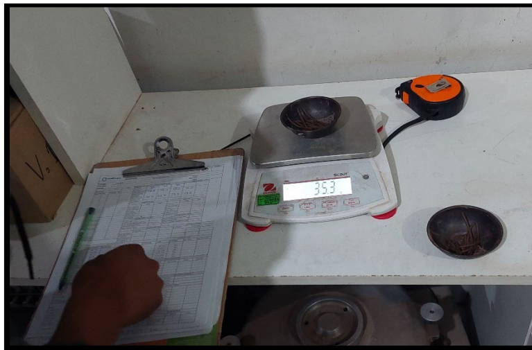
Figura 9: Prueba de contenido de humedad de material de cantera en laboratorio.,
