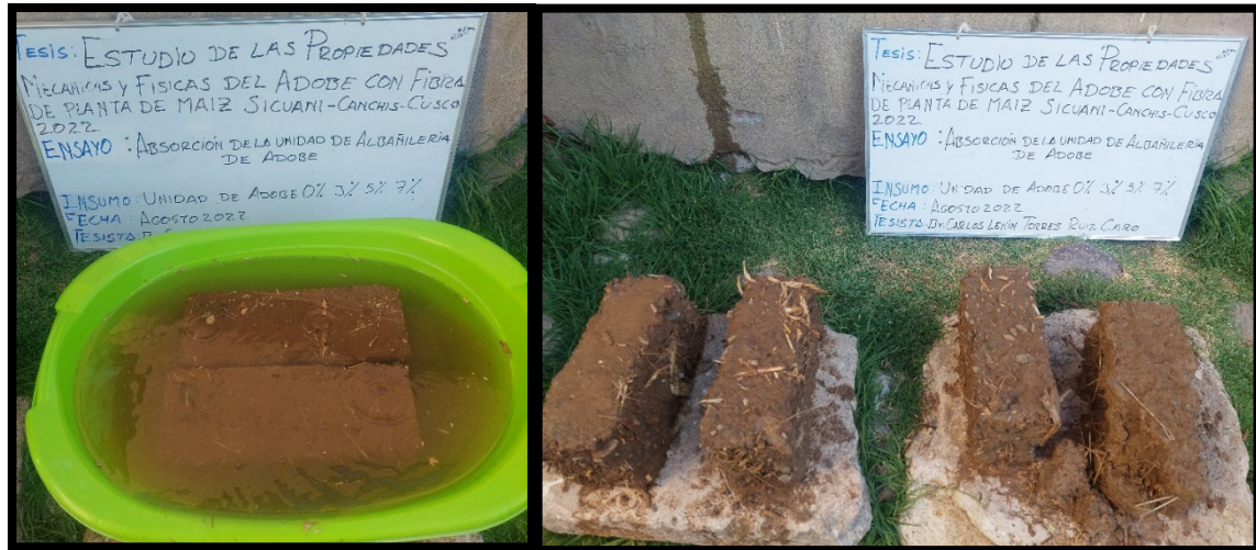
Figura 21: Ensayo de absorción en adobes.
