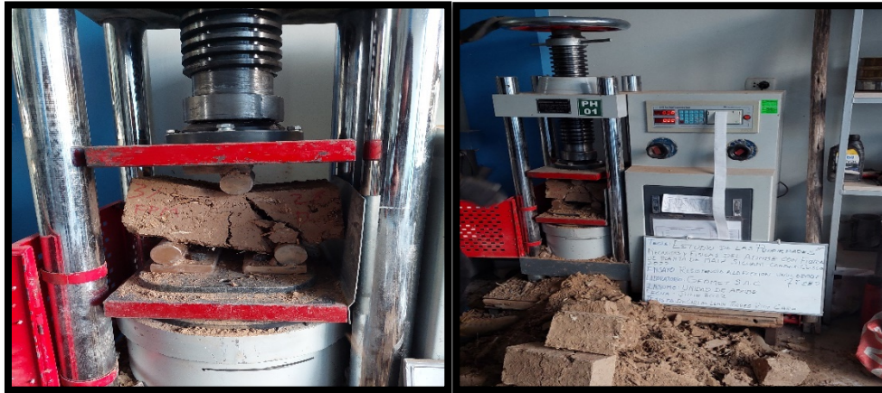
Figura 25: Ensayo de resistencia a la flexión de adobe
