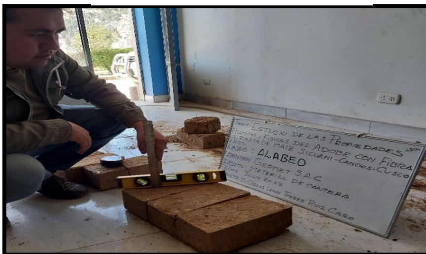
Figura 20: Ensayo de alabeo en adobes
