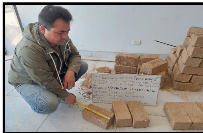
Figura 19: Ensayo de variación dimensional de unidades de adobe
