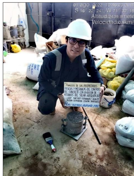
Figura 9 Peso unitario suelto y compactado del agregado fino
