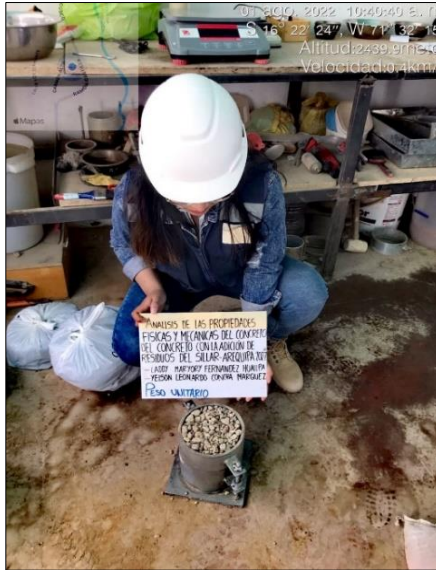
Figura 10 Peso unitario suelto y compactado del agregado grueso
