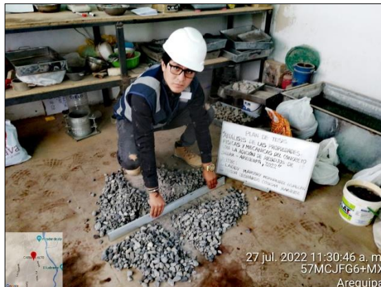
Figura 3 Cuarteo del agregado grueso Fuente: Elaboración propia
