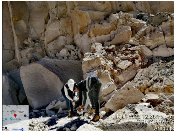
Figura 2 Recolección del sillar en la Cantera Fuente: Elaboración propia
