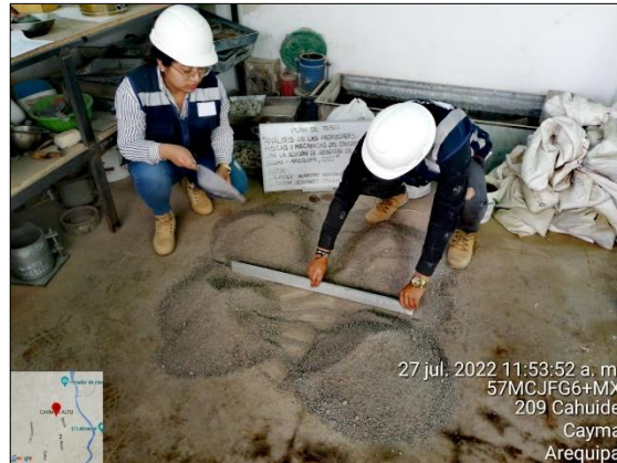
Figura 4 Cuarteo del agregado fino
