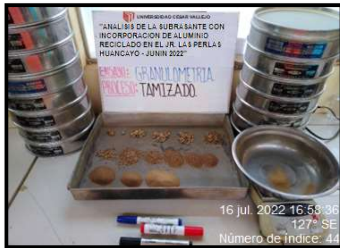
Figura 21. Tamizado de material.
