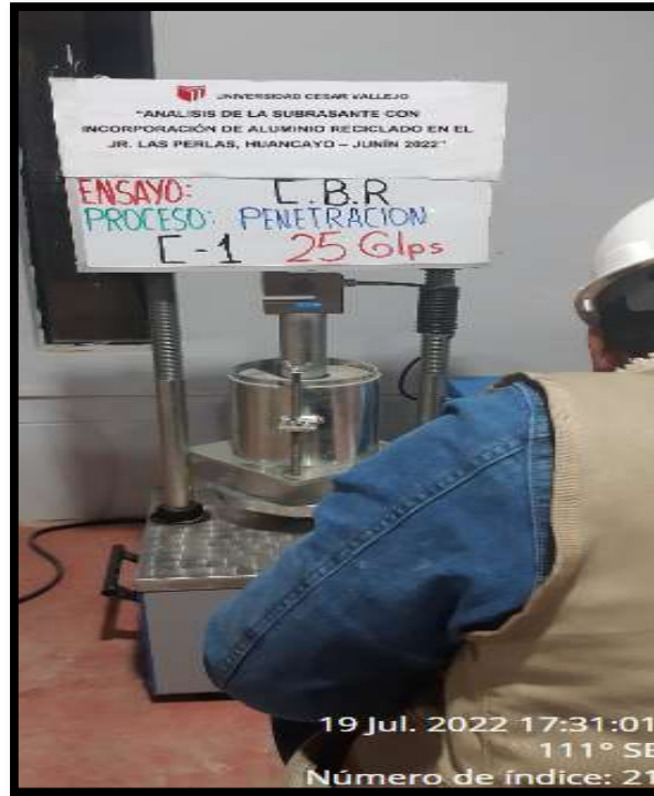
Figura 28. Ensayo de CBR – Penetración 1” – 25 Golpes.
