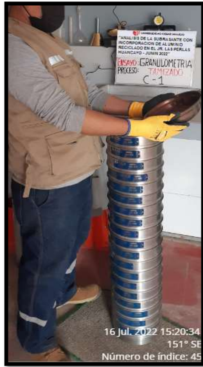
Figura 20. Tamizado de material.
