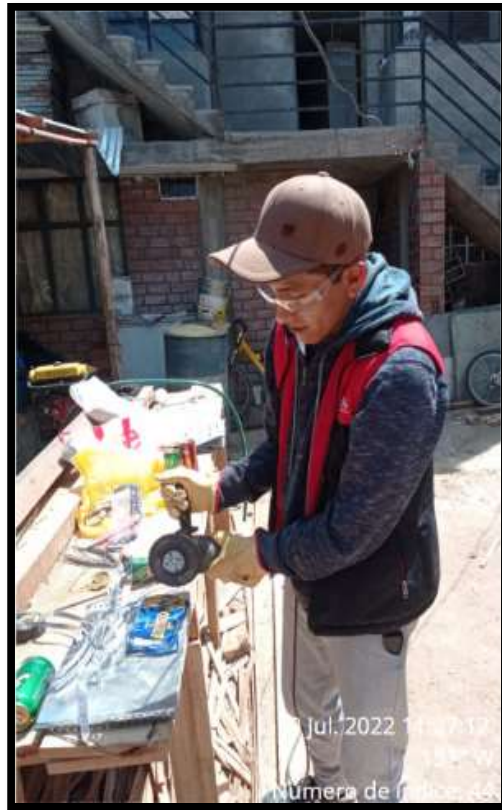
Figura 17. Trituración de Aluminio Reciclado.
