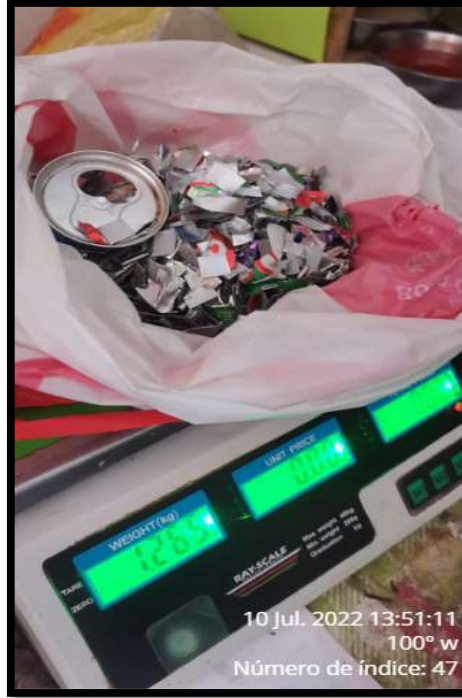
Figura 18. Trituración de Aluminio Reciclado total a pesar 1.08Kg
