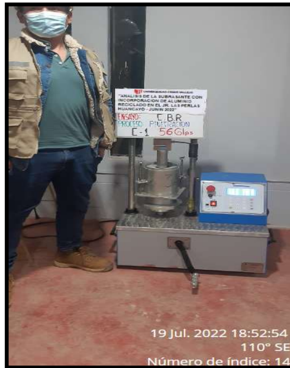
Figura 29. Ensayo de CBR – Penetración 1” – 56 Golpes.
