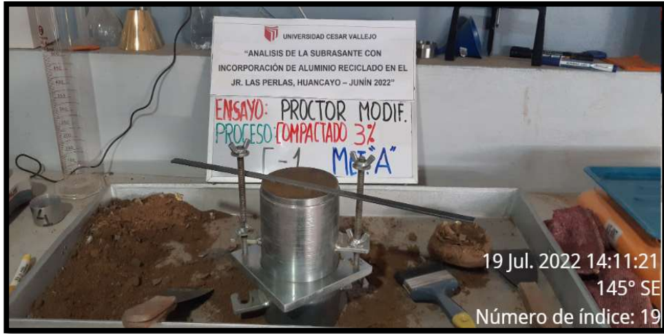
Figura 26. Ensayo de Proctor con Incorporación de 3% de Aluminio Reciclado
