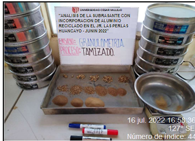
Figura 5. Ensayo de granulometría
