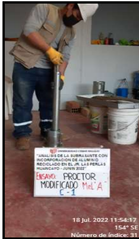
Figura 23. Ensayo de Proctor Modificado Met. A
