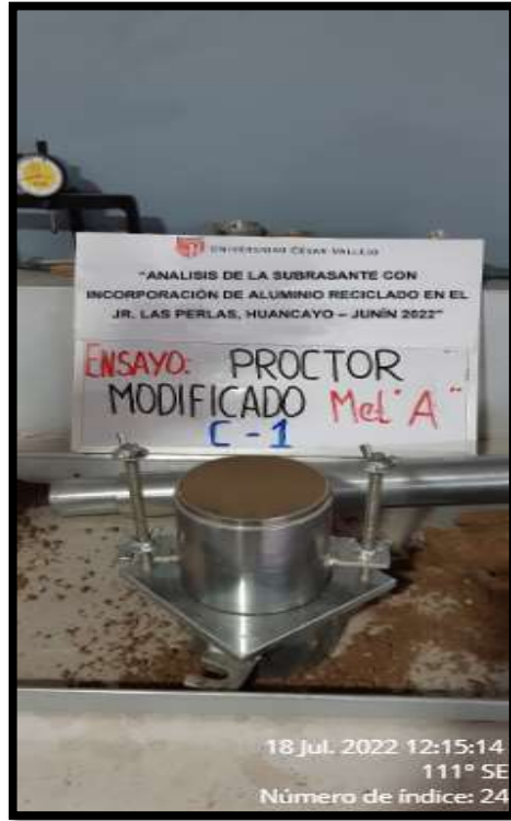
Figura 24. Ensayo de Proctor Modificado Met. A
