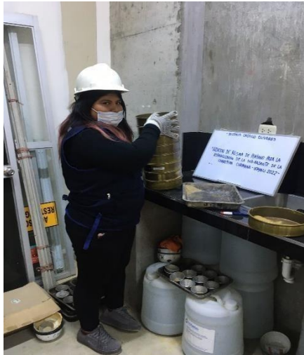
Figura 13. Ensayo de granulometría para ver la clasificación del suelo
