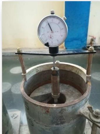
Figura 20: Lectura inicial de deformación en molde, antes de ser sumergida en poza de agua.
