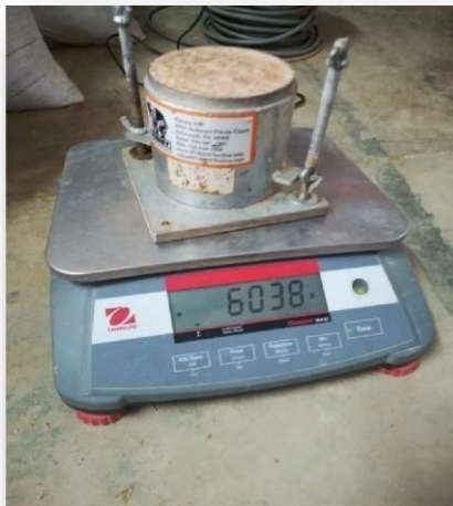
Figura 18: Pesado de molde más suelo compactado, Proctor modificado
