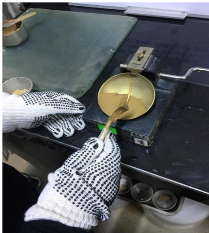
Figura 15. Ensayo de limite liquido usando la cuchara de Casagrande
