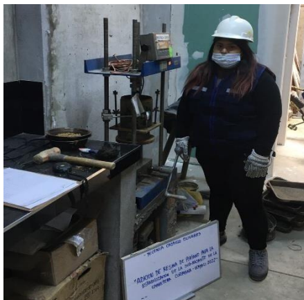
Figura 23. Ajuste de Dial, durante el uso de la prensa de CBR.
