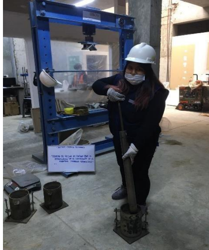
Figura 17. Ensayo de Proctor modificado.
