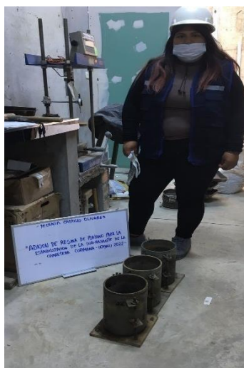
Figura 24. Compactación del suelo para realización del ensayo de CBR
