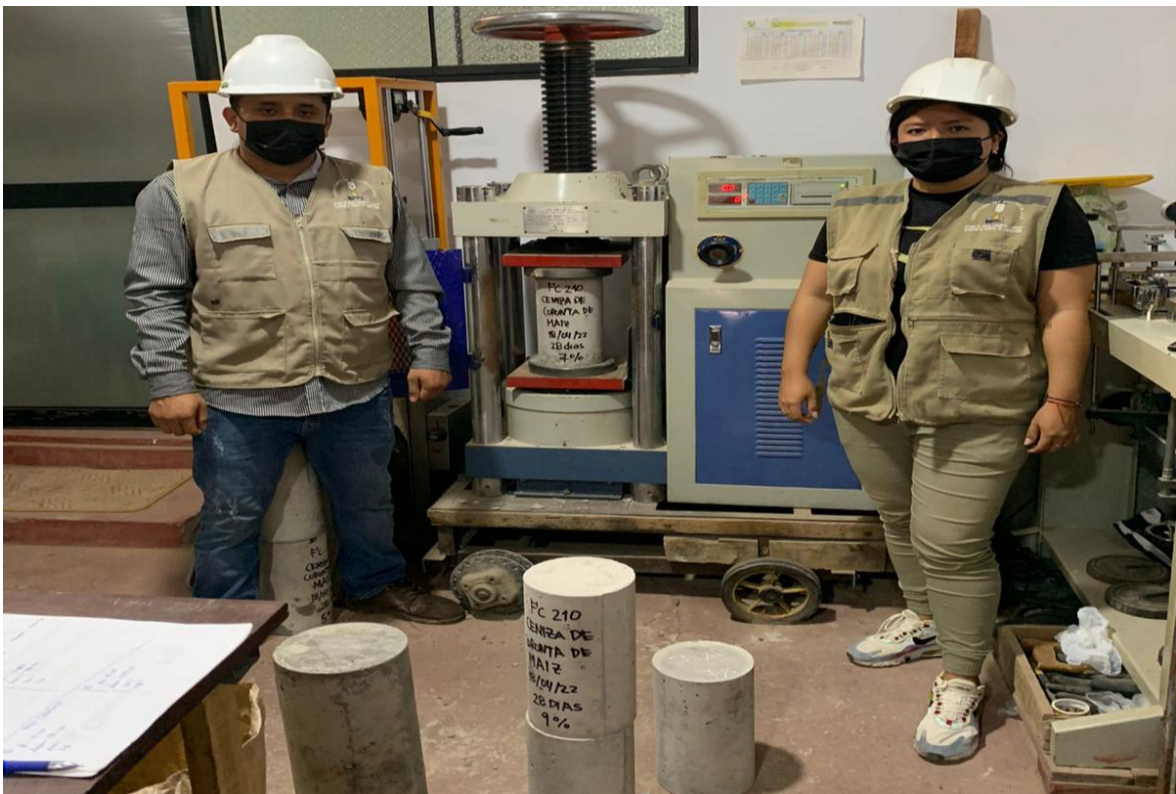
Figura 17. Ensayo de roturas de probetas de concreto 28 días
