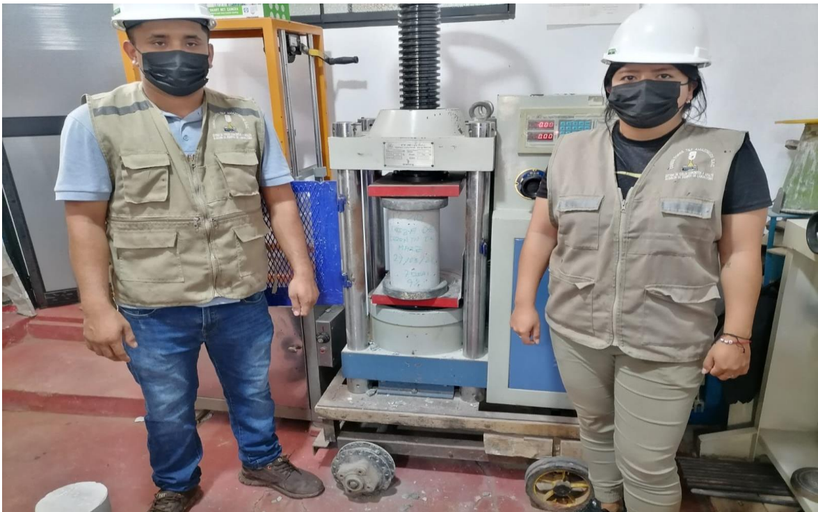
Figura 15. Ensayo de roturas de probetas de concreto 7 días
