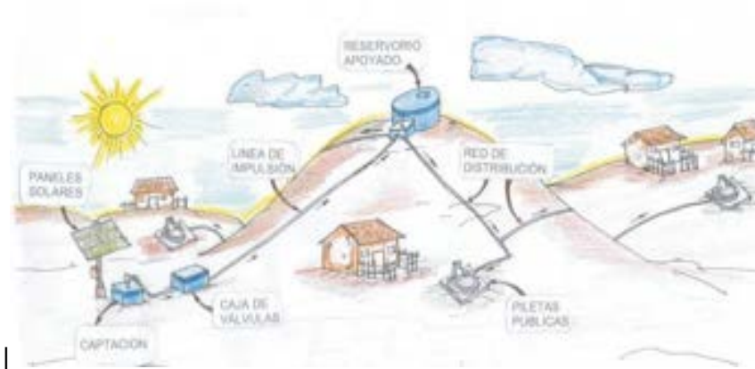
Figura: Redes de distribución
