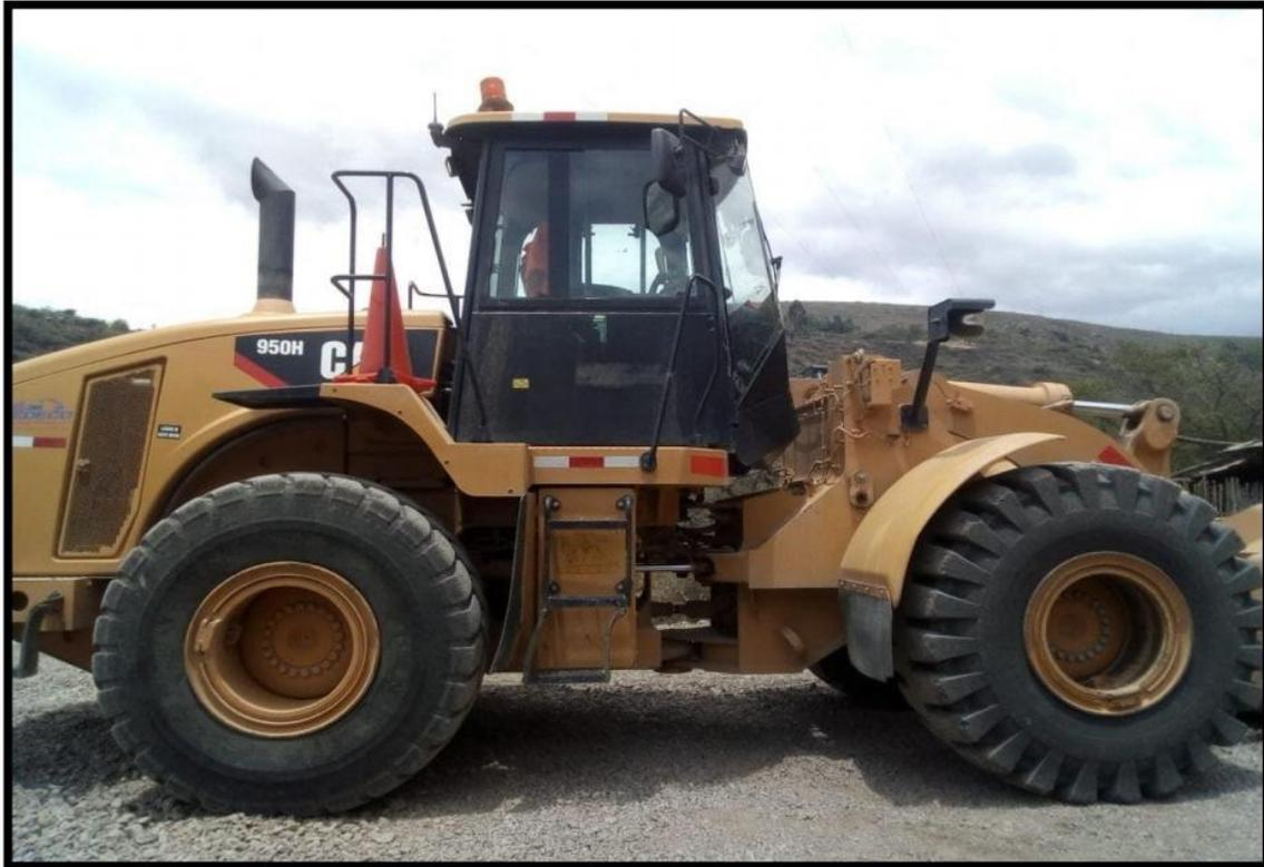
**Fotografía 3.** Maquinaria de carguío – cargador frontal CAT 950H.
