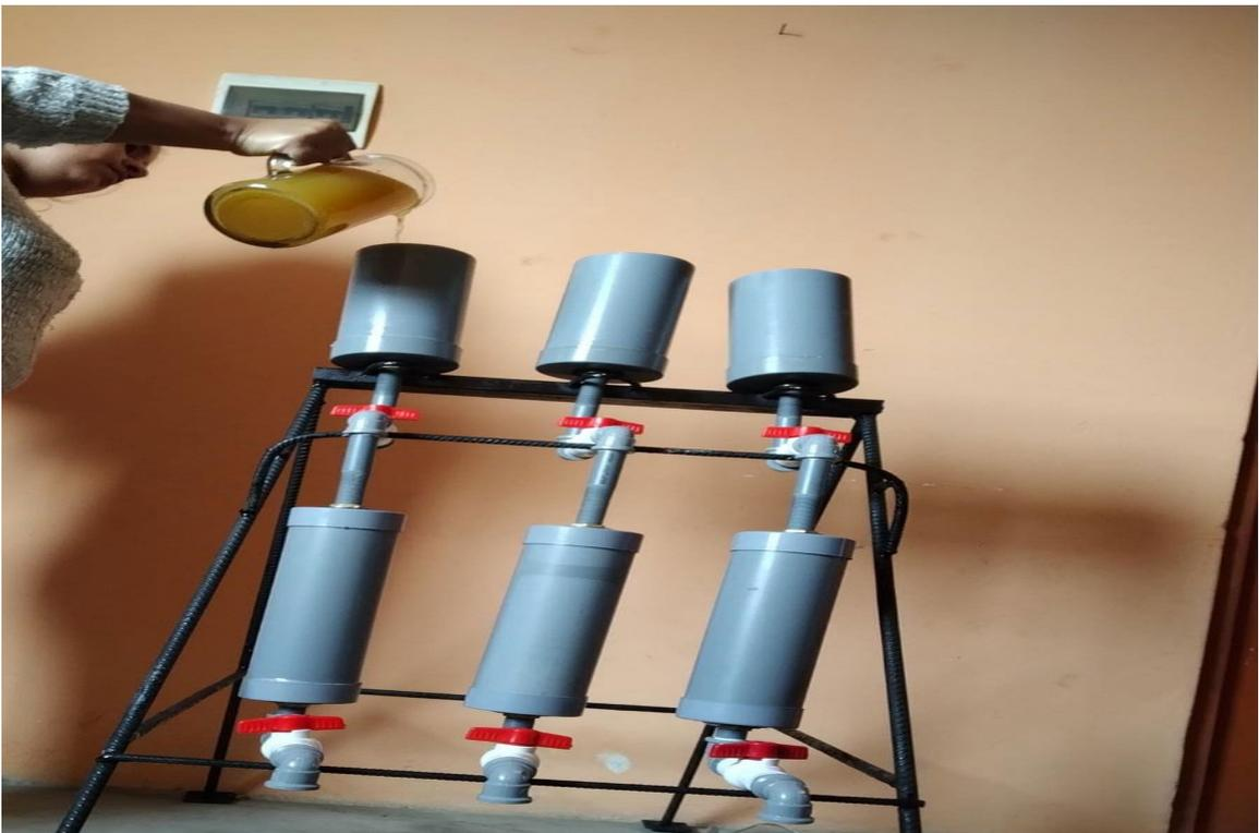
**Figura 41:** Luego se abrirán las llaves para el paso del agua de la muestra patrón y las dos experimentales las cuales se mezclarán con el carbón activado ya incorporado en el recipiente de PVC.
