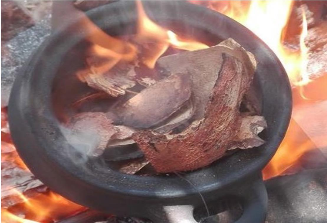
**Figura 24:** Cuando se carbonizaron y antes que el fuego consumiera los trozos de cáscara de coco, se colocaron en una bandeja de aluminio para rociarlas con agua desmineralizada hasta dejarlo en brasas.
