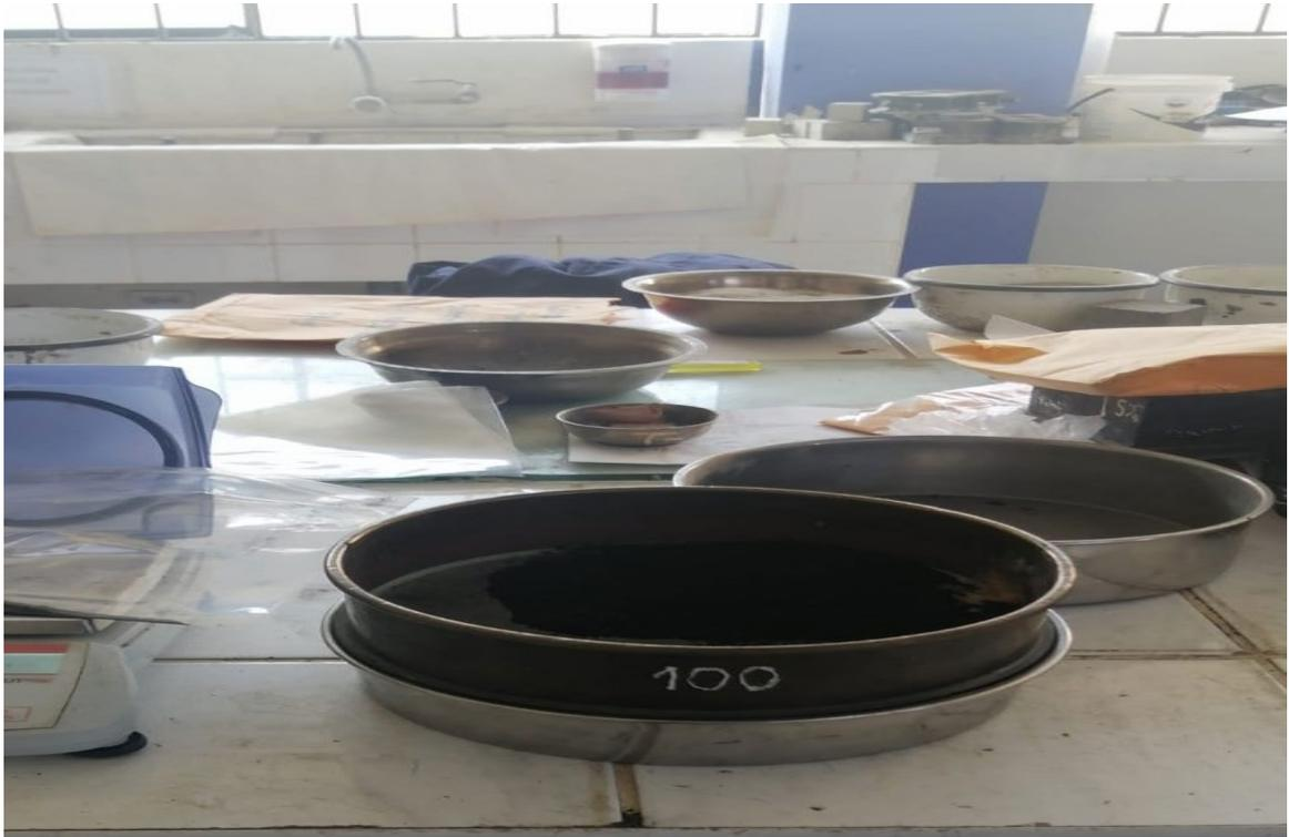
**Figura 30:** Se usó la malla N° 8 para obtener granos de carbón activado para la remoción de plomo.
