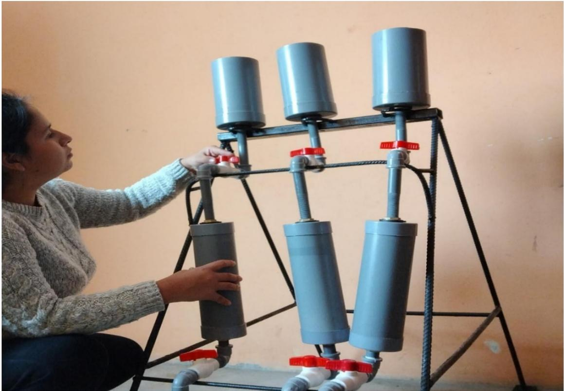
**Figura 42:** Se dejará en reposo por 60 minutos así el agua y el carbón activado tengan contacto para su proceso de adsorción.
