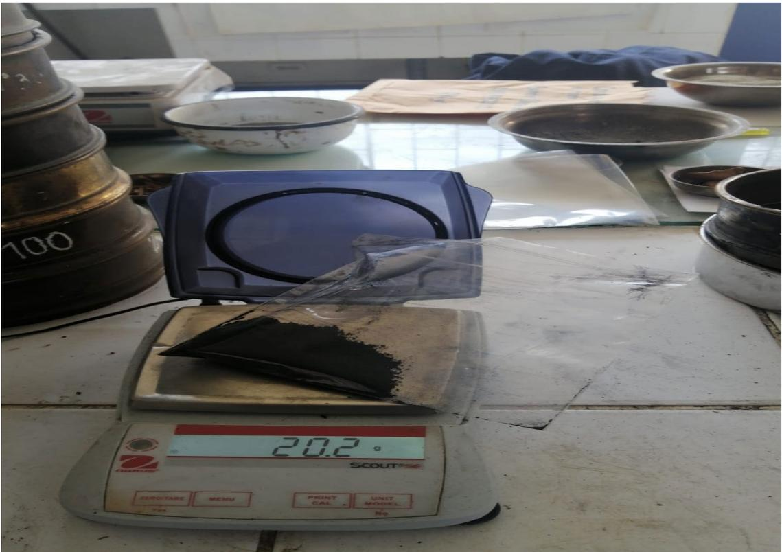
**Figura 29:** Se trituro en un mortero 20 gr de carbón activado en polvo pasado por el tamiz n°100 esto con el fin de determinar su análisis de fluorescencia de rayos X.
