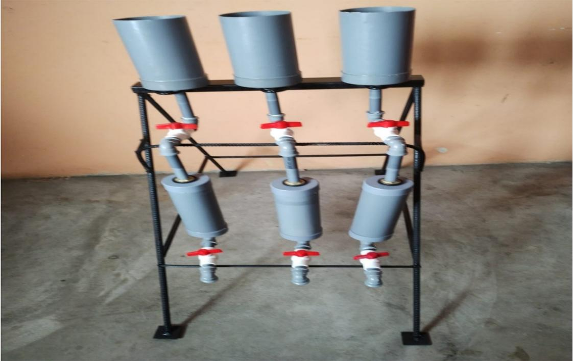
**Figura 40:** se utilizará 3 muestras de agua, una muestra patrón y dos experimentales que para cada unidad experimental se utilizó 1 L de agua de río moche -Otuzco, el cual se colocara en los recipientes superiores.
