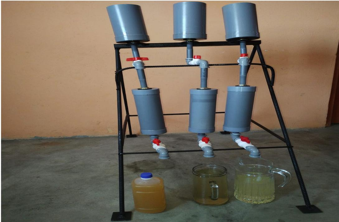
**Figura 44:** Por último, se llenará las 3 muestras de agua una 1 muestra patrón (agua natural) y 2 muestras procesadas con carbón activado para ser analizadas en el laboratorio COLECBI S.A.C.
