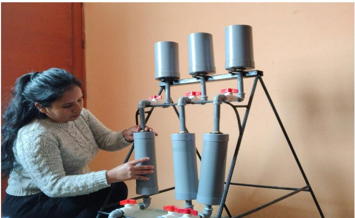
**Figura 43:** Pasado los 60 minutos se abrirán las llaves de paso que se encuentran debajo de cada uno de los recipientes el cual el agua será depositada en 3 jarras de un litro cada uno.
