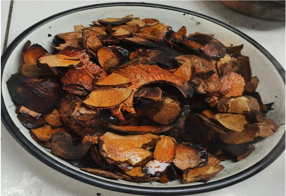
**Figura 26:** Para obtener el carbón activado se colocó en una mufla a una temperatura de 500°C por una hora.
