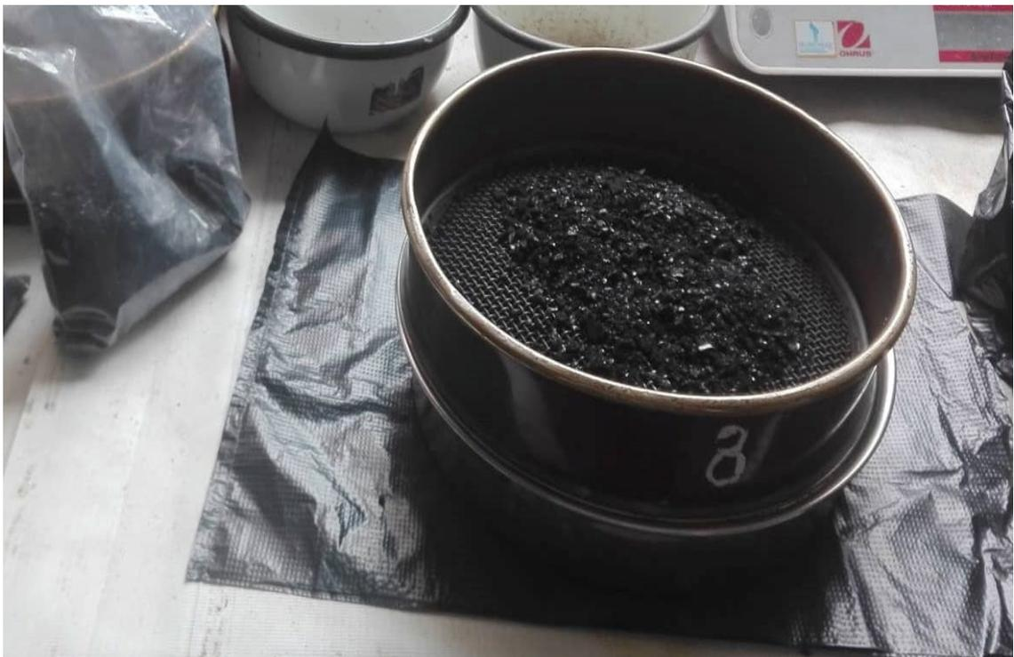
**Figura 31:** Obtuvimos los granos de carbón activado para su lavado y eliminar partículas contaminantes y excedentes, con agua destilada para su eliminación de partículas contaminantes.
