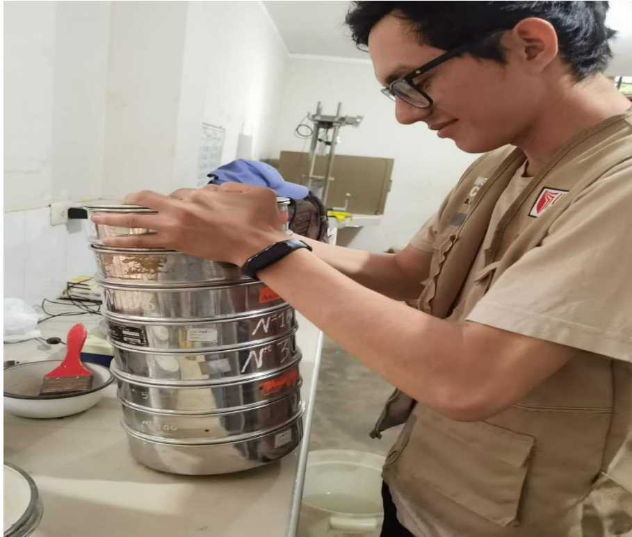
Foto N° 13: Ensayo de granulometría del agregado por parte del autor.
