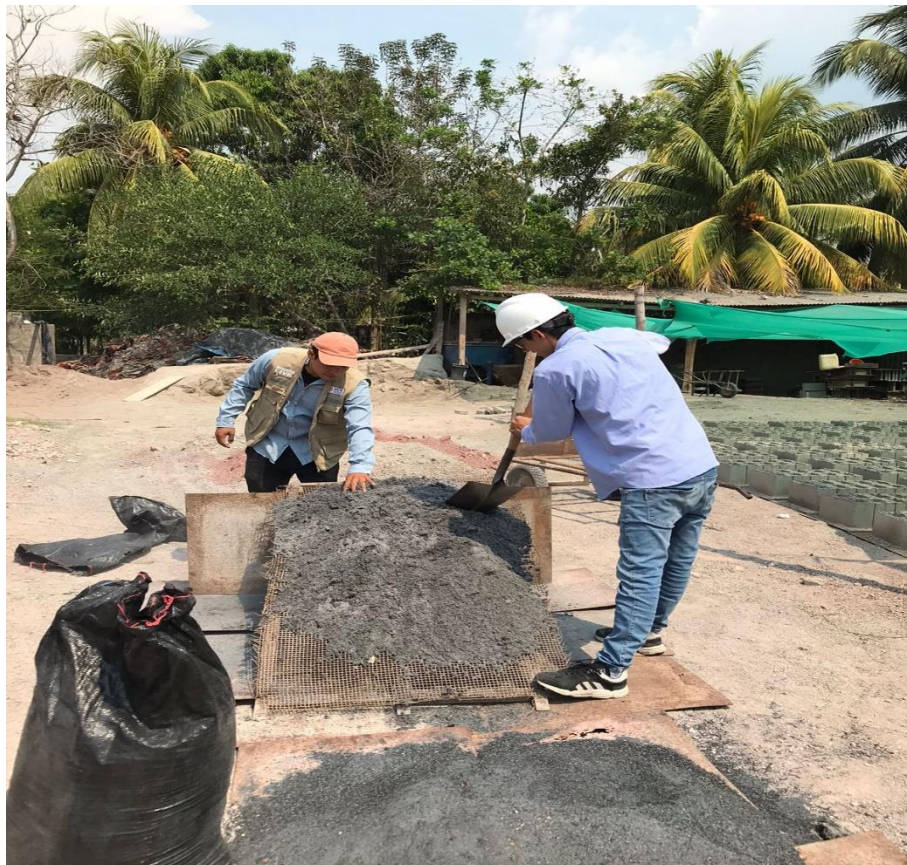
Foto N° 04: Proceso de limpieza de la ceniza de cascarilla de arroz por parte de los autores.
