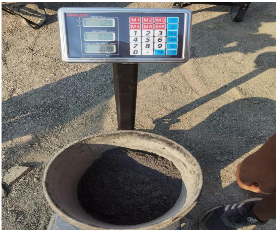
Foto N° 16: Se peso la ceniza de cascarilla de arroz para la elaboración de los adoquines.
