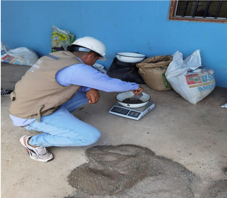
Foto N° 11: Selección del agregado para los ensayos de peso específico.
