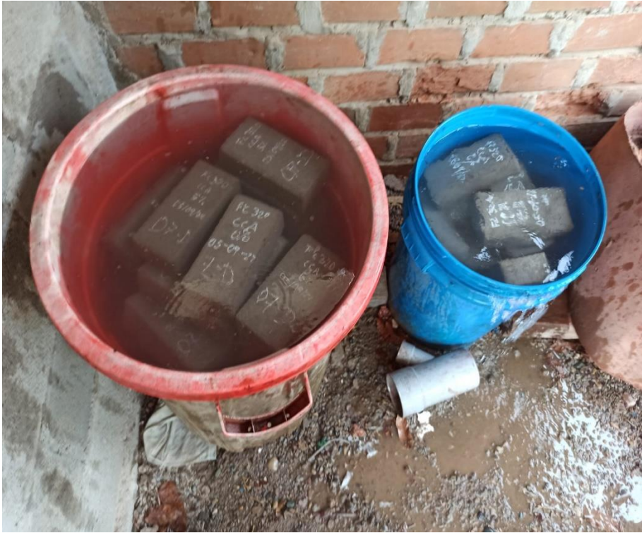
Foto N° 23: Adoquines puesto en agua para su correcto curado.
