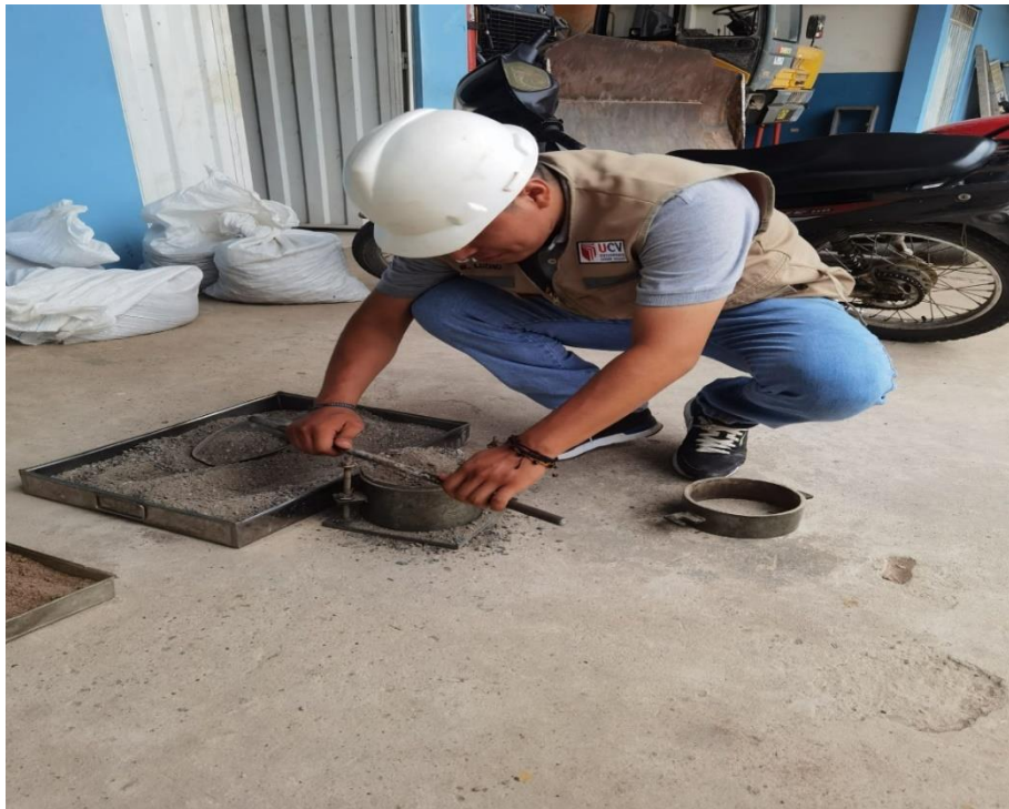
Foto N° 10: Enrasado del agregado para el ensayo de peso unitario.
