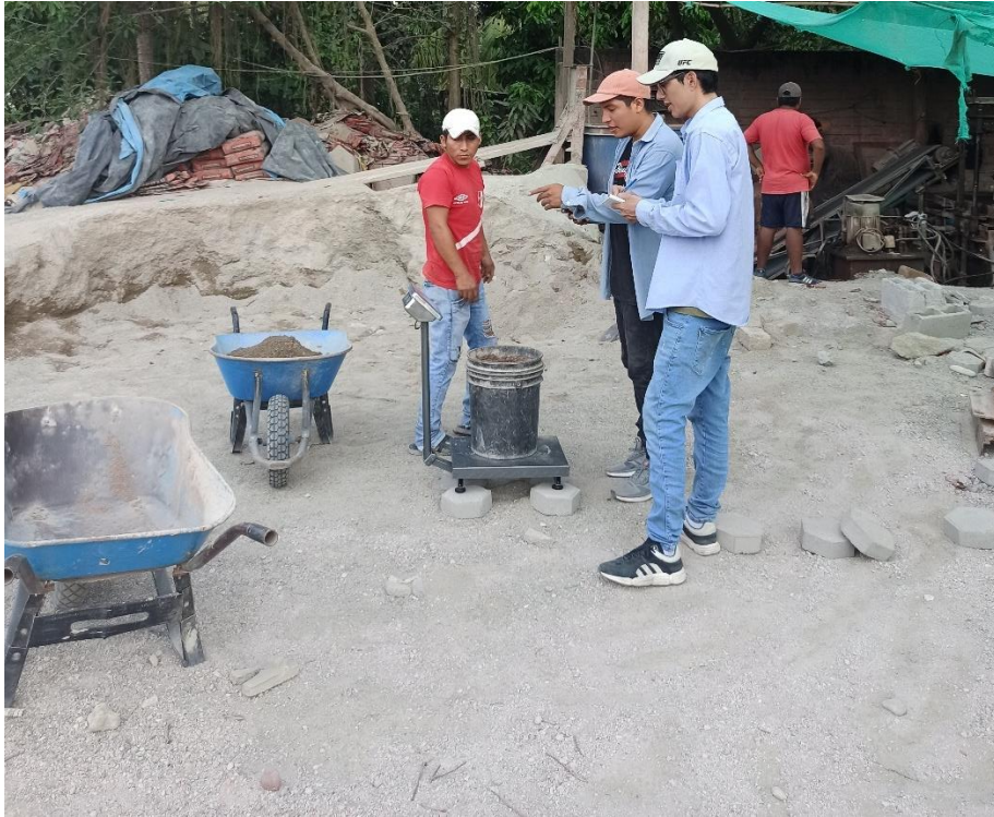
Foto N° 15: Se peso el agregado según diseño de mezcla para la elaboración de los adoquines.
