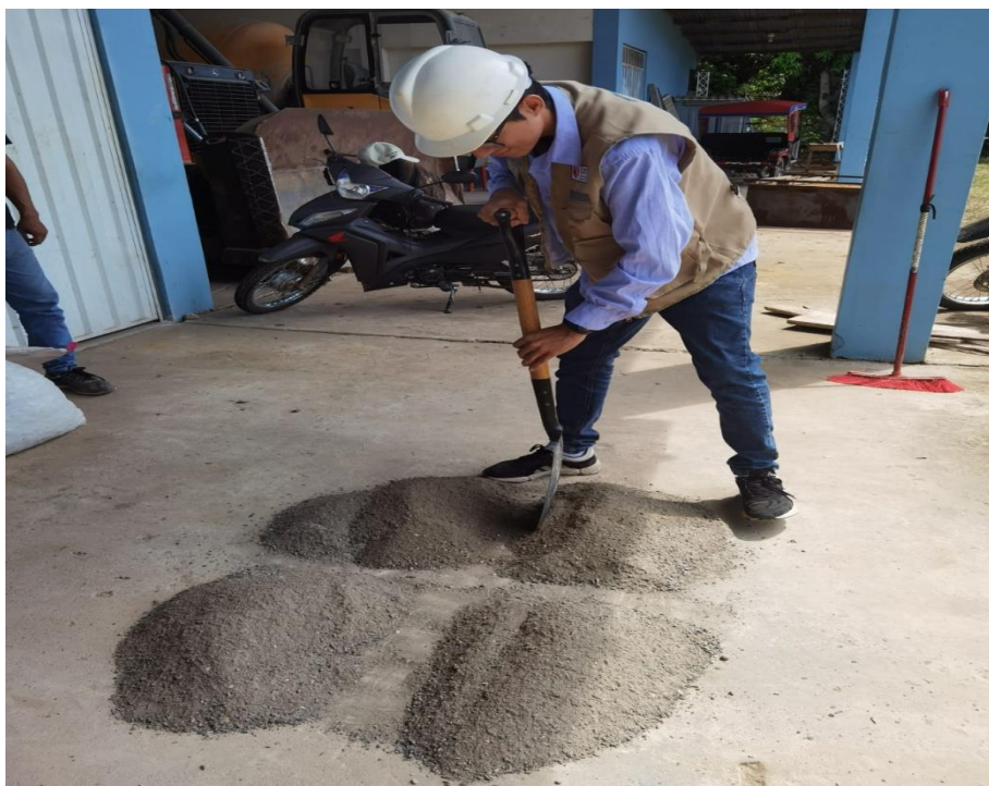
Foto N° 06: Método de cuarteo aplicado por el autor.
