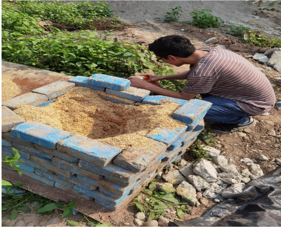
Foto N° 03: Proceso de combustión de la cascarilla de arroz realizada por el autor.
