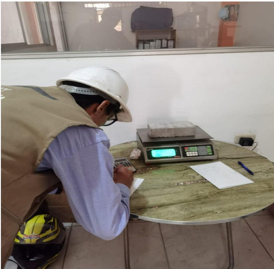
Foto N° 24: Autor pesando adoquín previo ensayo de rotura
