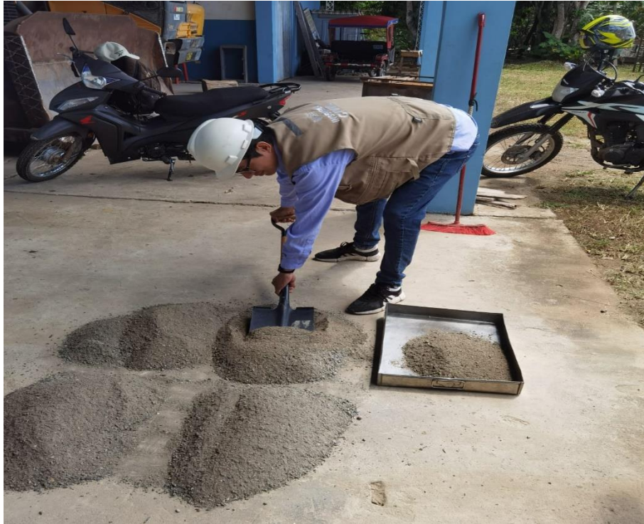
Foto N° 07: Muestra de agregado seleccionada por el autor para ser colocada en el horno.
