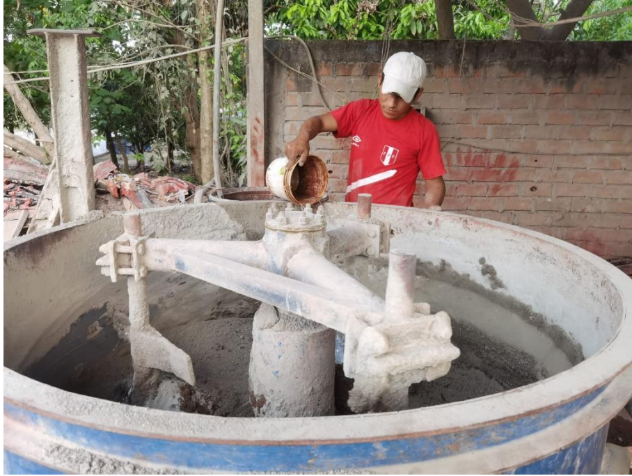
Foto N° 19: Se agrega agua según diseño de mezcla por parte del operador de la mezcladora.
