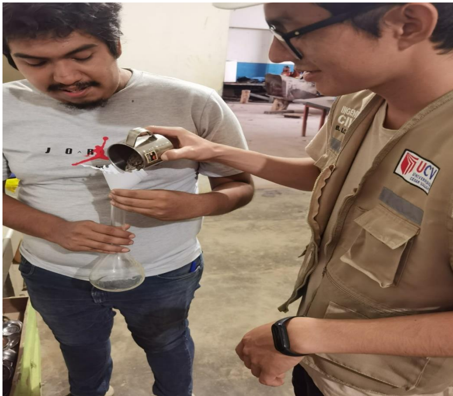
Foto N° 14: Ensayo de peso específico del agregado por parte del autor.
