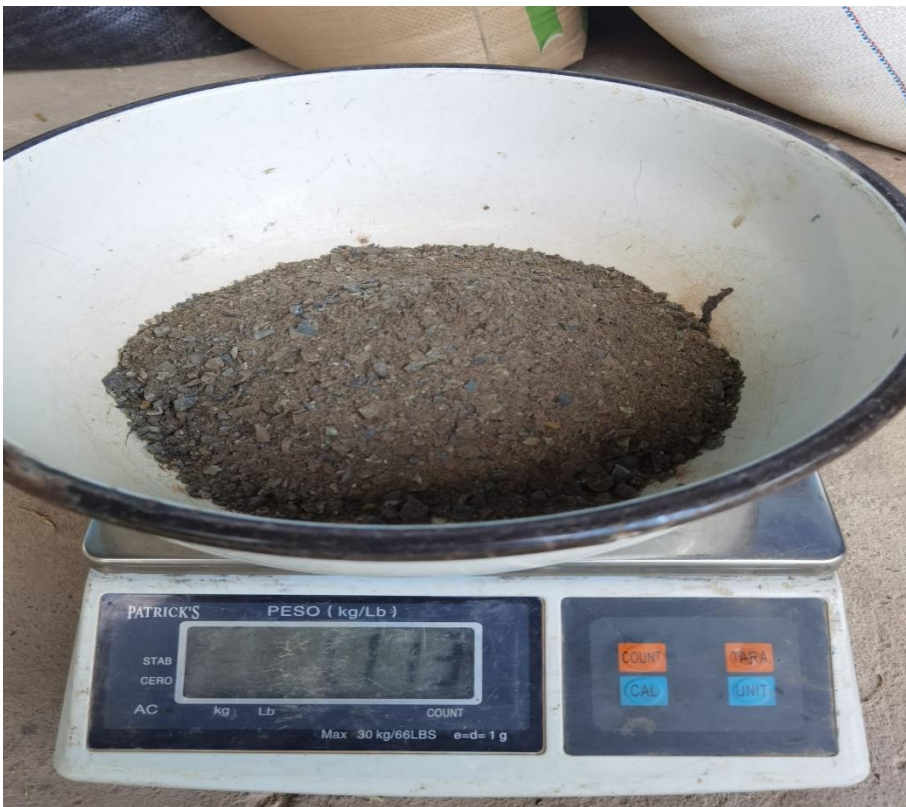
Foto N° 12: Muestra de agregado pesada para el ensayo de granulometría.
