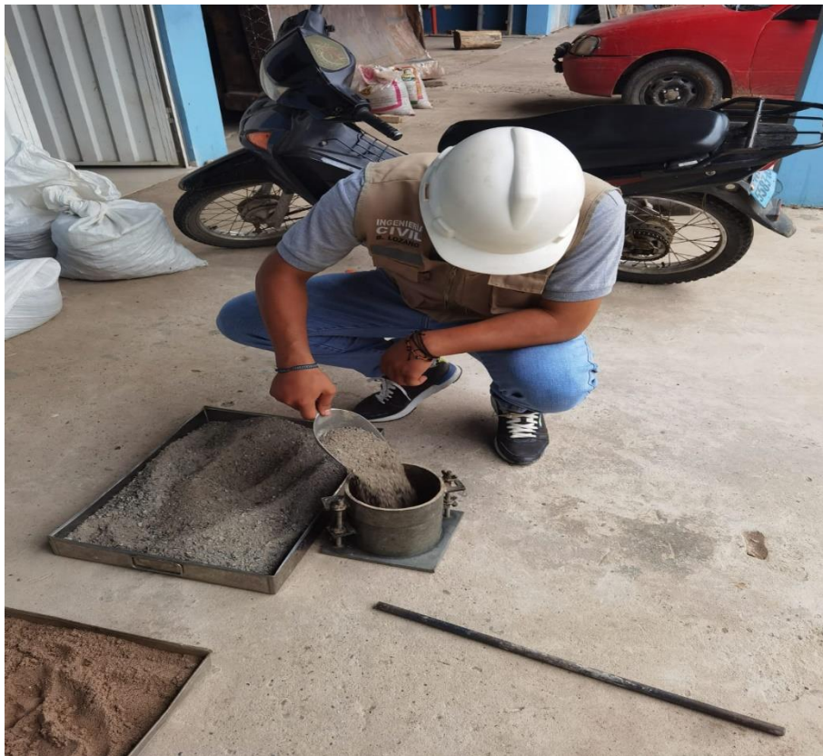
Foto N° 08: Ensayo de peso unitario suelto del agregado realizado por el autor.
