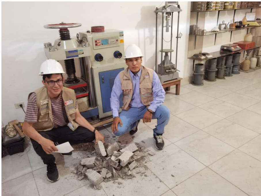
Foto N° 26: Resultado de resistencia a la compresión de los aduquines.
