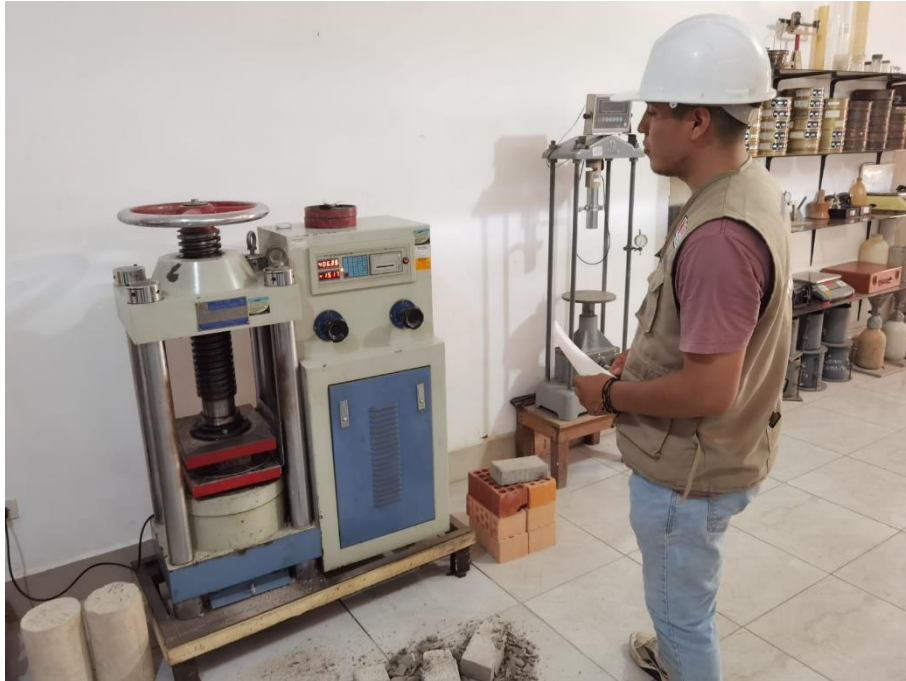
Foto N° 25: Rotura de aduquin presenciada por el autor.
