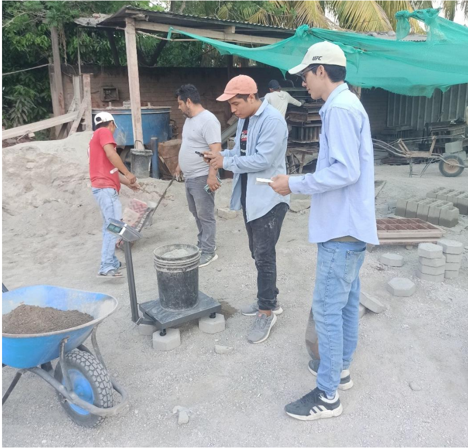
Foto N° 17: Se peso el cemento según diseño de mezcla para la elaboración de adoquines.
