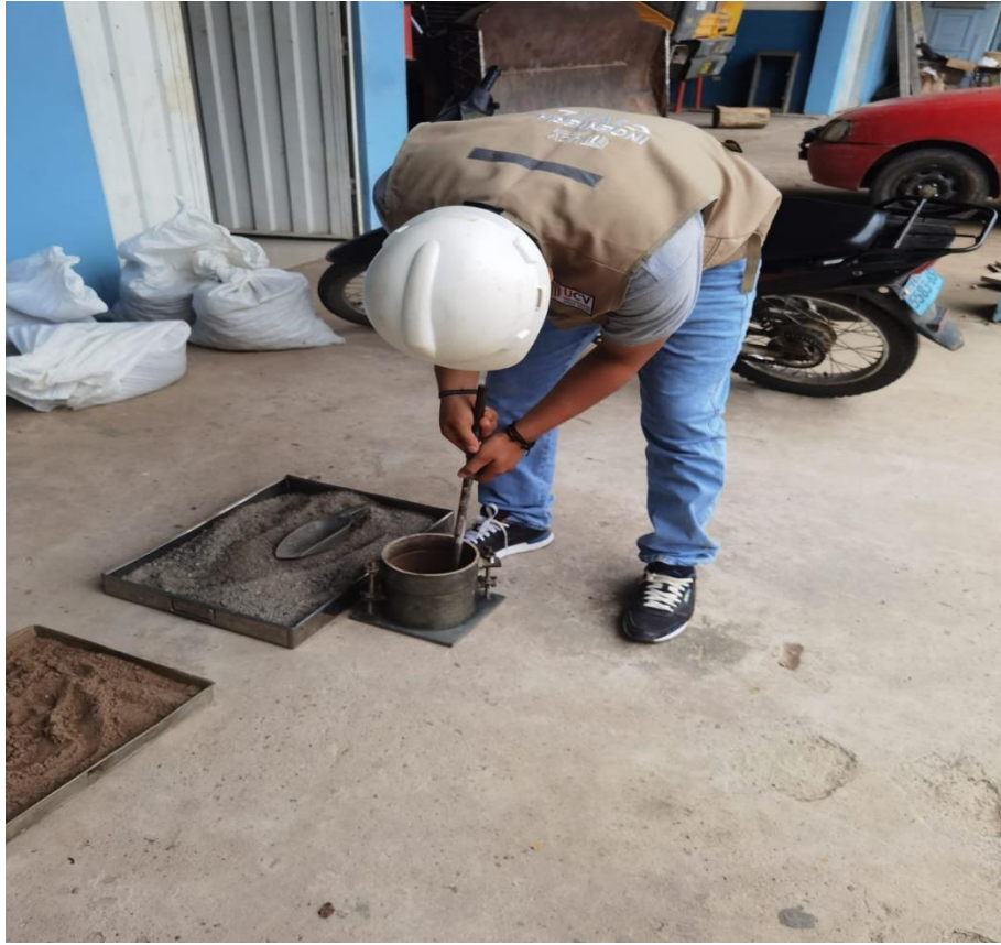
Foto N° 09: Ensayo de peso unitario varillado del agregado.
