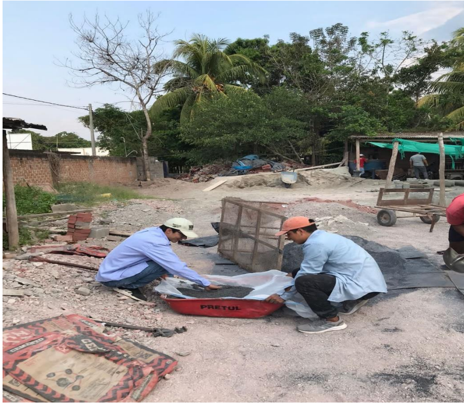
Foto N° 05: Zarandeo de la ceniza de cascarilla de arroz con malla N° 100 por parte de los autores.
