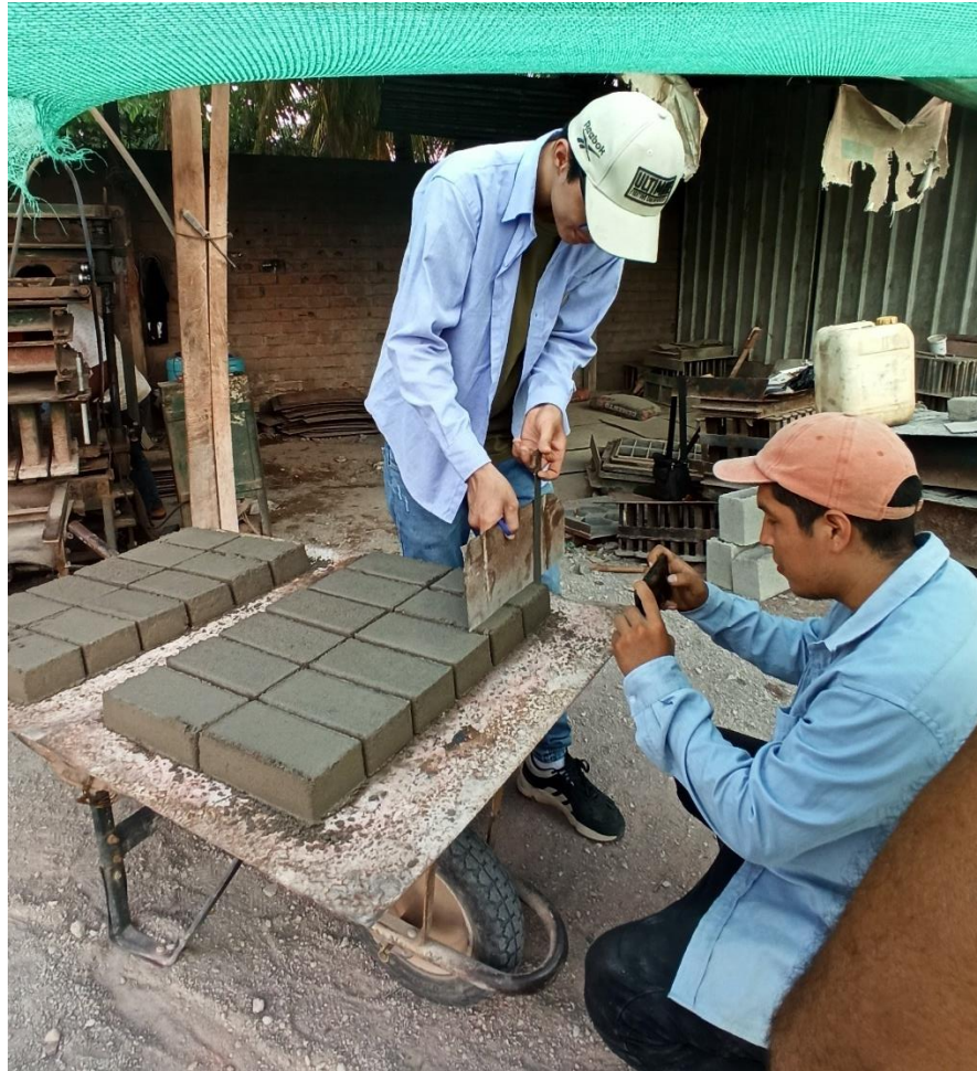
Foto N° 21: Control de medidas de adoquines según norma.
