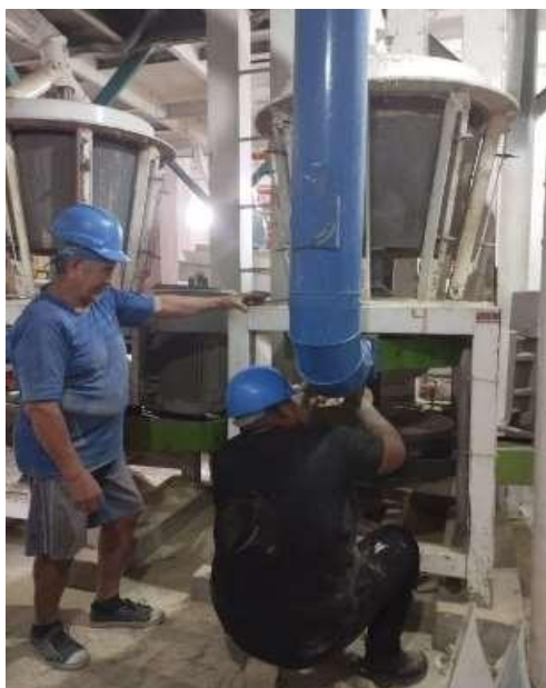
Figura 14 Mantenimiento de conos pulidores.
