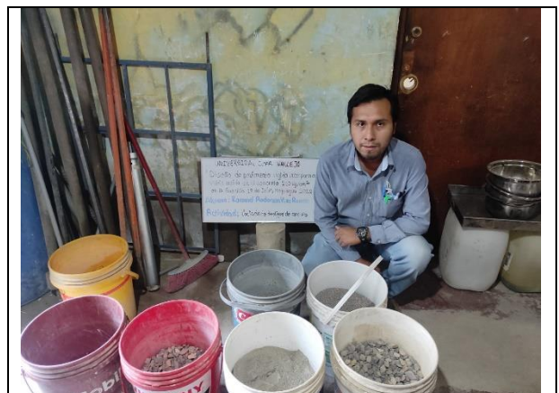
Figura N° 20. Materiales dosificados para el vaciado del concreto patrón
