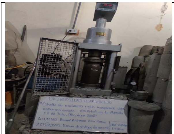
Figura N° 53. Rotura de testigos de concreto con sustitución del 10% de vidrio molido a los 14 días.
