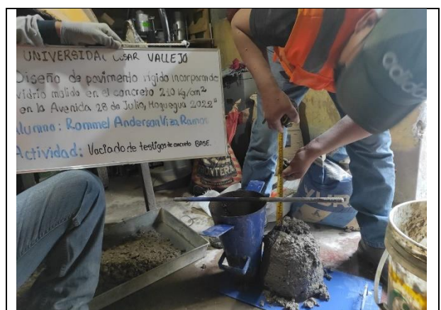
Figura N° 22. Realización del ensayo de asentamiento con el cono de Abrams para concreto patrón.
