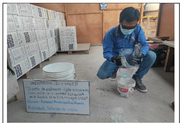
Figura N° 16. Separación de impurezas de vidrio.
