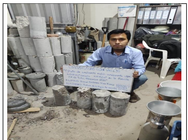
Figura N° 58. Post rotura de testigos de concreto patrón y sustitución del 5% de vidrio molido a los 14 días.
