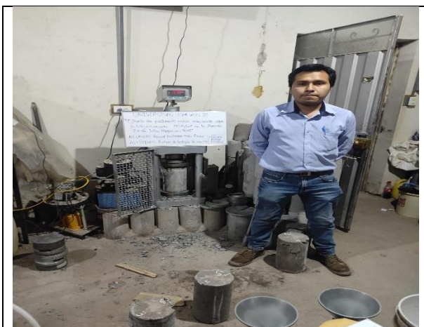
Figura N° 57. Post rotura de testigos de concreto patrón y sustitución del 5% de vidrio molido a los 14 días.
