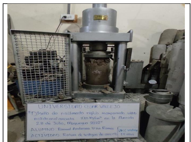
Figura N° 54. Rotura de testigos de concreto con sustitución del 15% de vidrio molido a los 14 días.
