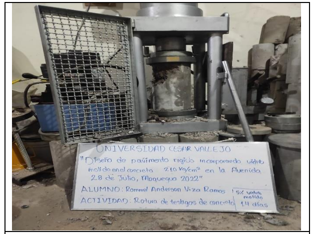
Figura N° 50. Rotura de testigos de concreto con sustitución del 5% de vidrio molido a los 14 días.
