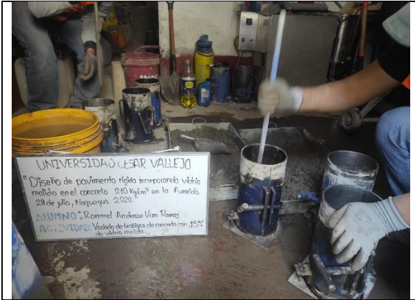
Figura N° 37. Elaboración de testigos de concreto para sustitución del 15% de vidrio molido.
