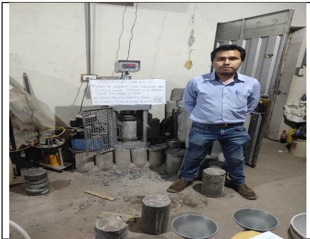
Figura N° 51. Post rotura de testigos de concreto patrón y sustitución del 5% de vidrio molido a los 14 días.
