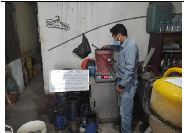
Figura N° 19. Dosificación de materiales para vaciado de testigos de concreto patrón.
