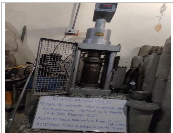
Figura N° 59. Rotura de testigos de concreto con sustitución del 10% de vidrio molido a los 14 días.
