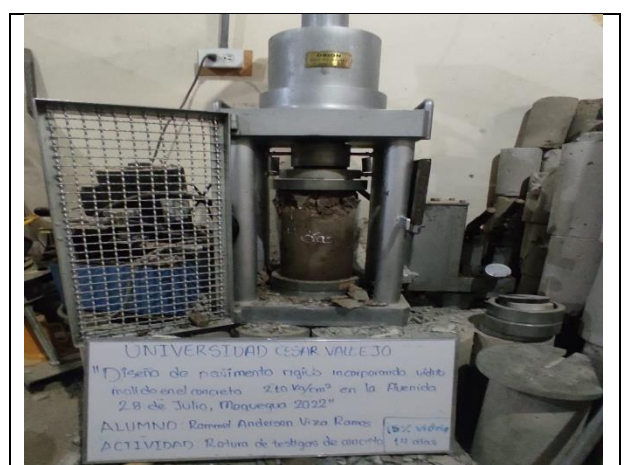
Figura N° 60. Rotura de testigos de concreto con sustitución del 15% de vidrio molido a los 14 días.
