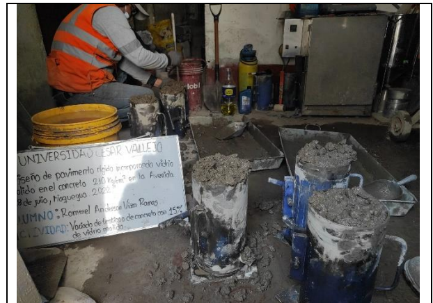
Figura N° 38. Moldeo para testigos de concreto con sustitución del 15% de vidrio molido.
