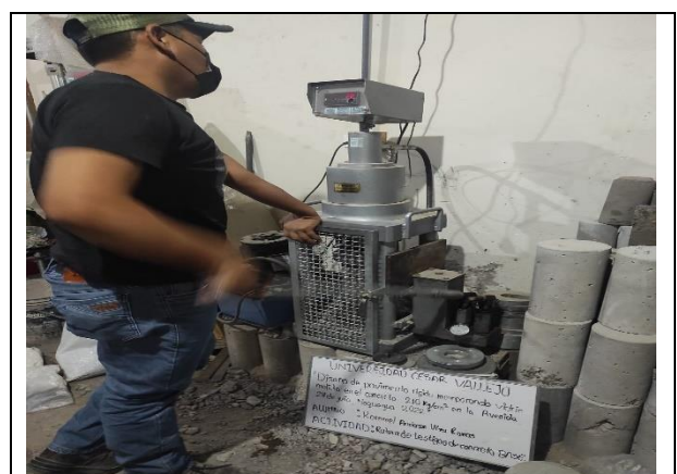
Figura N° 42. Inicio de rotura de testigos de concreto patrón a los 7 días.
