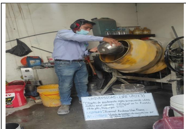
Figura N° 35. Preparación en mezcladora de concreto para sustitución de 15% de vidrio molido.
