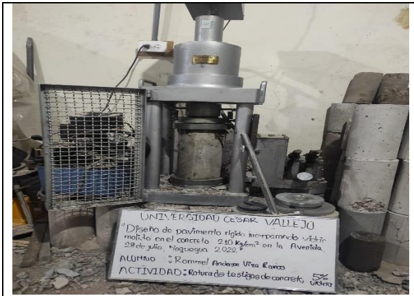
Figura N° 43. Rotura de testigos de concreto con sustitución del 5% de vidrio a los 7 días.
