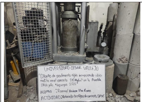
Figura N° 41. Rotura de testigos de concreto patrón a los 7 días
