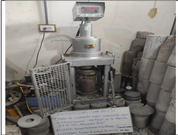
Figura N° 55. Rotura de testigos de concreto con
