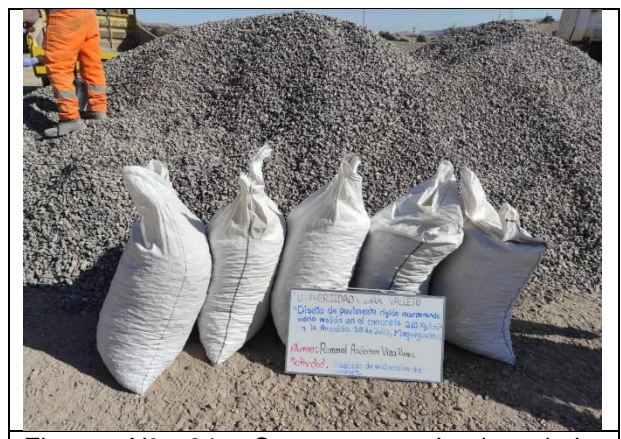
Figura N° 04. Sacos conteniendo piedra chancada de 1/2" y 3/4".
