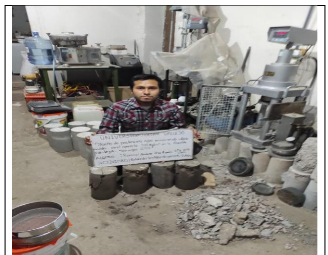
Figura N° 48. Post rotura de los testigos de concreto con sustitución del 10% y 15% de vidrio molido.
