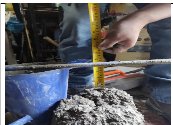
Figura N° 23. Medición del asentamiento para el concreto patrón.
