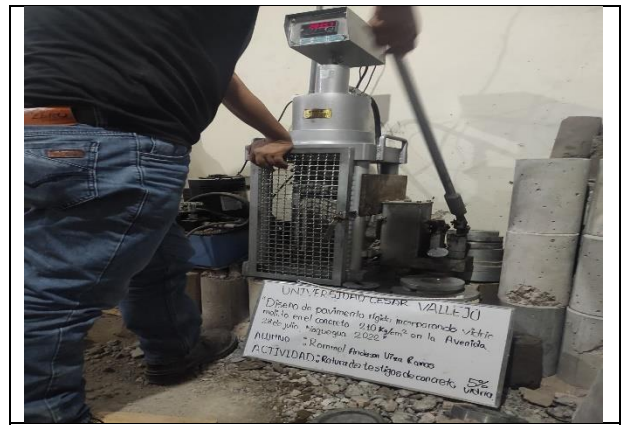
Figura N° 44. Inicio de rotura de testigos de concreto con sustitución del 5% de vidrio molido a los 7 días.
