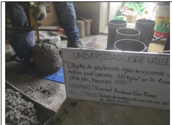
Figura N° 33. Medición del asentamiento para el concreto con sustitución porcentual del 10% de vidrio molido..
