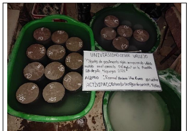
Figura N° 40. Curado de testigos de concreto.
