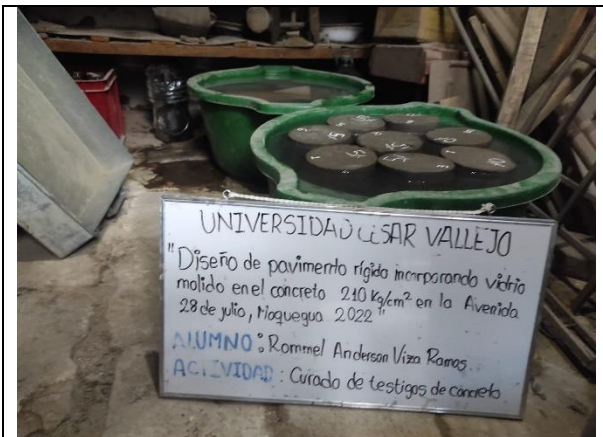
Figura N° 39. Curado de testigos de concreto.
