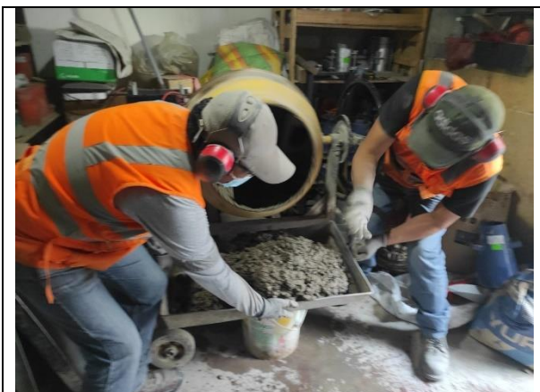
Figura N° 21. Colocación en bandeja de concreto patrón.
