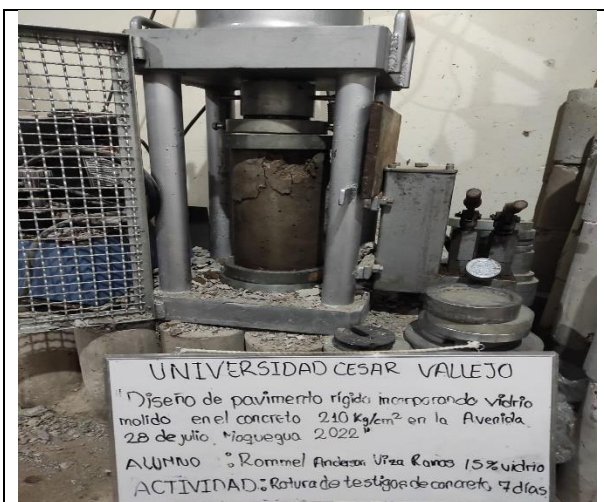
Figura N° 47. Rotura de testigos de concreto con sustitución del 15% de vidrio molido a los 7 días.
