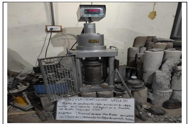
Figura N° 46. Rotura de testigo de concreto con sustitución del 10% de vidrio molido a los 7 días.
