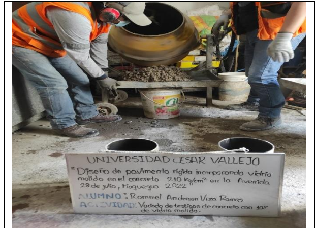
Figura N° 32. Vaciado en bandeja de concreto con sustitución del 10% de vidrio molido.
