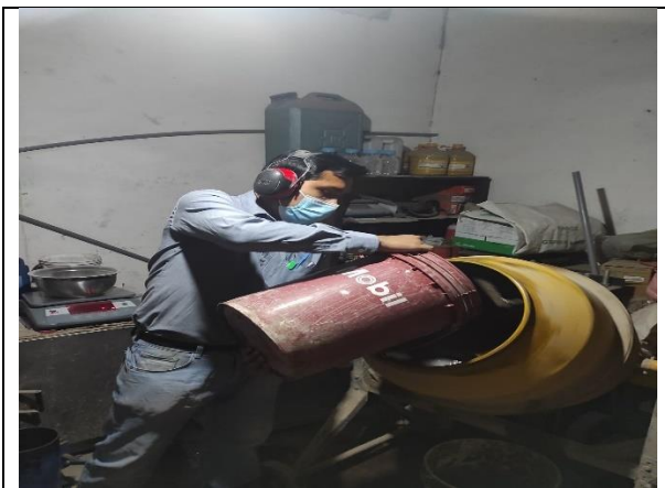
Figura N° 27. Preparación en mezcladora de concreto para sustitución de 5% de vidrio molido.
