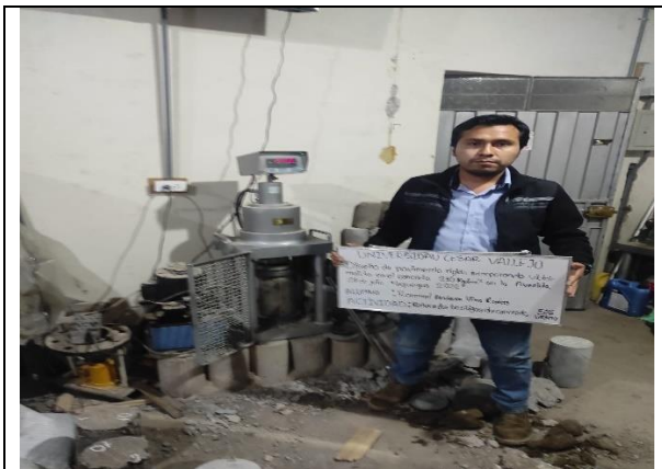
Figura N° 45. Post rotura de testigos de concreto patrón y sustitución del 5% de vidrio molido a los 7 días.
