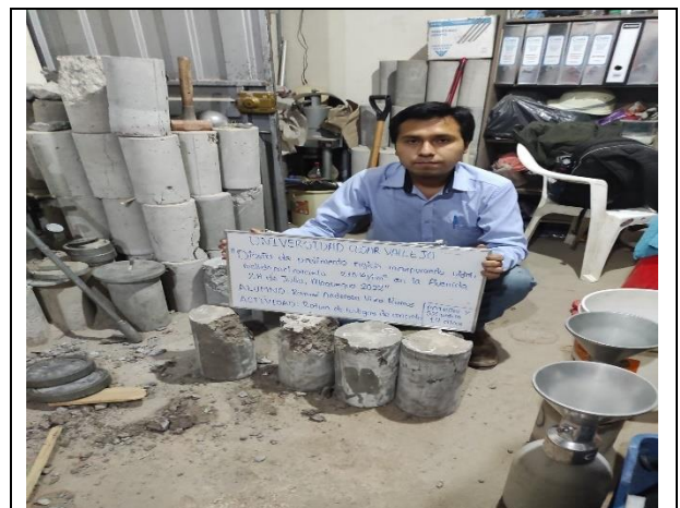
Figura N° 52. Post rotura de testigos de concreto patrón y sustitución del 5% de vidrio molido a los 14 días.
