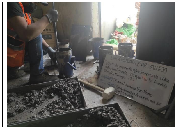
Figura N° 34. Elaboración de testigos de concreto para sustitución del 10% de vidrio molido.
