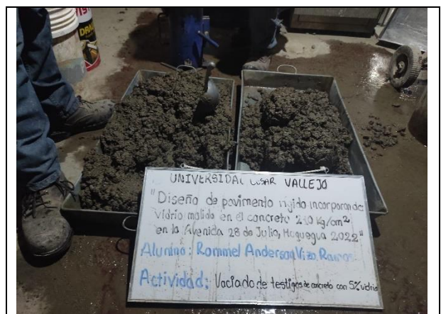
Figura N° 28. Colocación del concreto con 5% de vidrio molido en bandejas
