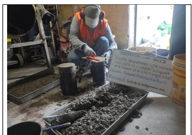
Figura N° 24. Elaboración de los testigos de concreto patrón.
