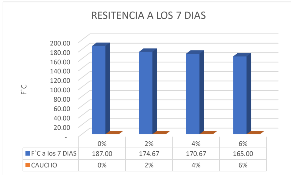
Figura 35 Resistencia sometido a compresión a 7 días del curado de las muestras.
