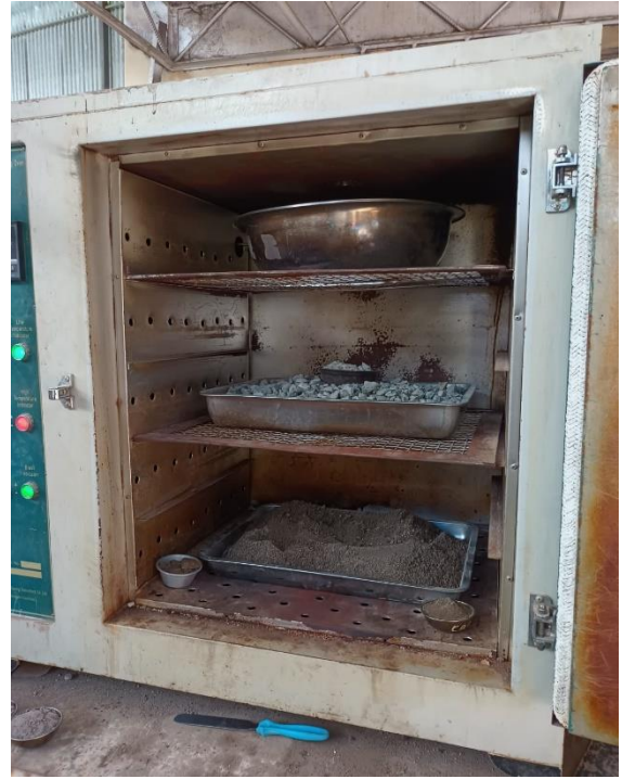
Figura 61. Ensayo de peso específico - secado.
