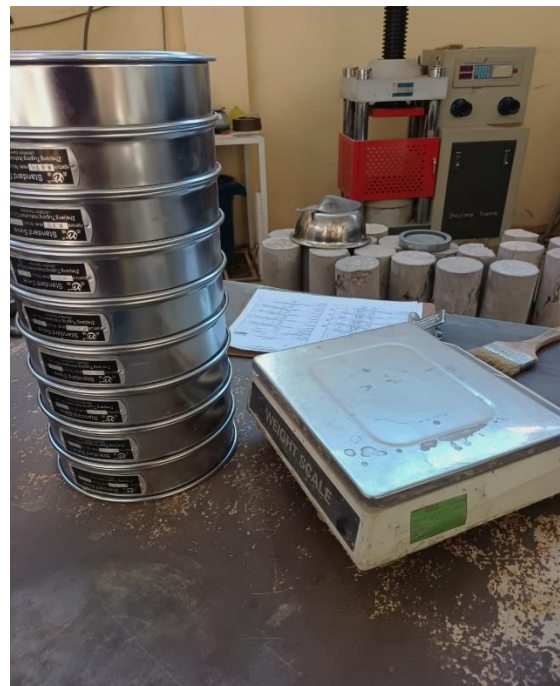
Figura 59. Mallas de tamizado en laboratorio.
