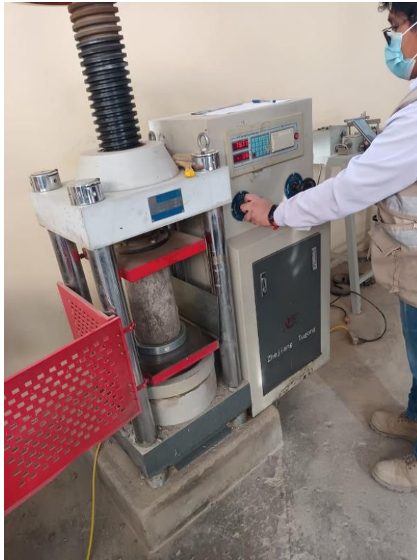
Figura 34. Ensayo de rotura de probeta.
