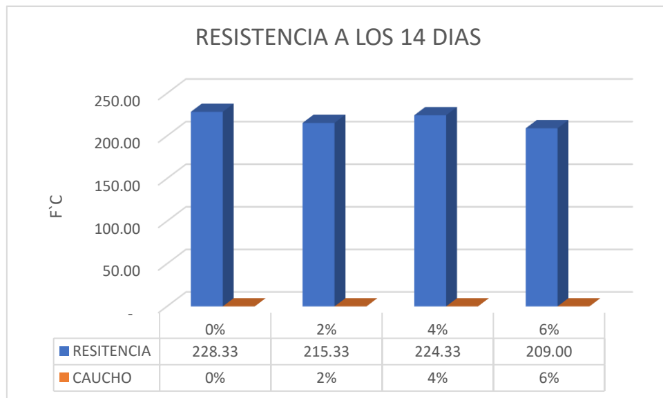
Figura 36. Resistencia del ensayo de compresión a 14 días del curado.
