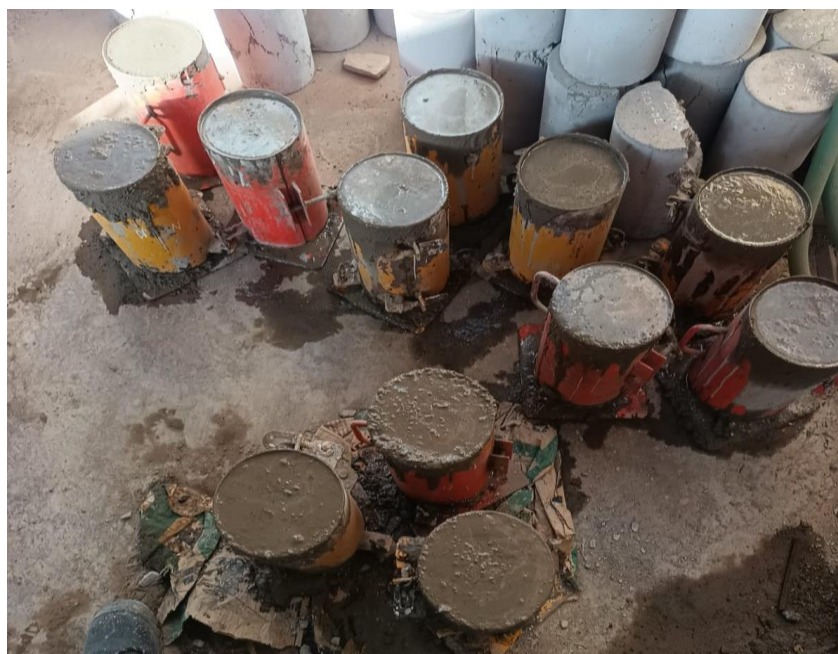
Figura 33. Vaciado de concreto en briquetas de 6"x12".
