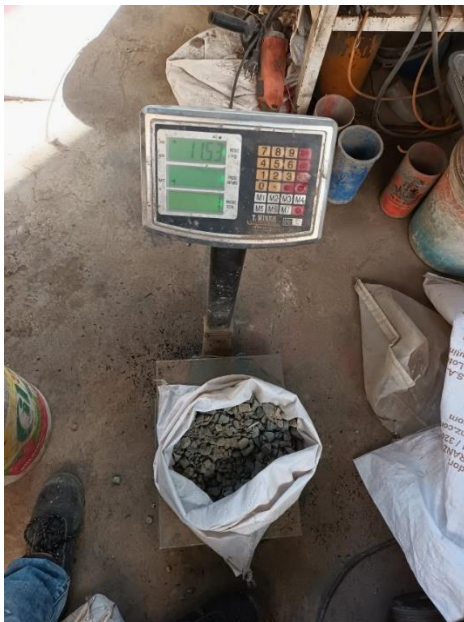
Figura 62. Verificación del peso del agregado grueso.
