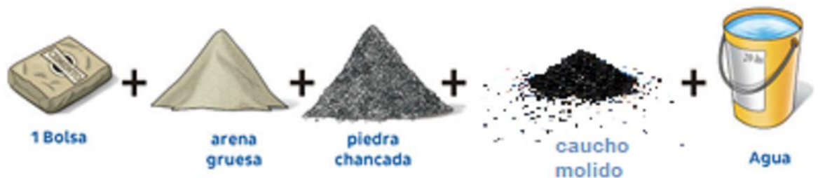
Figura 32. Preparación de la mezcla con las partículas de caucho reciclado.
