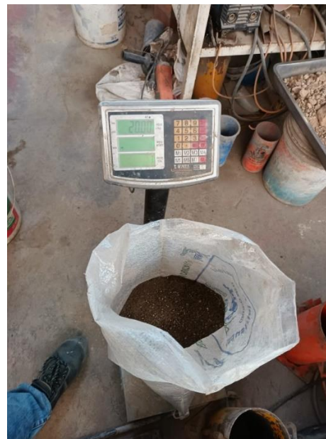
Figura 63. Verificación del peso del agregado fino.
