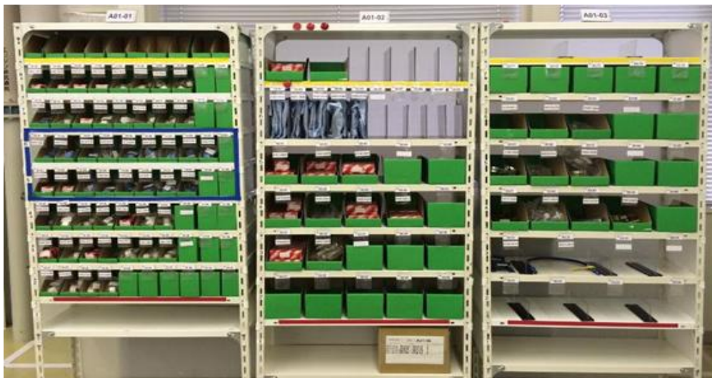
FIGURA 13.Estantería de almacén de la empresa Autonort Nor Oriente S.A.C después de aplicar 5s.
