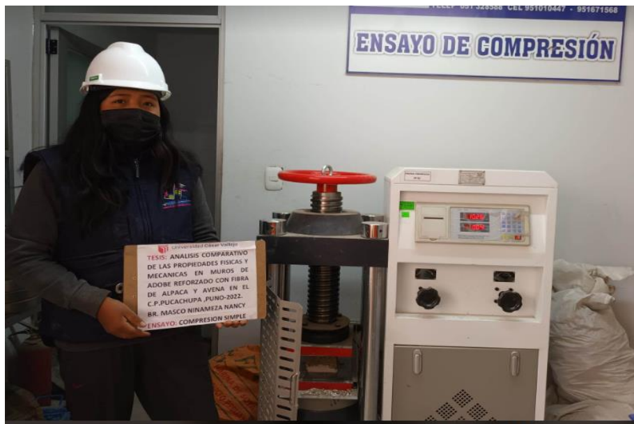
Fotografía 16. Ensayo de compresión simple en cubos.
