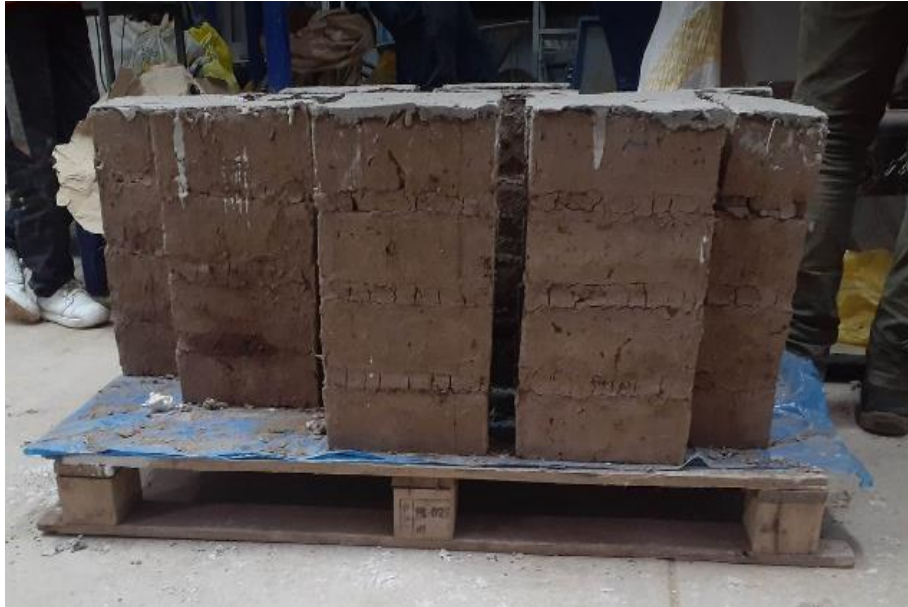
Fotografía 17. Capeo de las superficies en pilas
