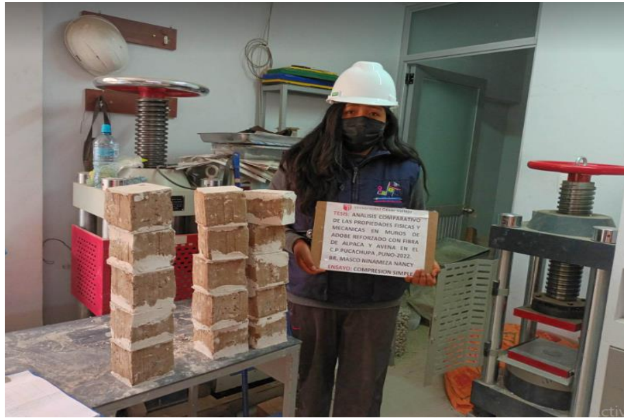
Fotografía 15. Capeo de las superficies en cubos
