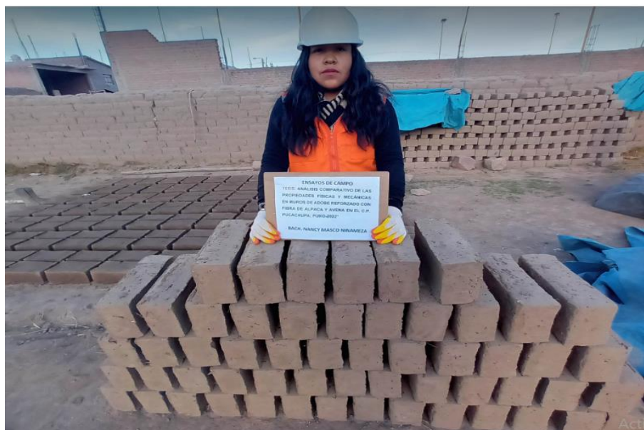
Fotografía 13. Secado de los adobes.
