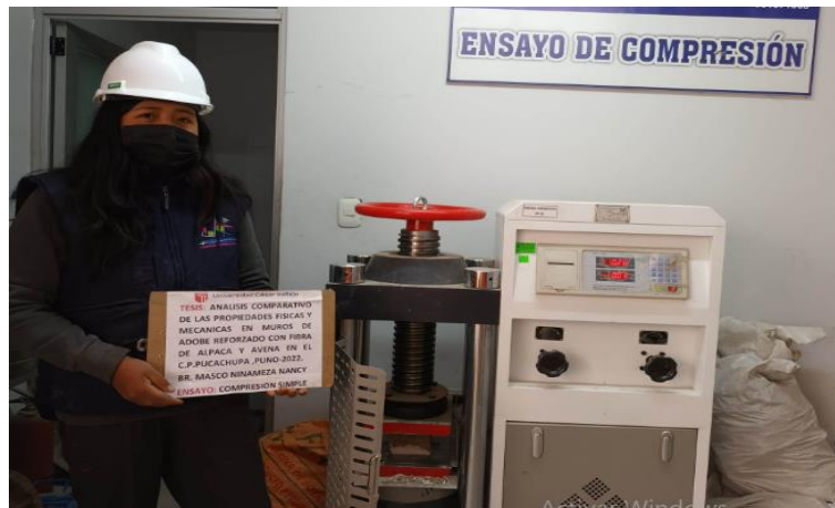
Figura 51. Ensayo de resistencia a la Compresión (10cm*10cm*10cm).
