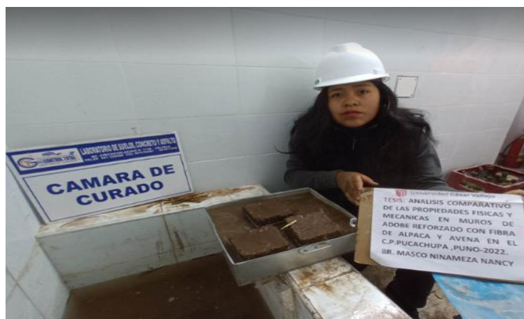
Figura 50. Ensayo de Absorción del adobe.
