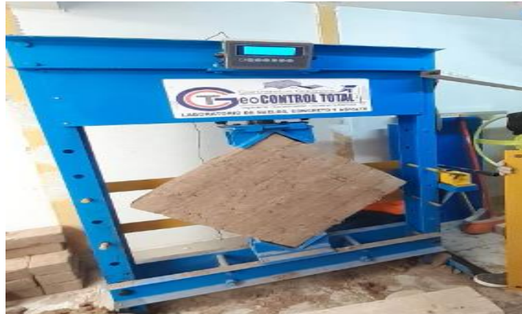
Figura 55. Ensayo a compresión diagonal
