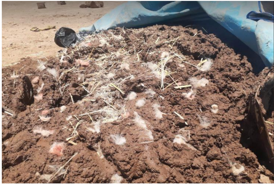
Fotografía 11. Mezcla de materiales (fibra de alpaca y paca de avena).
