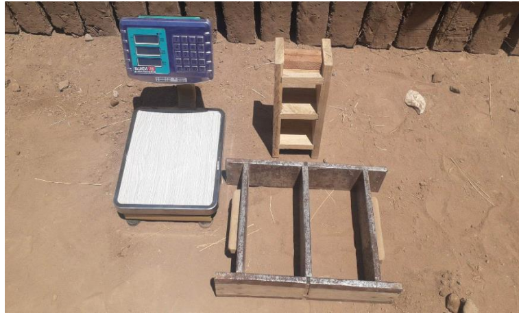
Figura 31. Peso de los moldes.
