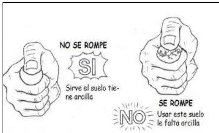
Figura 14. Prueba de presencia de arcilla
