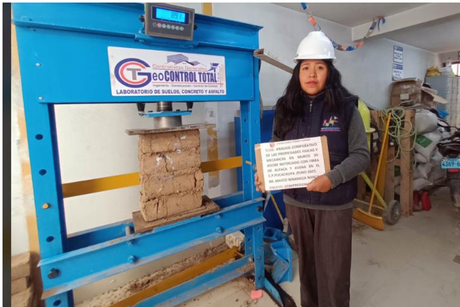
Fotografía 18. Ensayo de compresión axial en pilas.
