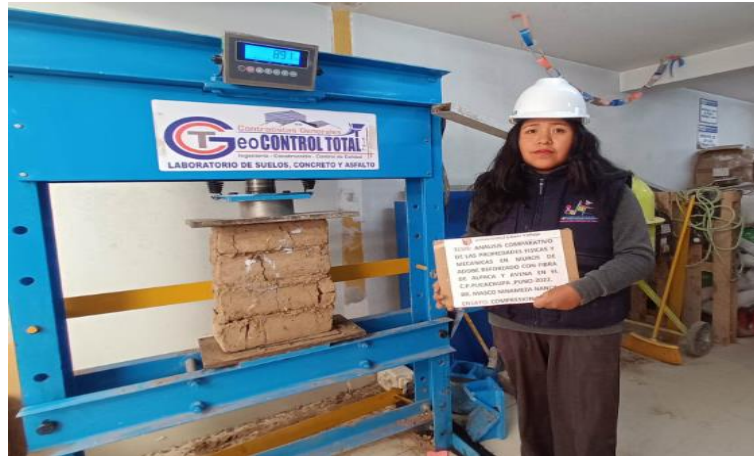
Figura 53. Ensayo de resistencia a la compresión en pilas de adobes
