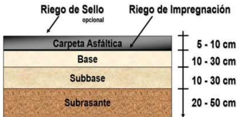
Figura 1. Estructura del pavimento flexible.
