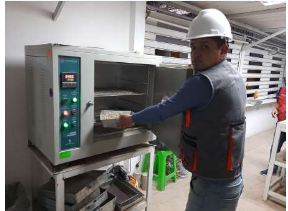
Figura 14. Determinación de la humedad.
