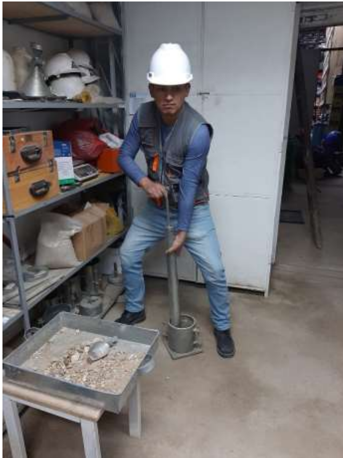
Figura 16. Determinación del CBR.
