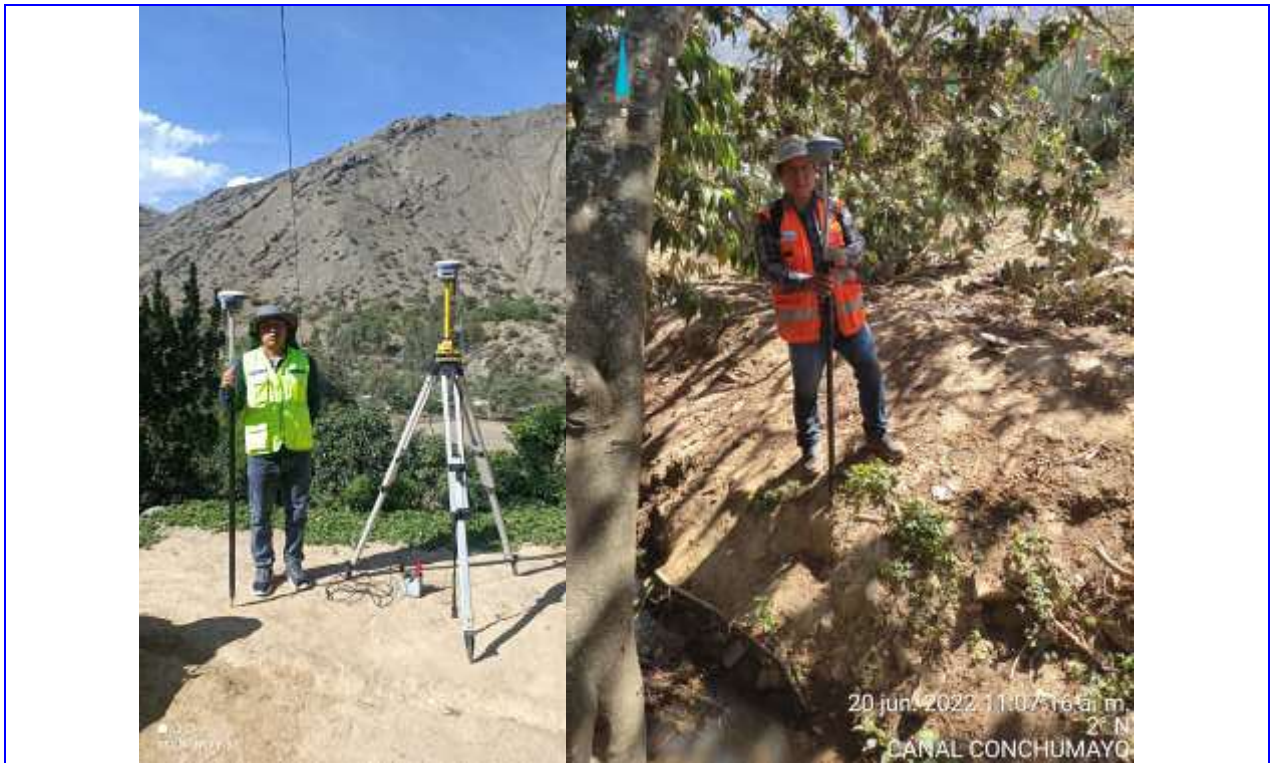
Foto N° 05. En la imagen izquierda se observa el equipo estación diferencial como base, en la imagen derecha se observa tomando los puntos topográficos del canal mediante RTK.
