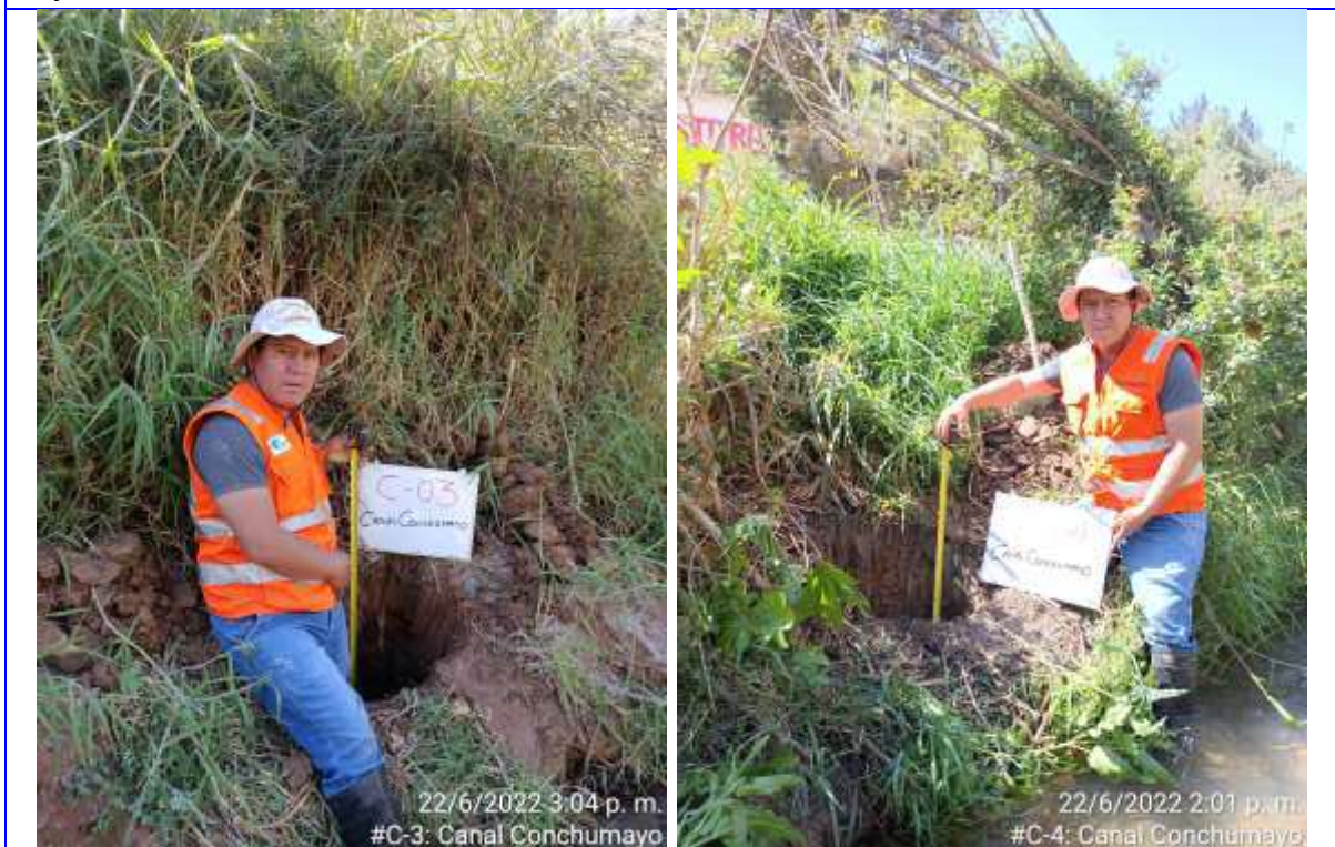
Foto N° 08: En las imágenes tanto izquierda como derecha se observan las calicatas 3 y 4 tomados en el canal.
