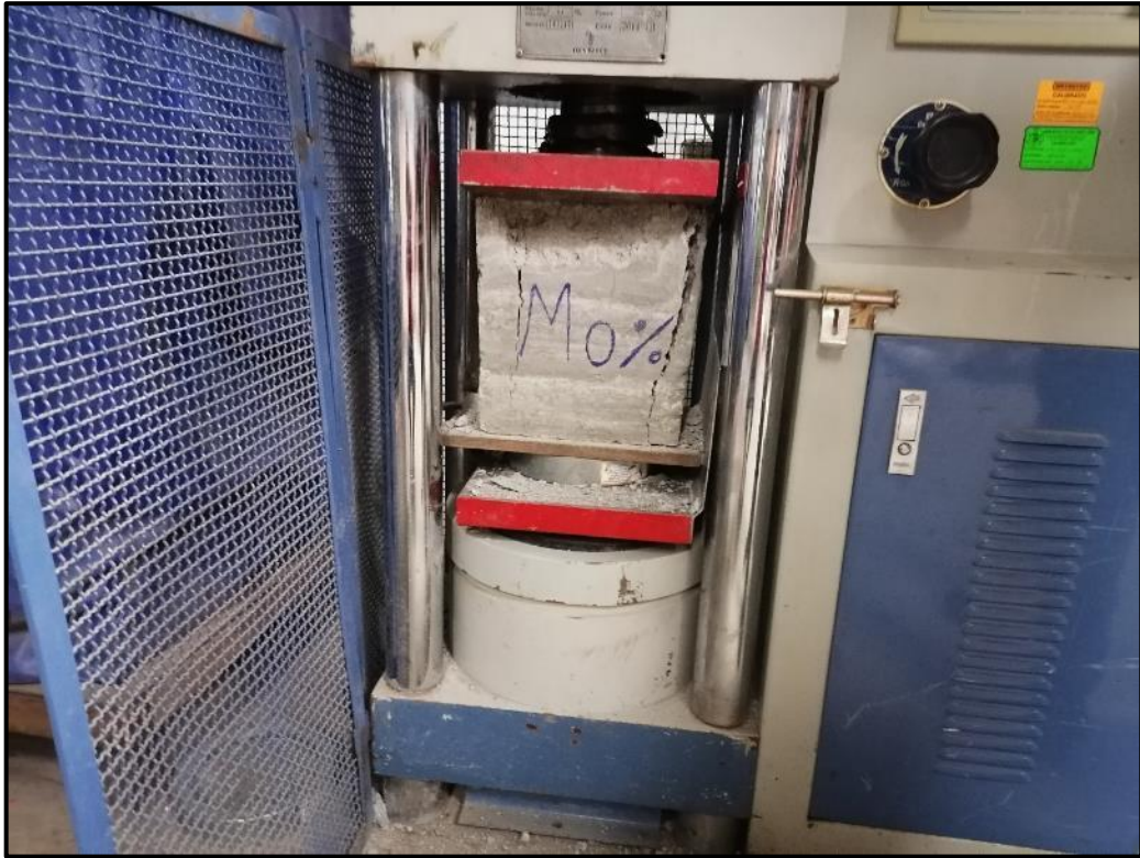
Gráfico 24 Ensayo de resistencia a la compresión de pilas de ladrillo patrón
