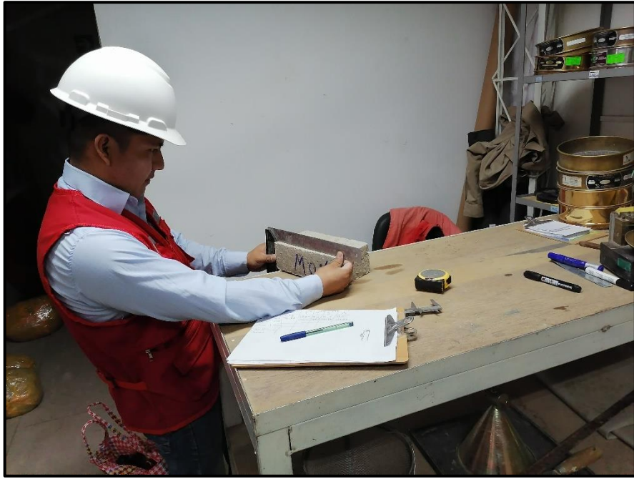
Gráfico 28 Determinación de la variación dimensional y alabeo de las unidades de ladrillos.
