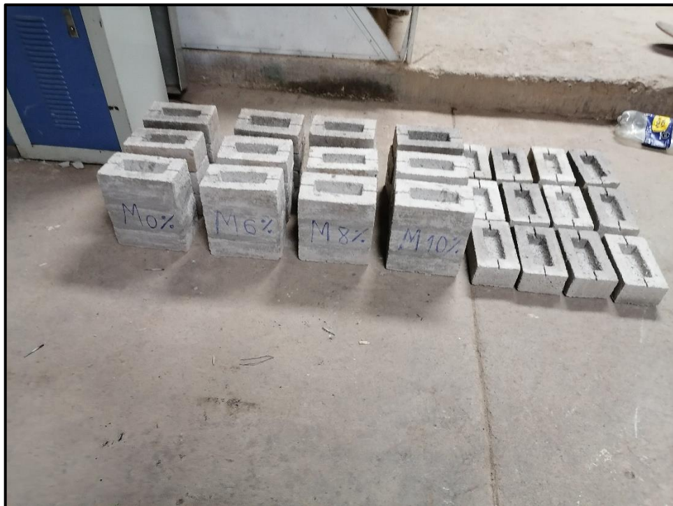
Gráfico 21 Pilas de ladrillos y unidades de albañilería de concreto
