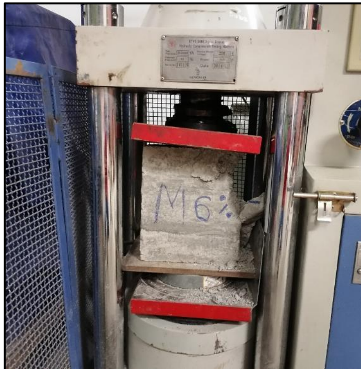
Gráfico 25 Ensayo de resistencia a la compresión de pilas de ladrillo con 6% de fibras de polietileno tereftalato (PET)
