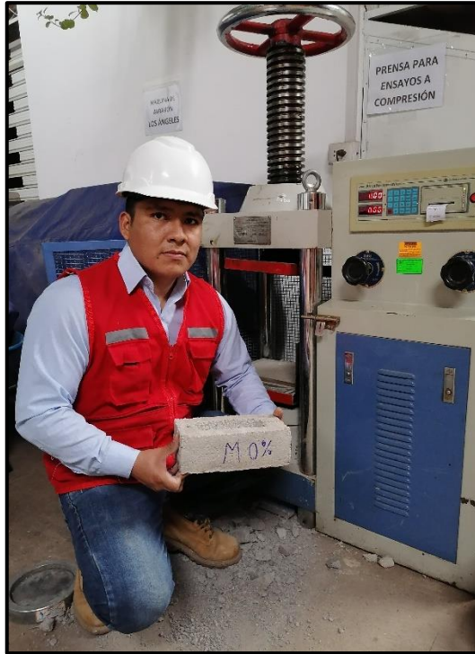
Gráfico 22 Ensayo de resistencia a la compresión de ladrillo patrón
