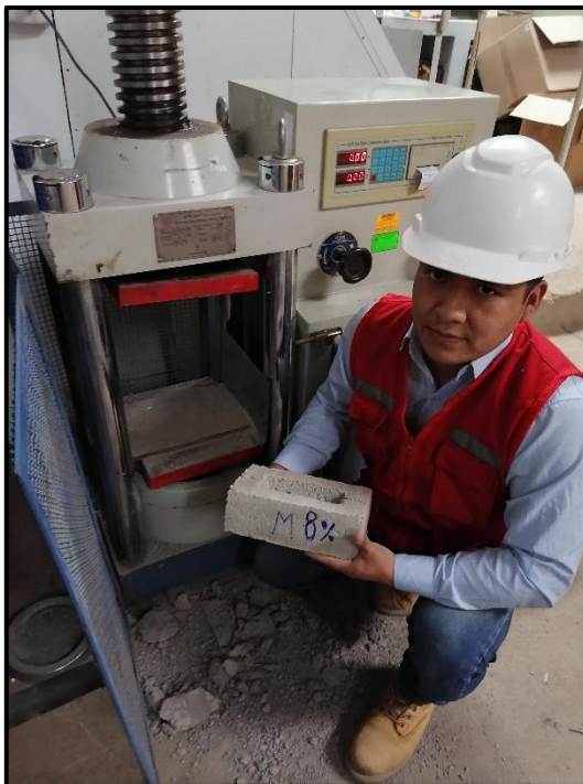
Gráfico 23 Ensayo de resistencia a la compresión de ladrillo con 8% de de polietileno tereftalato (PET)
