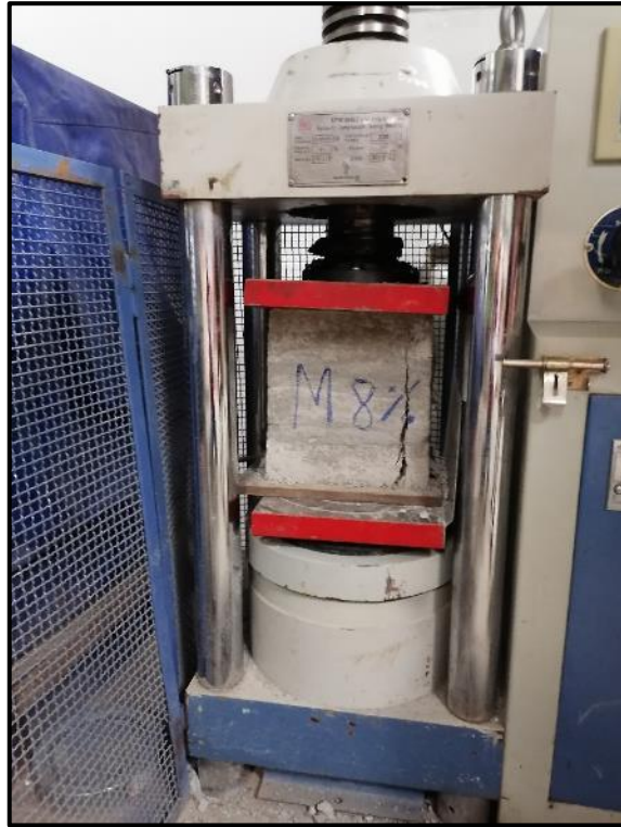
Gráfico 26 Ensayo de resistencia a la compresión de pilas de ladrillo con 8% de fibras de polietileno tereftalato (PET)
