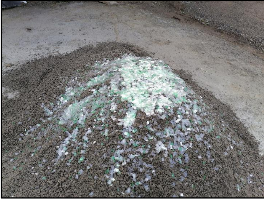
Gráfico 18 Adición de fibras de polietileno tereftalato (PET) a los agregados
