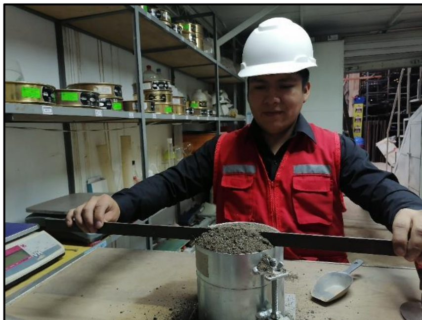
Gráfico 15 Regleado para eliminar material excedente en el ensayo
