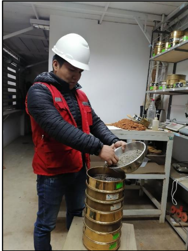
Gráfico 10 Tamizado de los agregados
