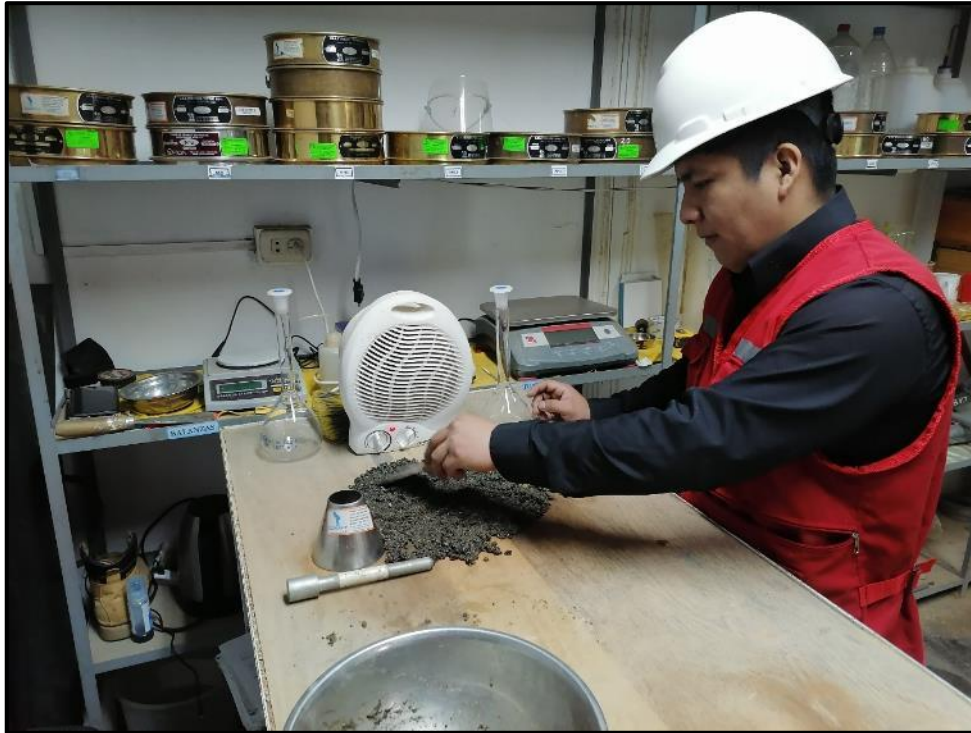
Gráfico 12 Ensayo de humedad superficial del agredo fino
