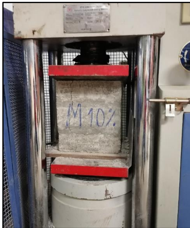
Gráfico 27 Ensayo de resistencia a la compresión de pilas de ladrillo con 10% de fibras de polietileno tereftalato (PET)
